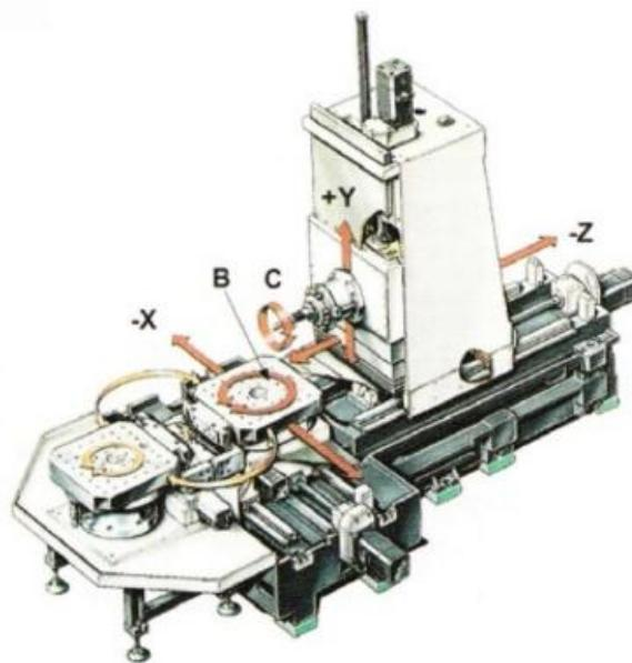
Slika 3. Primjer obradnog centra s izmjenjivačem [6]
