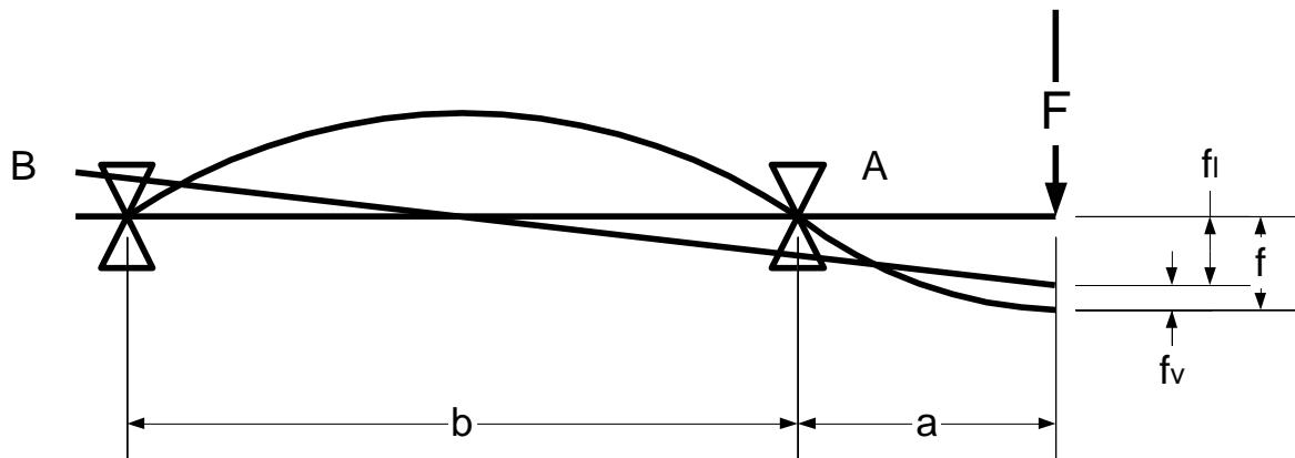
Slika 41. Pojednostavljeni prikaz progiba glavnog vretena [1]
