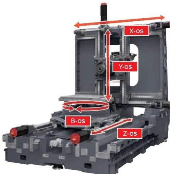
**Slika 10. Horizontalni glodaći obradni centar [12]**
