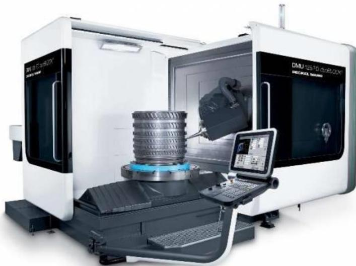
**Slika 14.** Petoosni glodači obradni centar DMG MORI 125P duoBLOCK [12]
