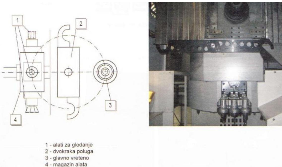
**Slika 9. Manipulator za automatsku izmjenu alata [6]**
