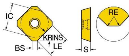
Slika 30. Rezna pločica R245-12 T3 M-PM 4230 [26]
