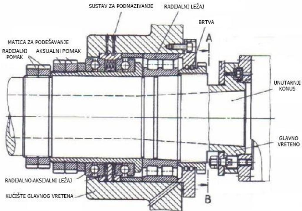
Slika 24. Presjek glavnog vretena, uležištenja i kućišta [20]
