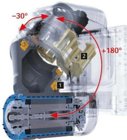
**Slika 17. Izvedba rotacijske osi glavnog vretena [12]**
