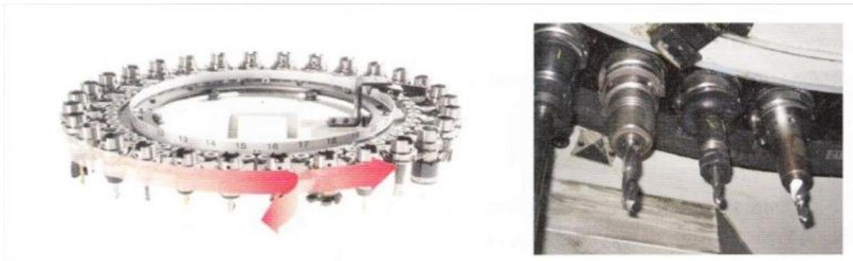
Slika 7. Disk spremište alata: a) skica, b) fotografija detalja [6]
