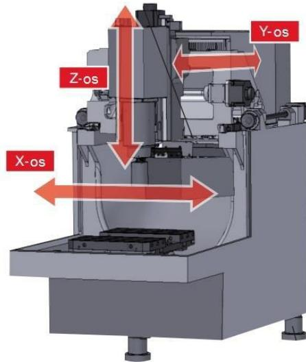
Slika 12. Vertikalni glodaći obradni centar [12]
