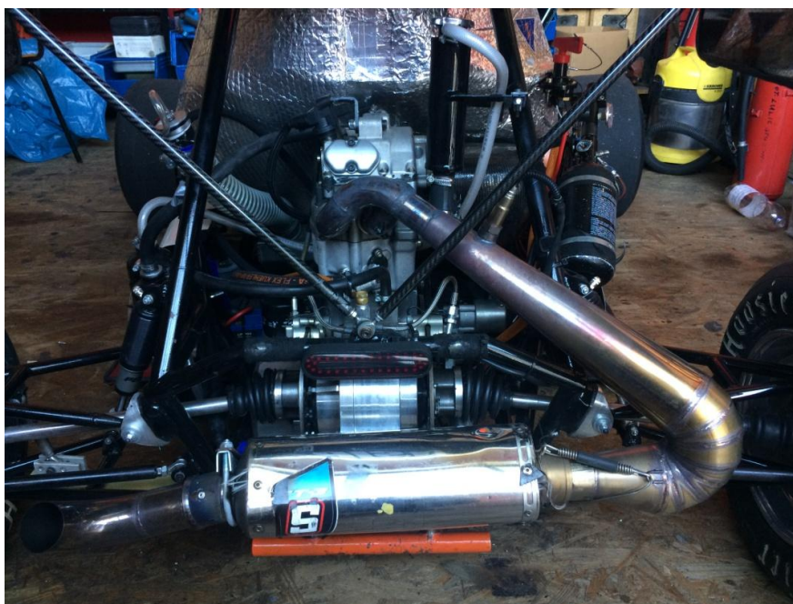
Slika 11. Bolid sa standardnim usisom i starim ispuhom
