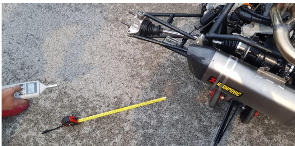
Slika 68. Postupak mjerenja razine buke s novim ispušnim sustavom
