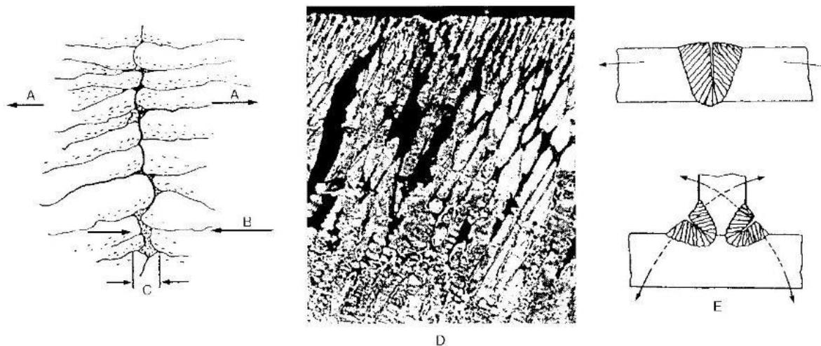
**Slika 24. Mehanizam nastajanja toplih pukotina [31]**
