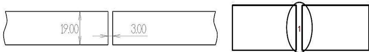
Slika 42. Priprema spoja i redoslijed prolaza za D-Arc postupak zavarivanja
