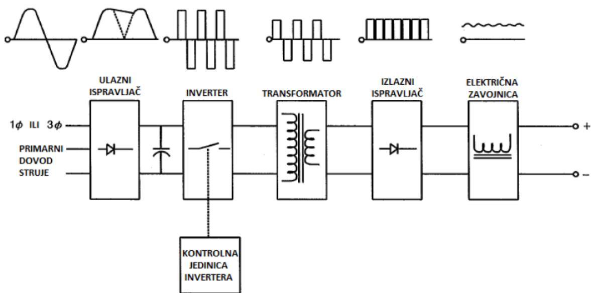
Slika 4. Blok dijagram inverterskog izvora struje za zavarivanje [12]
