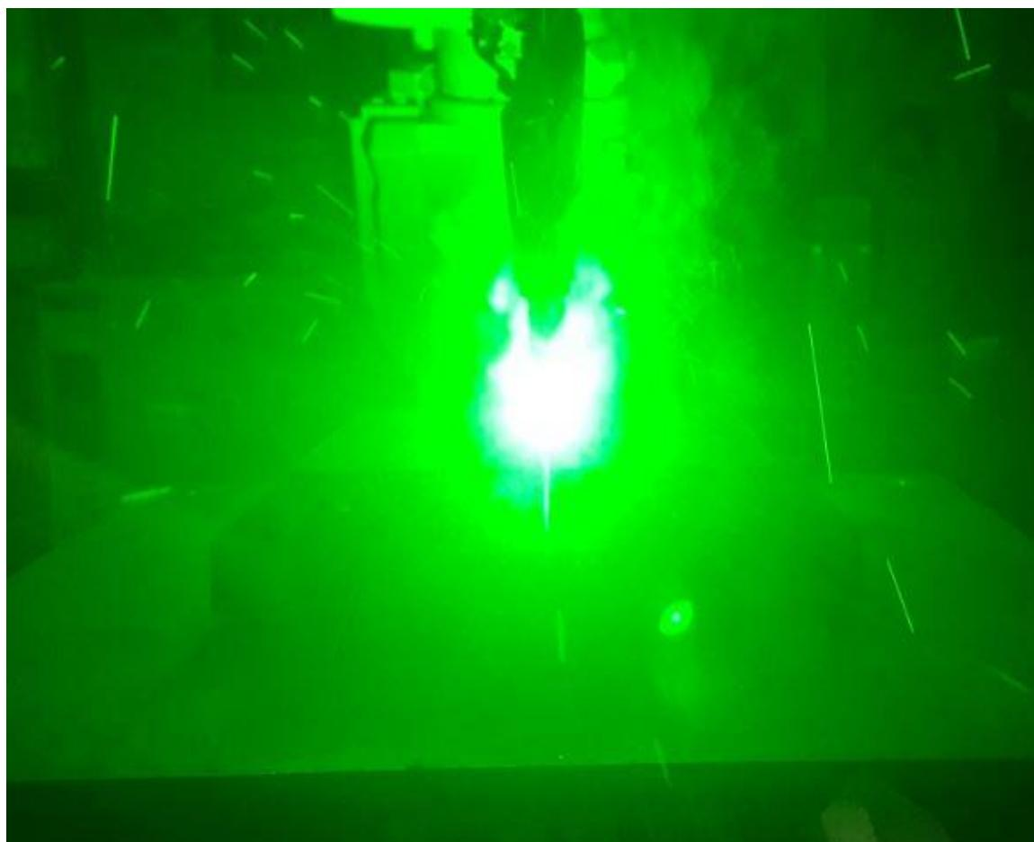
**Slika 45. Rasprskavanje tijekom D-Arc postupka zavarivanja**
