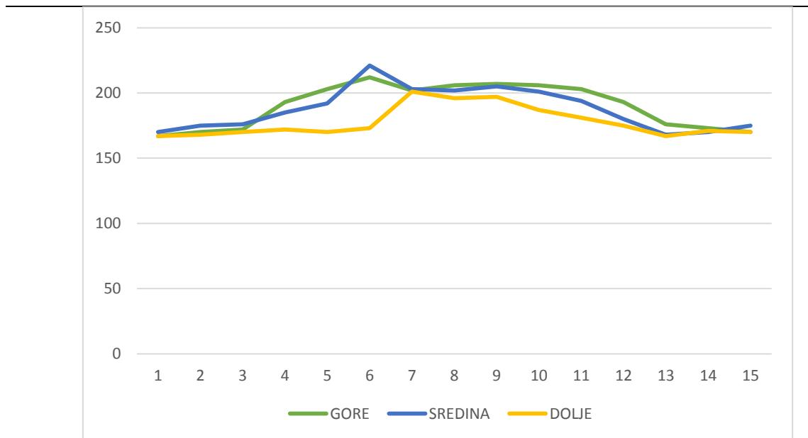
**Slika 66. Grafički prikaz tvrdoće uzorka 2 (D-Arc)**
