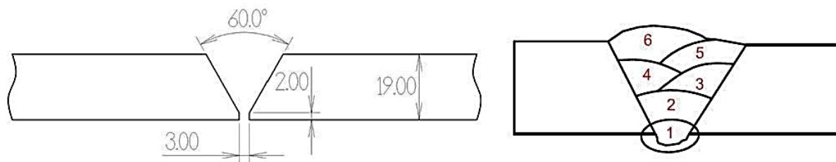
Slika 41. Priprema spoja i redoslijed prolaza za MAG postupak zavarivanja
