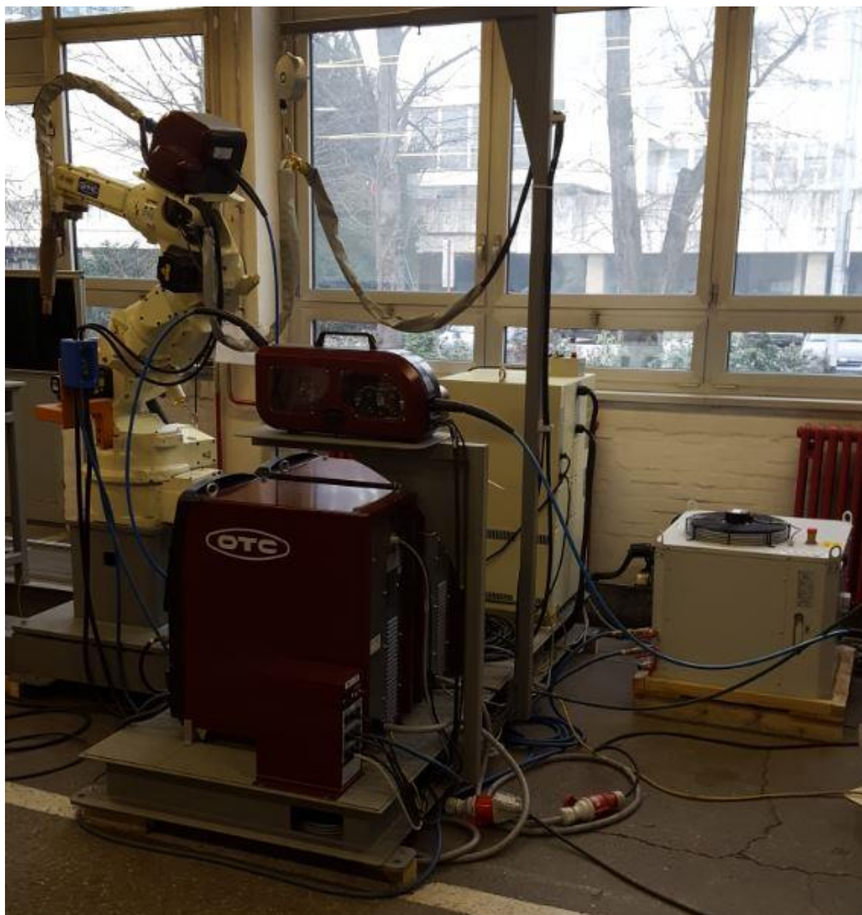
Slika 33. Robotska stanica za D-Arc postupak zavarivanja
