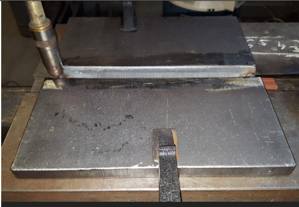
Slika 39. Pozicioniranje uzorka za MAG postupak zavarivanja
