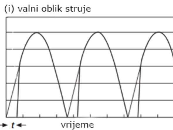
**Slika 8. Izlaz naponu i struje trofaznog fazno upravljivog tiristorskog ispravljača u mosnom spoju [23]**
