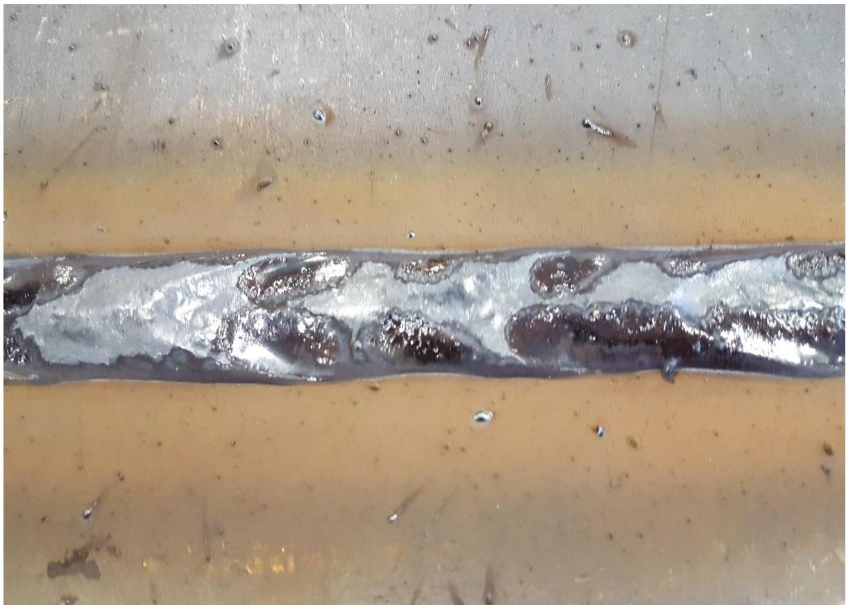
**Slika 46. Metalne kapljice uzrokovane rasprskavanjem tijekom zavarivanja**
