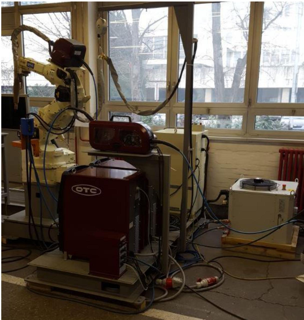
Slika 33. Robotska stanica za D-Arc postupak zavarivanja
