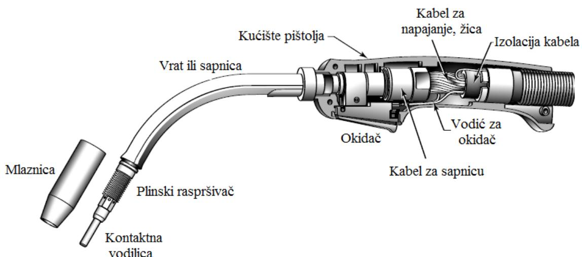
Slika 12. Komponente pištolja za zavarivanje sa zračnim hlađenjem [27]
