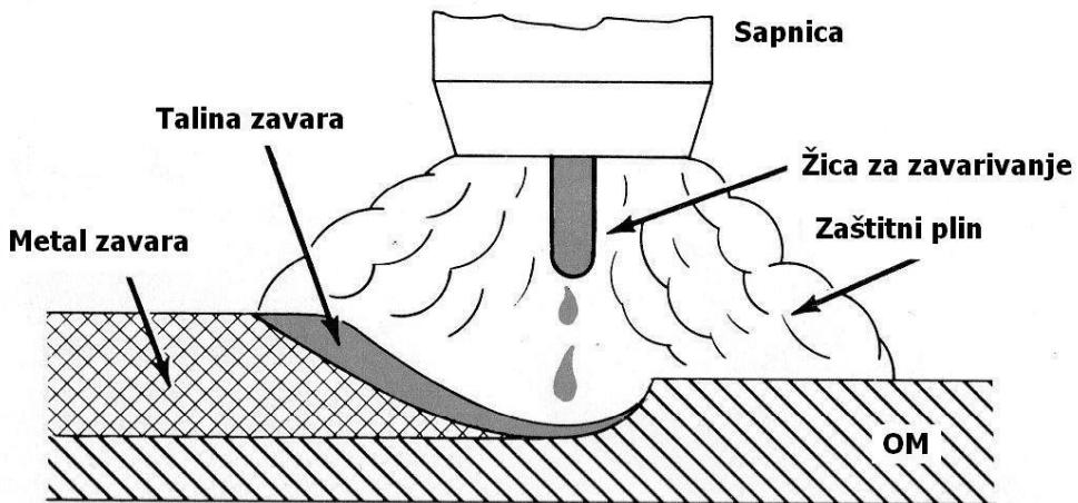
Slika 1. Shema prikaza MAG postupka zavarivanja [6]
