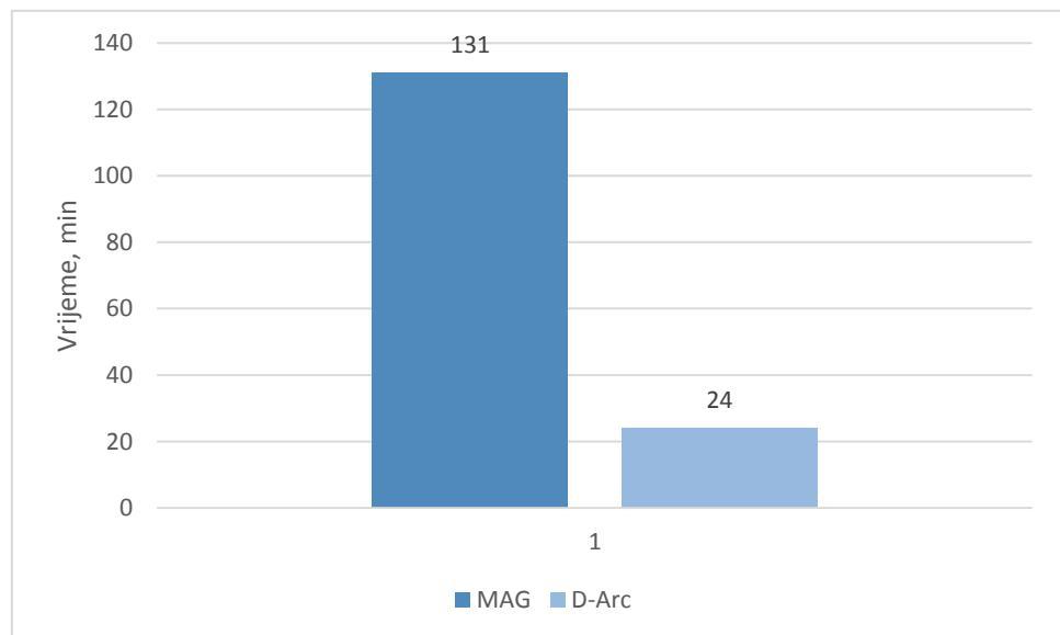
**Slika 64. Usporedba trajanja MAG i D-Arc postupaka zavarivanja**
