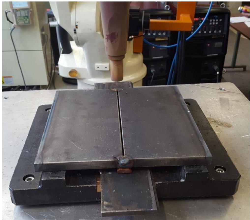
Slika 40. Pozicioniranje uzorka za D-Arc postupak zavarivanja
