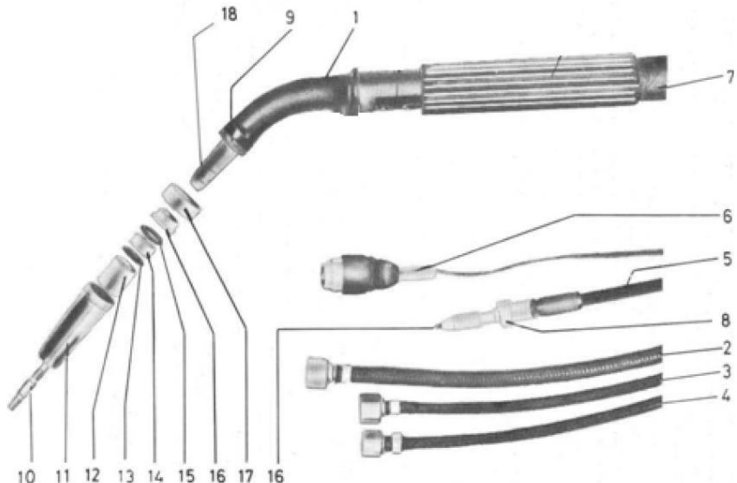
Slika 13. Komponente pištolja s vodenim hlađenjem [29]
