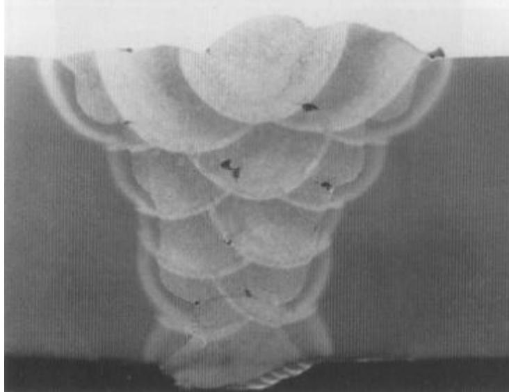
Slika 29. Uključci troske kod MAG postupka zavarivanja [31]
