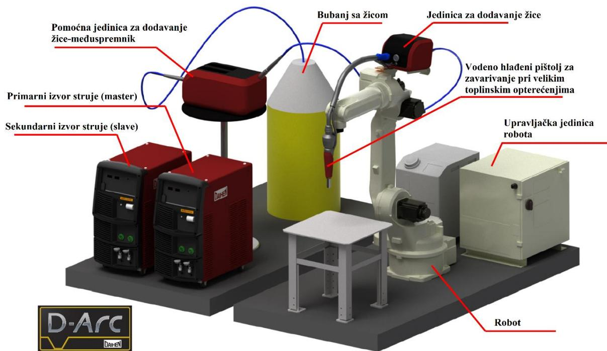
Slika 14. Konfiguracija visokoučinkovitog robotiziranog D-Arc sustava za zavarivanje [1]
