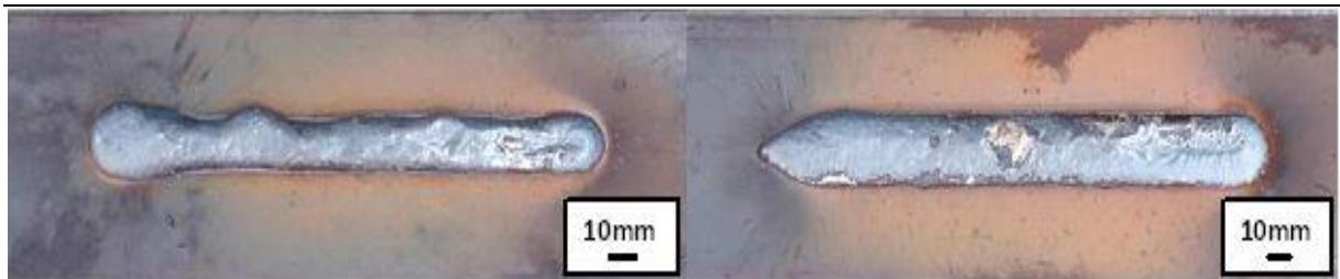
**Slika 23. Usporedba izgleda zavara: Konvencionalni zakopani luk (lijevo) i primjena niskofrekventno modulirane kontrole napona (desno) [1]**
