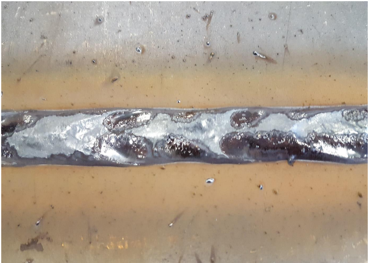
Slika 46. Metalne kapljice uzrokovane rasprskavanjem tijekom zavarivanja
