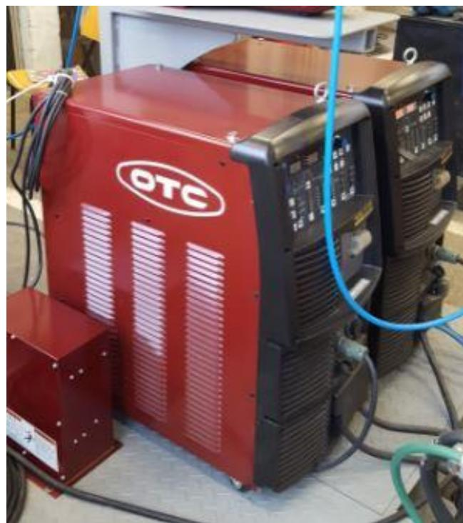
**Slika 34. Izvori struje za D-Arc postupak zavarivanja**
