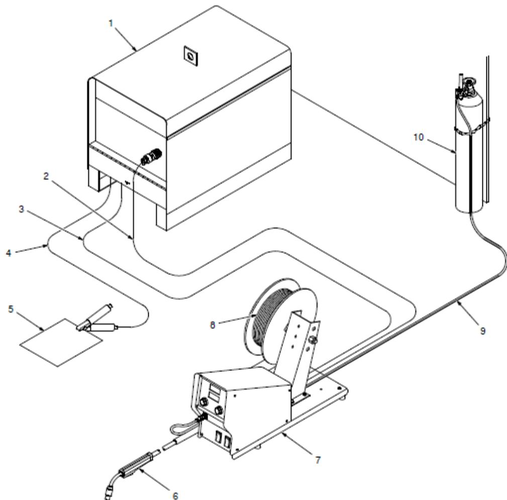
Slika 2. Shema sustava za MAG zavarivanje [11]
