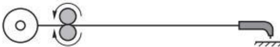
Slika 10. Dodavanje žice push sustavom [26]
