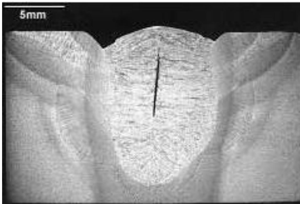
Slika 26. Topla pukotina ispod površine zavara [34]
