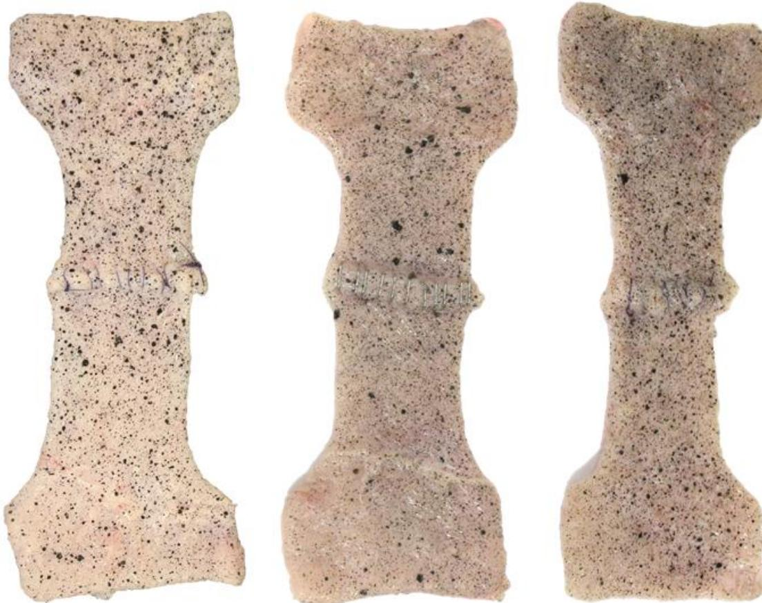
Slika 27 Uzorci pripremljeni za mjerjenje optičkim sustavom Aramis
