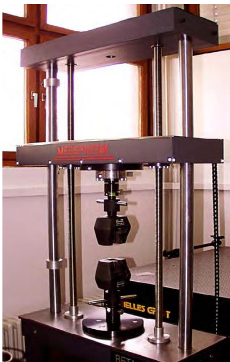
Slika 32 Statička kidalica Messphysik Beta 50-5
