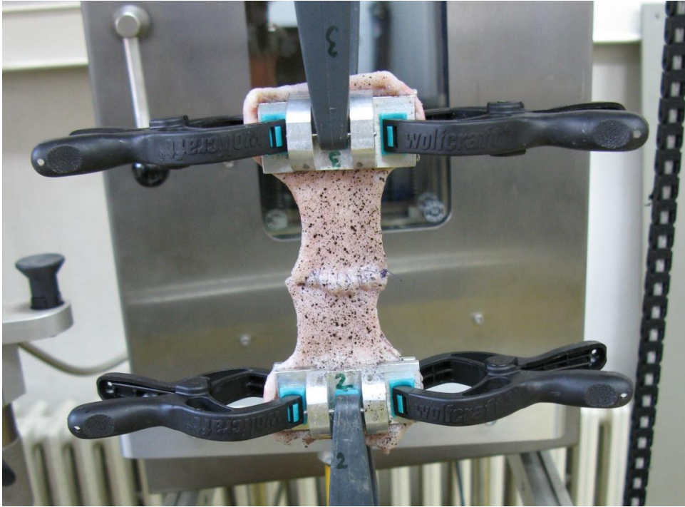
Slika 36 Uzorak učvršćen u prihvatu kidalice
