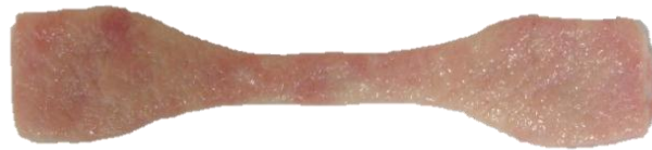
Slika 15 Uzorak za statičko vlačno ispitivanje
