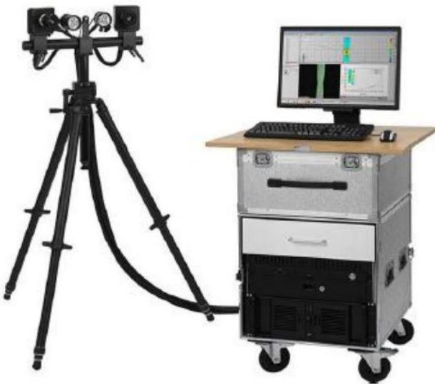
Slika 22 Optički mjerni sustav Aramis [21]
