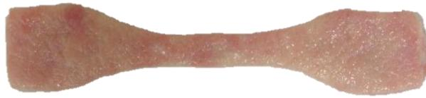
*Slika 15 Uzorak za statičko vlačno ispitivanje*
