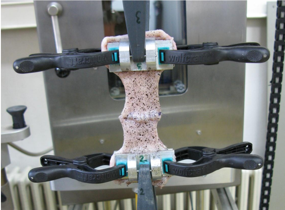
Slika 36 Uzorak učvršćen u prihvat u kidalice
