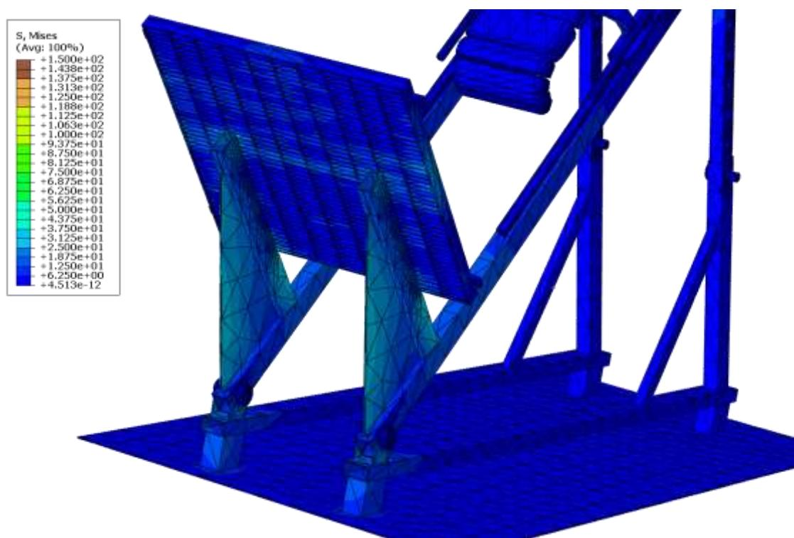
Slika 54. Prikaz naprezanja rebra i ploče
