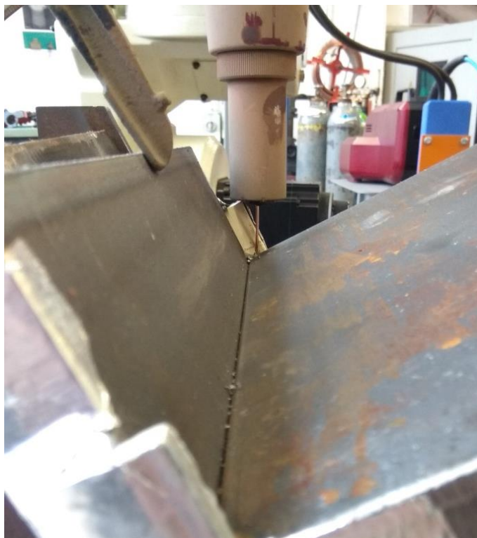
Slika 28. Pozicioniranje pištolja za zavarivanje u početnu točku
