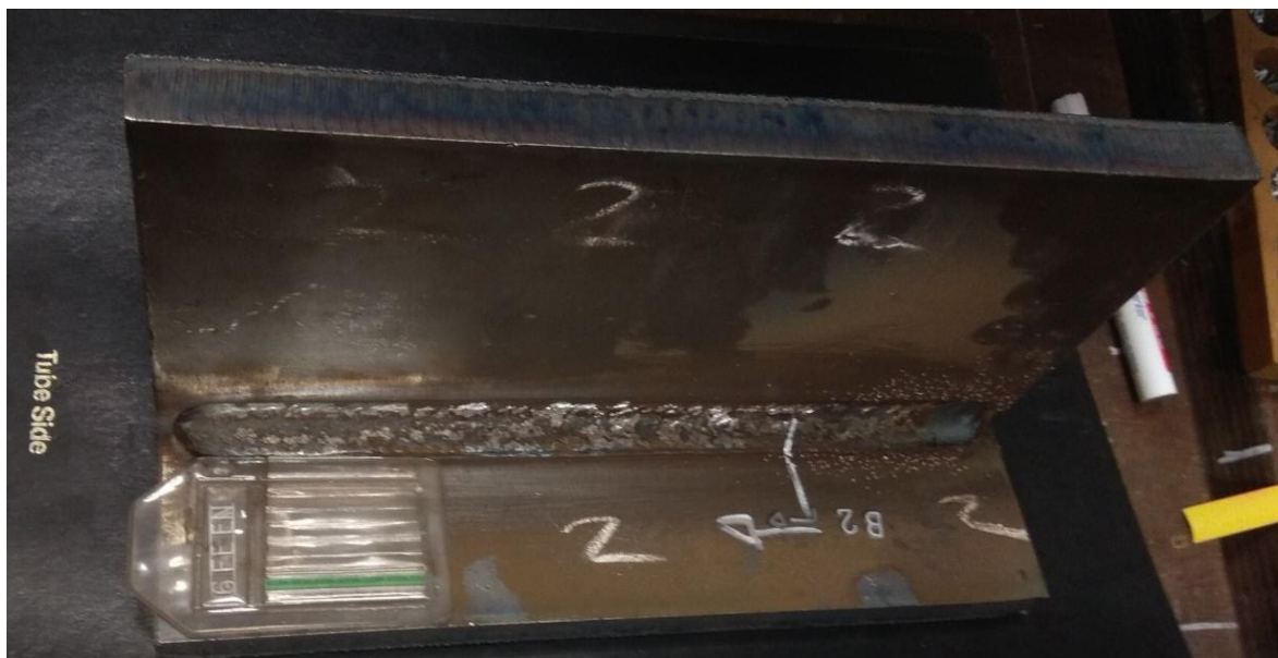
Slika 32. Uzorak prije radiografskog ispitivanja
