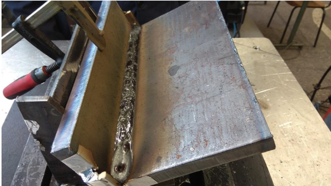
Slika 30. Prikaz zavara napravljen D-Arc postupkom
