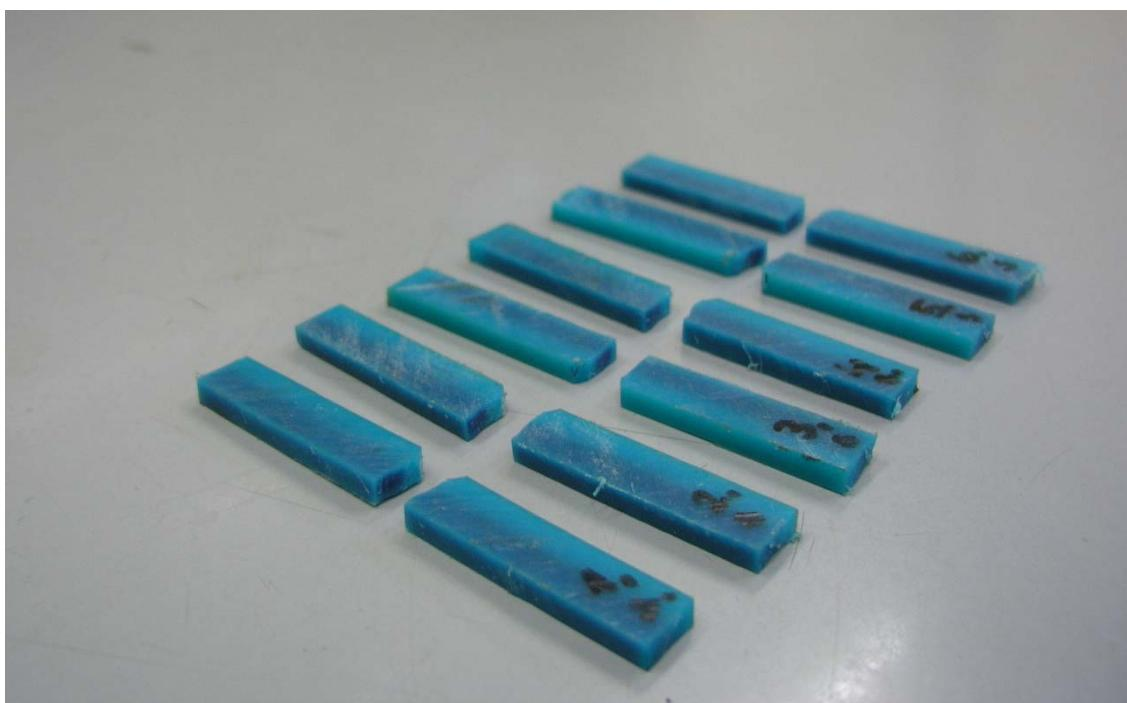
Slika 46. Epruvete netretiranog PA 6/12 G nakon ispitivanja udarnog rada loma
