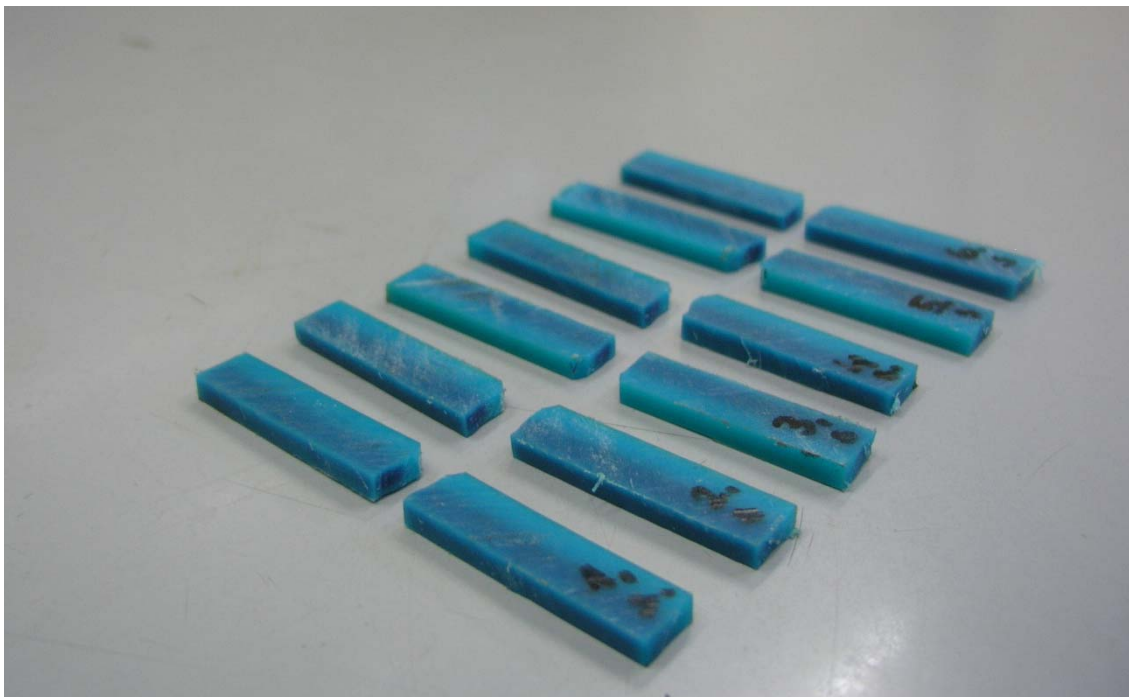
Slika 46. Epruvete netretiranog PA 6/12 G nakon ispitivanja udarnog rada loma
