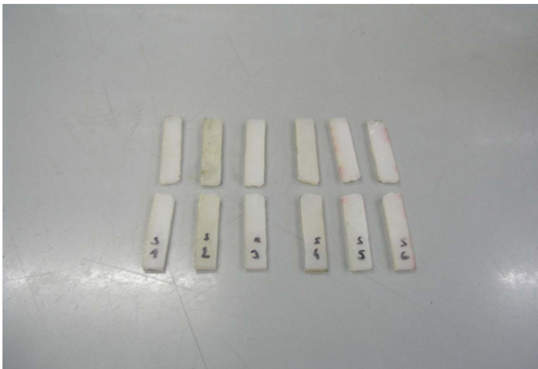
Slika 48. Epruvete netretiranog PA 6 nakon ispitivanja udarnog rada loma
