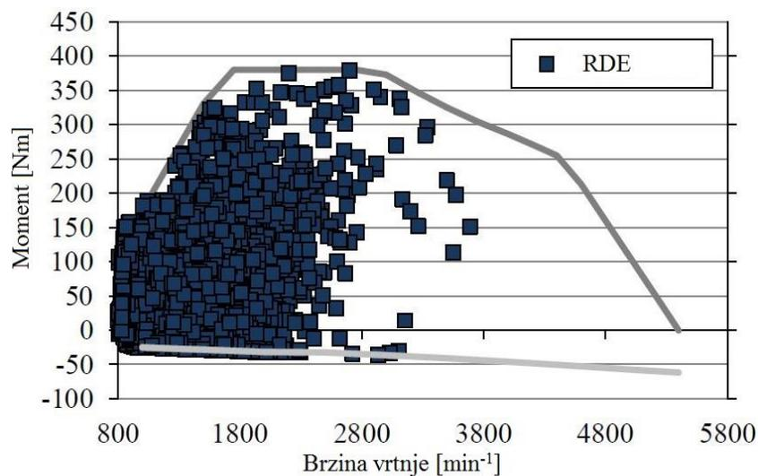
Slika 5. Područje rada motora kod RDE ispitnog postupka [5]
