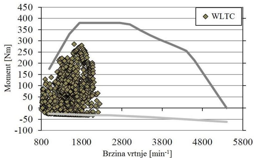
Slika 4. Područje rada motora kod WLTC ispitnog postupka [5]
