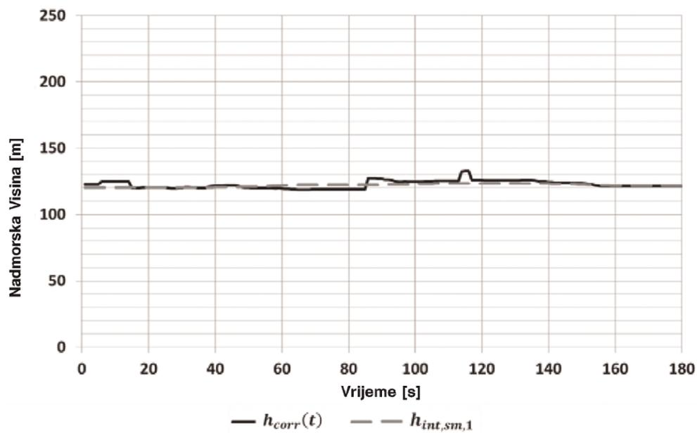
Slika 17. Izgladivanje interpoliranog profila nadmorske visine [9]
