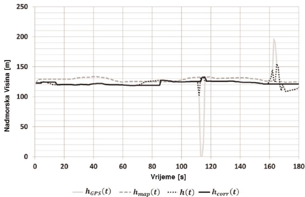
Slika 16. Usporedba korigiranog i interpoliranog profila nadmorske visine [9]
