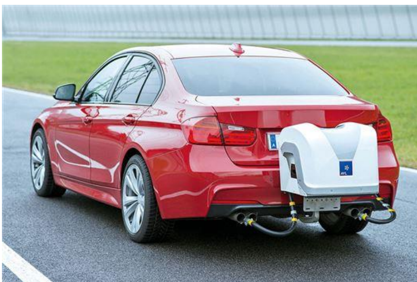
Slika 6. Vozilo s ugrađenim sustavom PEMS
