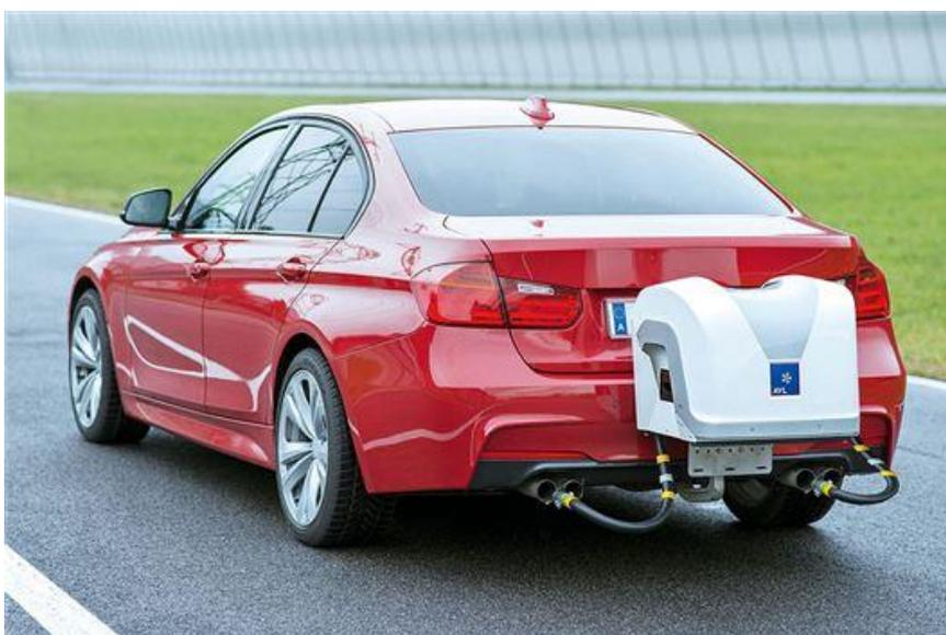
**Slika 6. Vozilo s ugrađenim sustavom PEMS**
