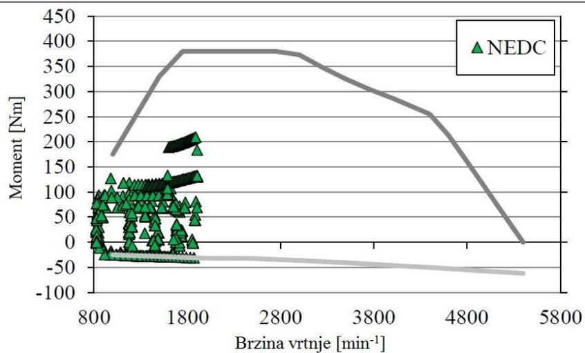
Slika 3. Područje rada motora kod NEDC ispitnog postupka [5]
