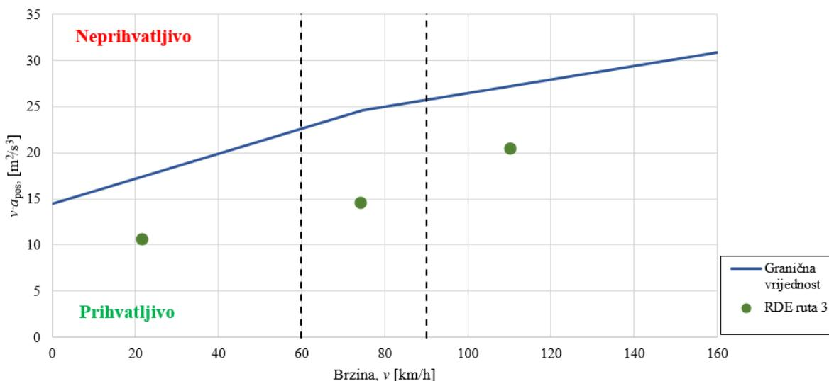
Slika 44. Dinamički uvjeti – 95. percentil umnoška brzine vozila i pozitivnog ubrzanja rute 3
