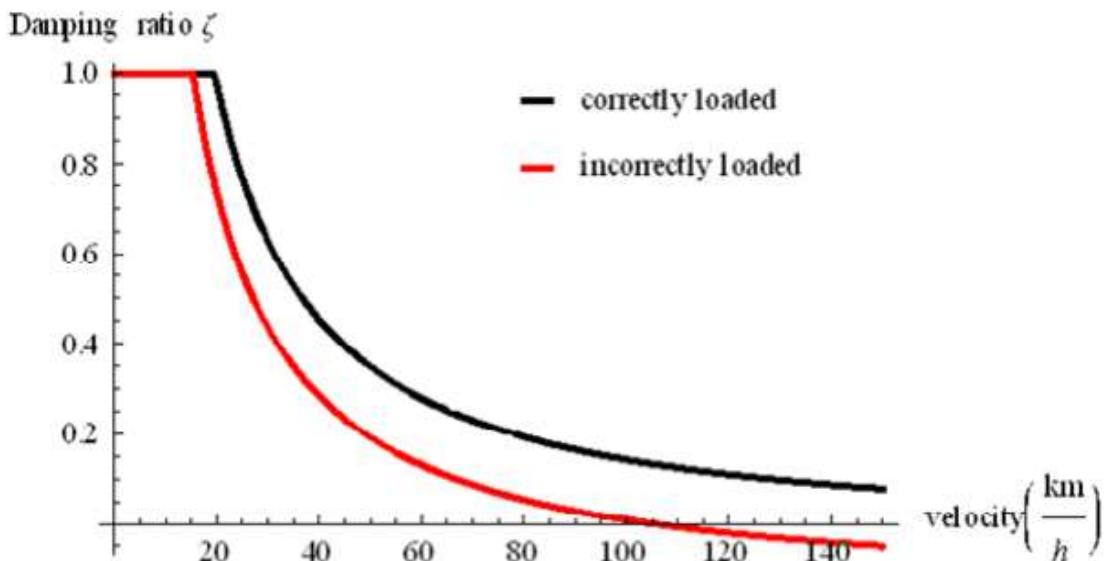
Slika 19. koeficijent prigušenja za pravilno i nepravilno opterećenu prikolicu [16]
