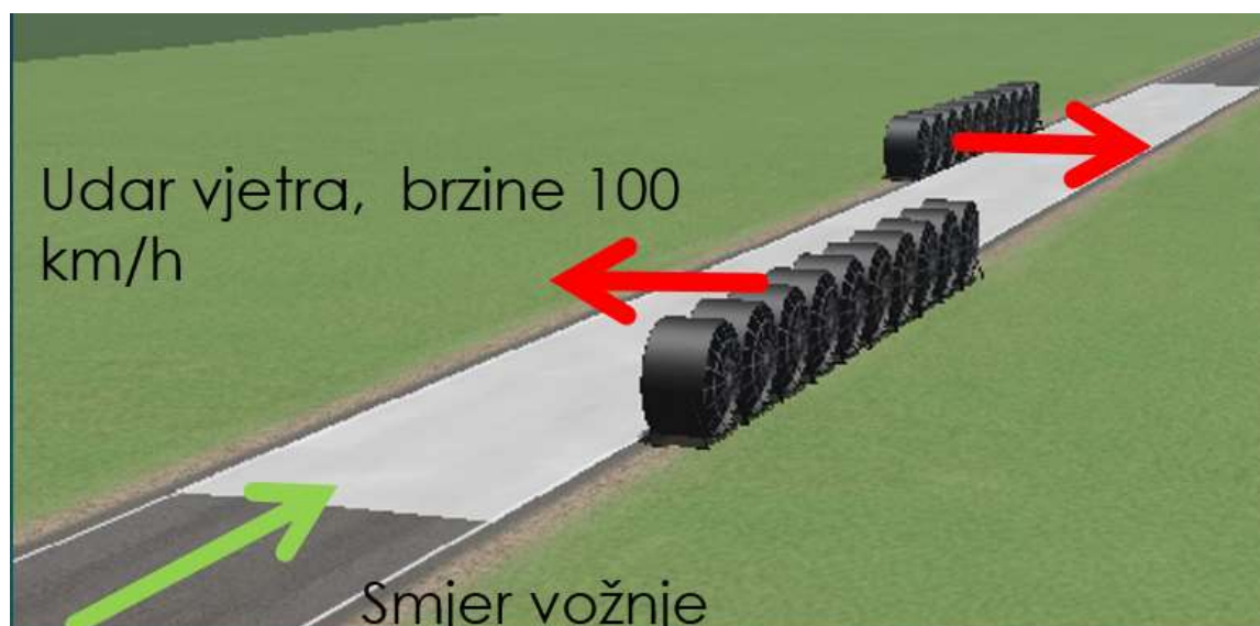
Slika 39. Prikaz ispitne procedure te parametara staze, CarSim
