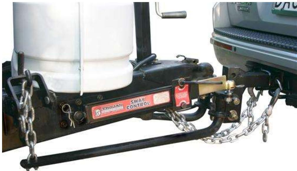
**Slika 26. Mehanizam za raspodjelu tereta na vučnoj kuki[23]**
