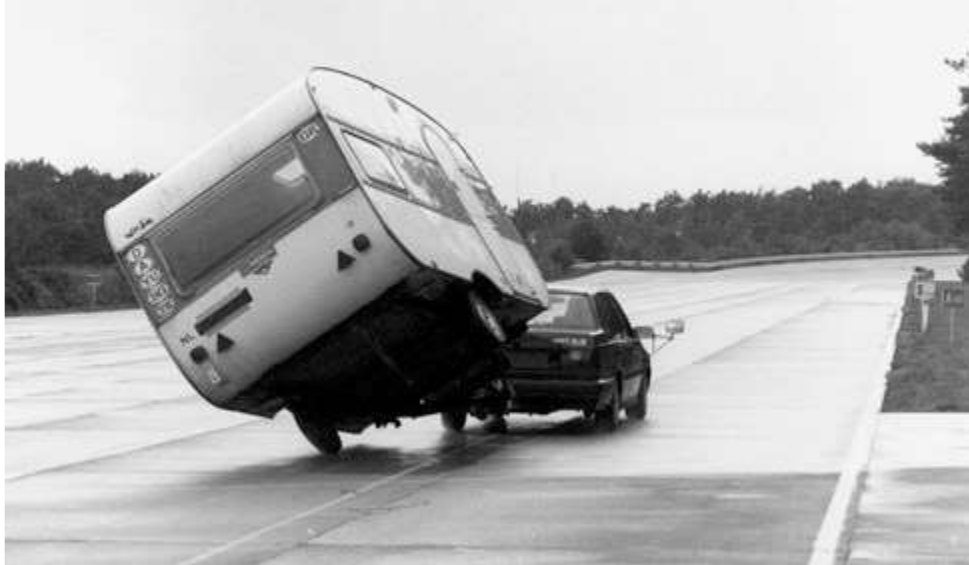
Slika 6. Gubitak stabilnosti uslijed bočne sile [5]
