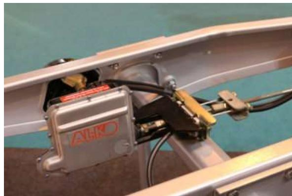
Slika 24. IDC elektro mehanički sustav prikolice [17]
