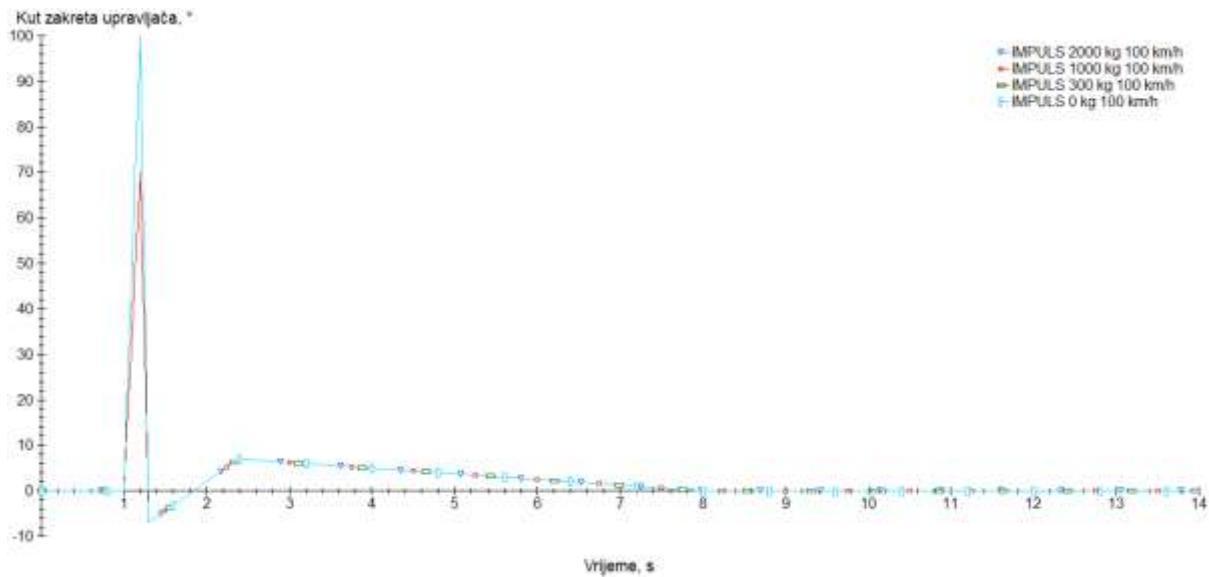
Slika 82. Zadani kut upravljača vučnog vozila, CarSim
