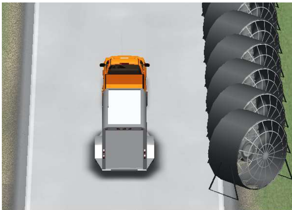
Slika 68. Poligon s generatorima vjetra pod kutem 45°, CarSim
