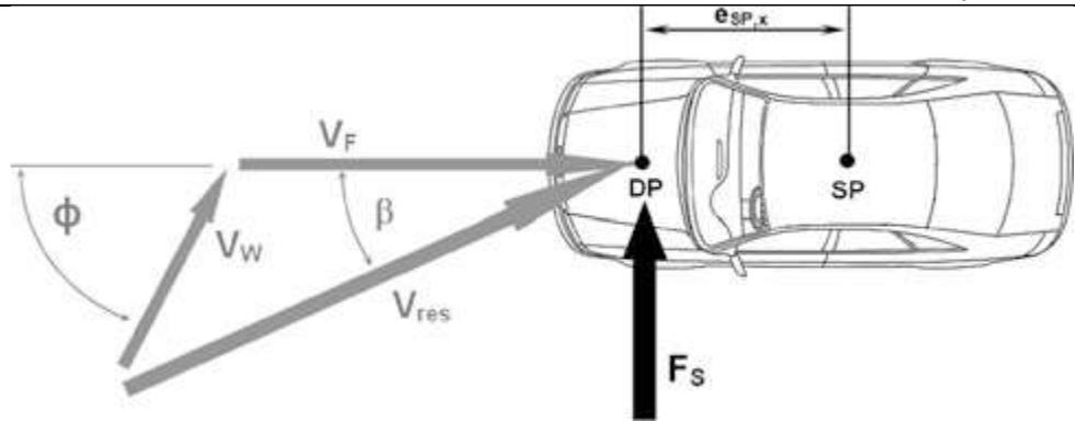
**Slika 2. Bočna sila, kut udara vjetra, kut bočnog klizanja vozila [5]**
