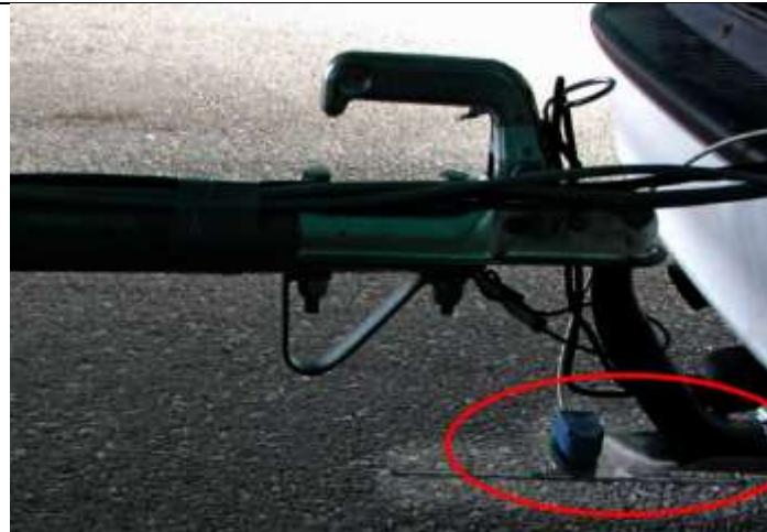
**Slika 20. Uredaj za mjerjenje kuta između vučnog vozila i prikolice [16]**
