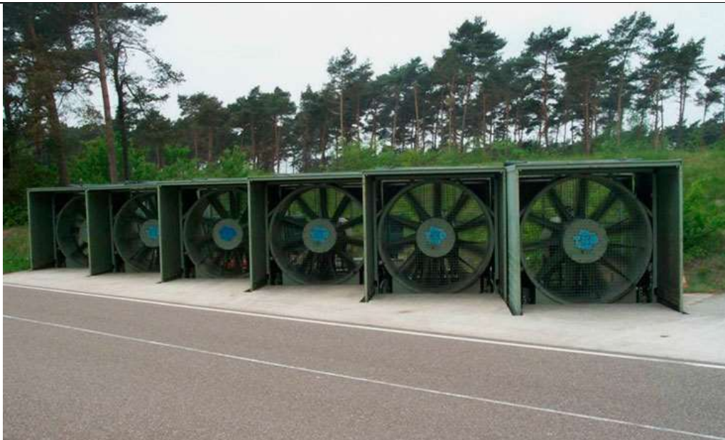
Slika 42. Stvarni generatori vjetra koji se koriste u realnim ispitivanjima vozila u ovoj ispitnoj proceduri [2]
