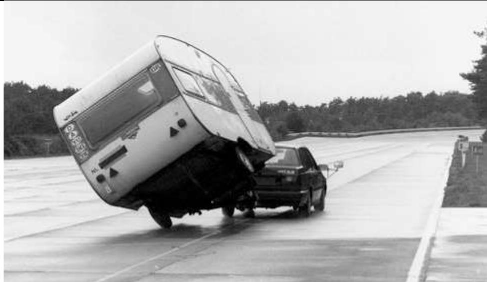
Slika 6. Gubitak stabilnosti uslijed bočne sile [5]
