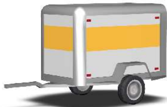
Slika 34. Prikolica sa zatvorenim tovarnim prostorom, CarSim
