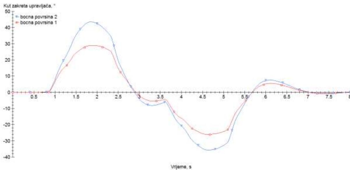
**Slika 59. Utjecaj bočne površine prikolice na kut zakreta upravljača prilikom bočnog udara vjetra, CarSim**
