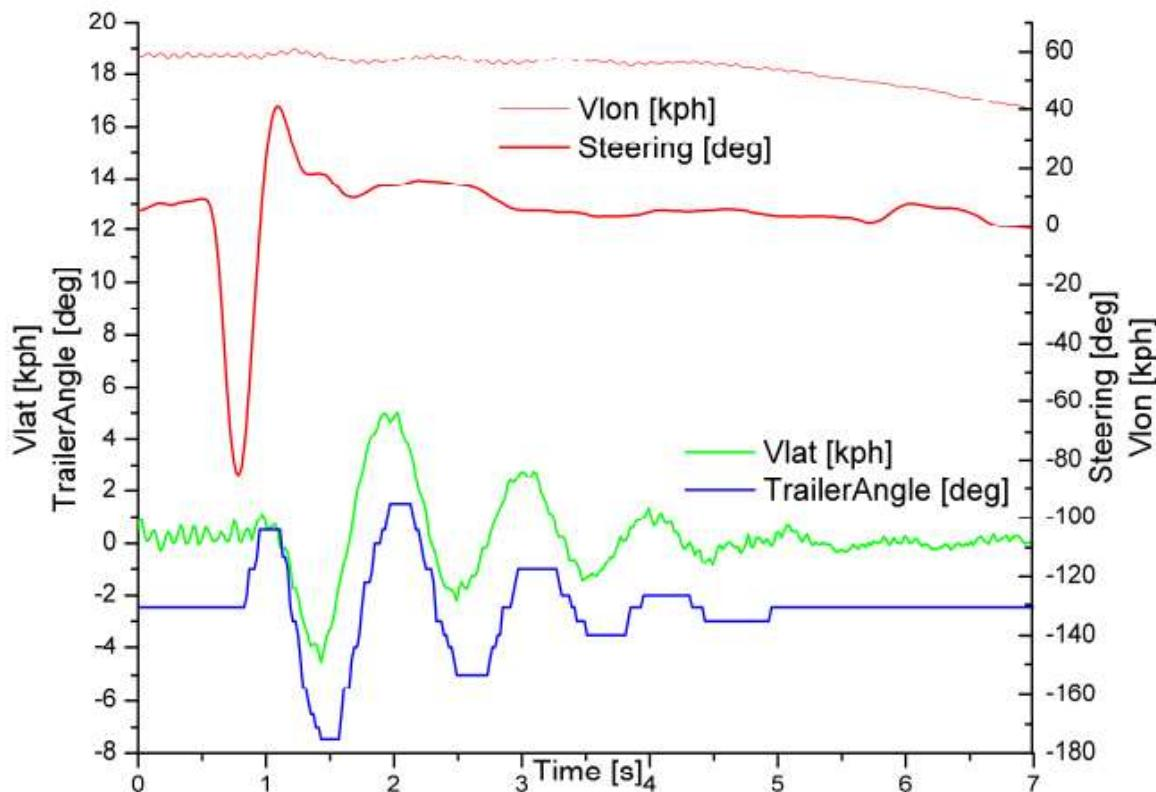
**Slika 21. Rezultati mjerena (uzdužna brzina , bočna brzina, kut zakreta upravljača , kut između vozila i prikloce) [16]**
