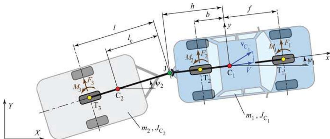
Slika 17. Model vozila s prikolicom plus pojednostavljeni model [6]
