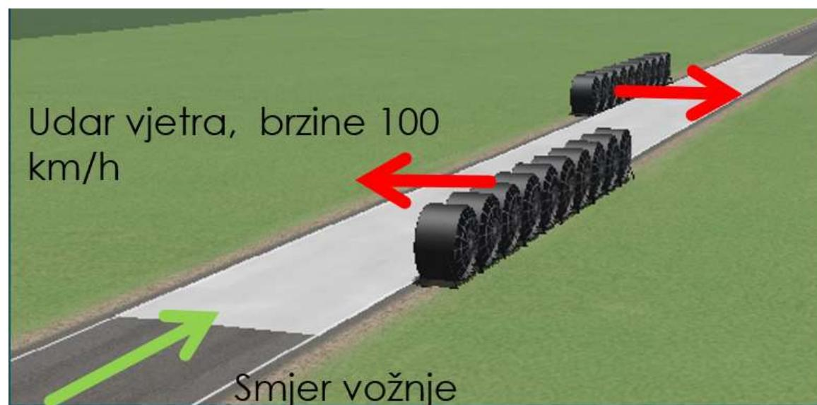
Slika 39. Prikaz ispitne procedure te parametara staze, CarSim
