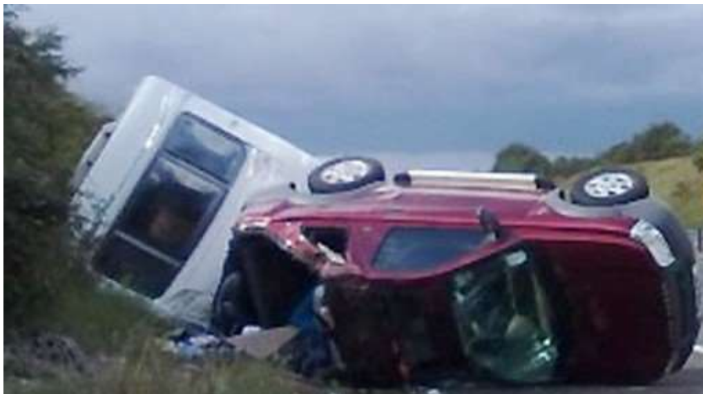
Slika 7. Prevrtnanje vozila uslijed gubitka stabilnosti [27]
