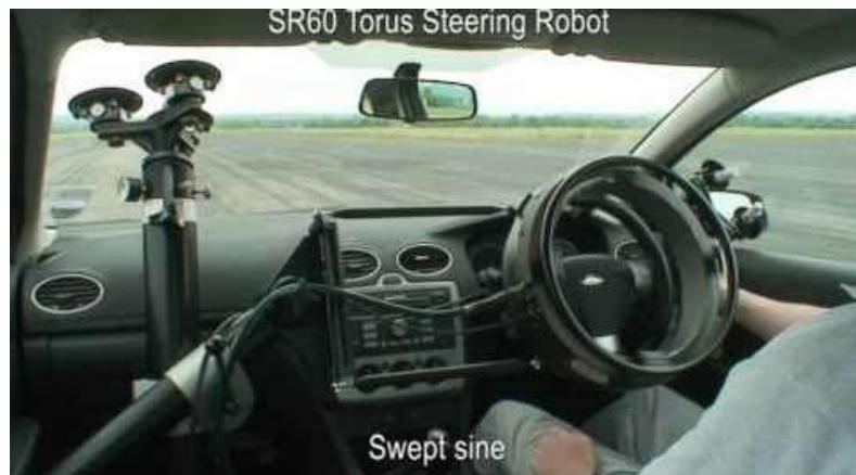
Slika 4. Ispitivanje u otvorenoj petlji [8]
