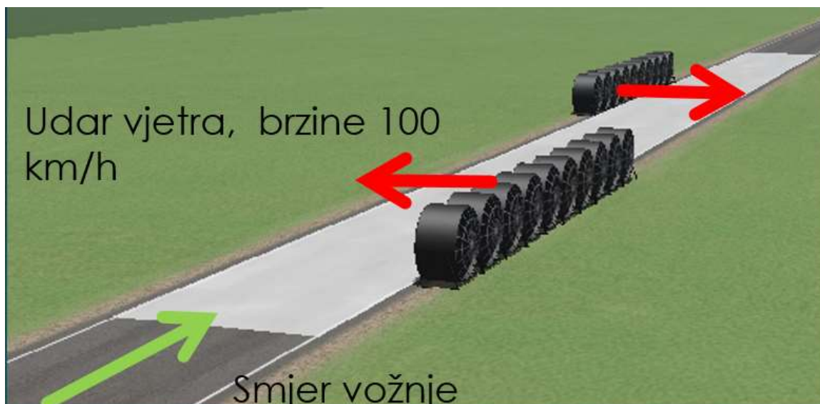
Slika 39. Prikaz ispitne procedure te parametara staze, CarSim
