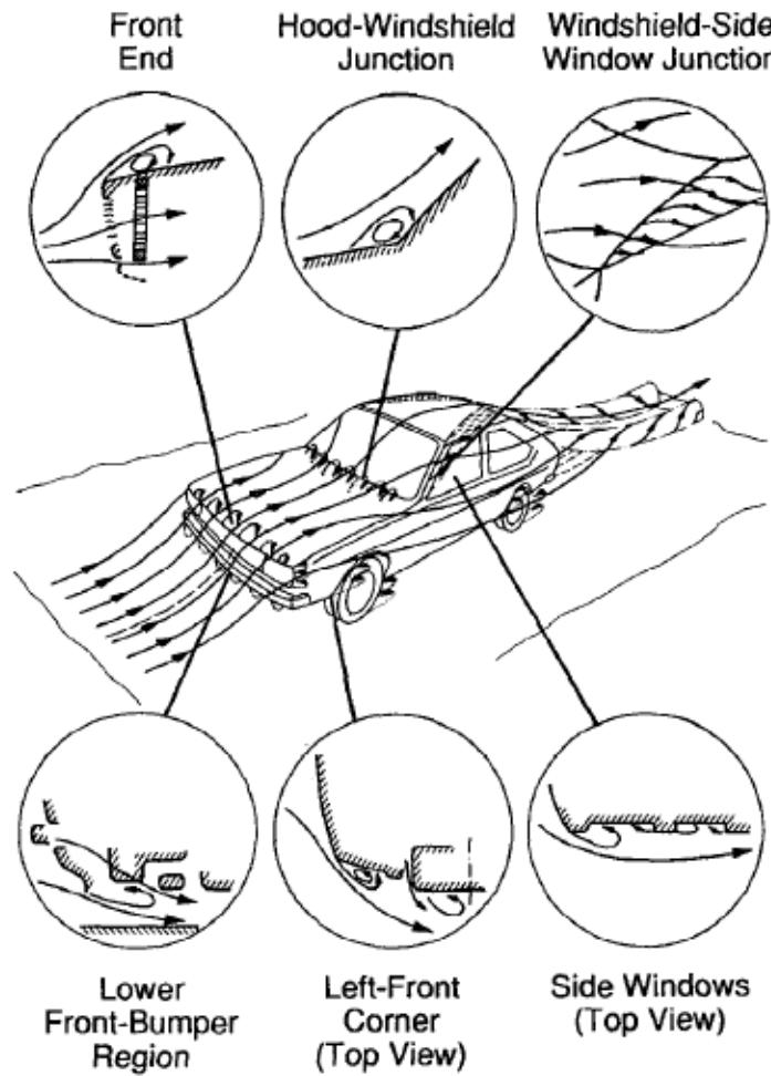
**Slika 12. Dijelovi vozila koji utječu na turbulentno strujanje zraka oko vozila [1]**
