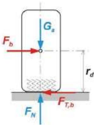
Slika 8. Bočne sile na kotaču [2]
