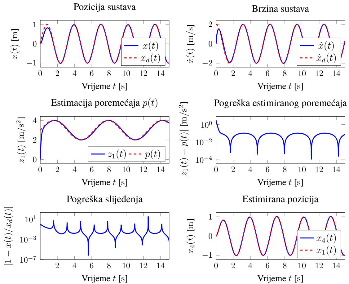
**Slika 5.1:** Estimacija vanjskog poremećaja korištenjem estimatora prvog reda bez šuma mjerjenja
