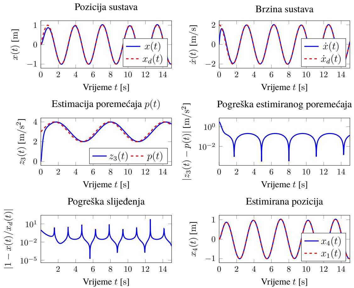
**Slika 5.2:** Estimacija vanjskog poremećaja korištenjem estimatora drugog reda bez šuma mjerjenja
