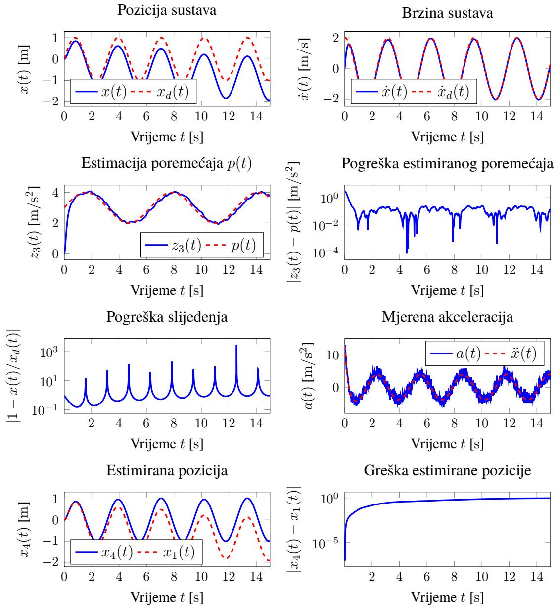
**Slika 5.5:** Estimacija vanjskog poremećaja korištenjem estimatora drugog reda sa šumom mjerjenja
