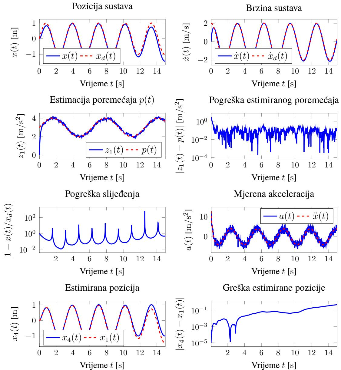
**Slika 5.4:** Estimacija vanjskog poremećaja korištenjem estimatora prvog reda sa šumom mjerjenja
