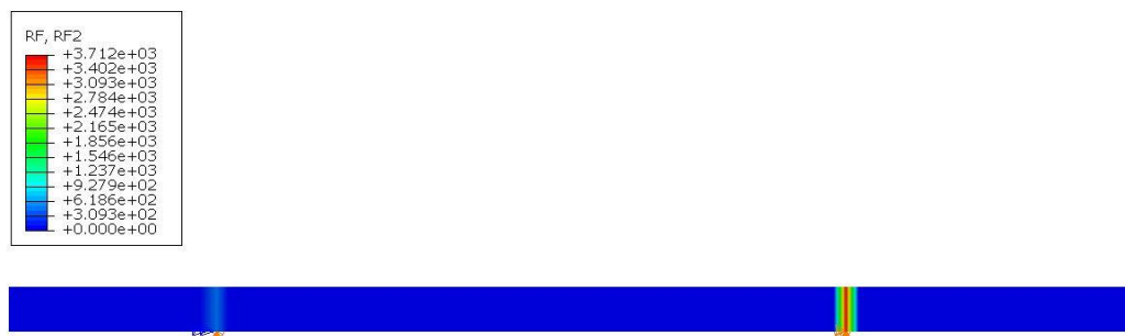
Slika 8.29 Prikaz sila reakcija u osloncima
