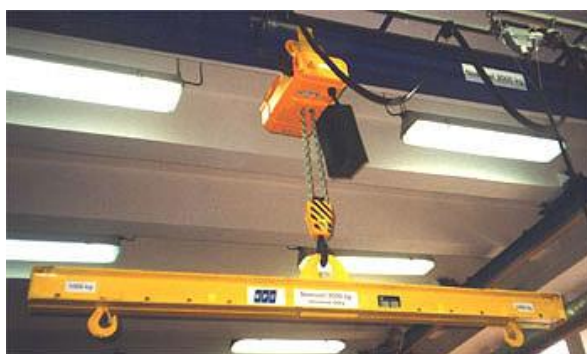
Slika 5.10 Viseći granik s traverzom
