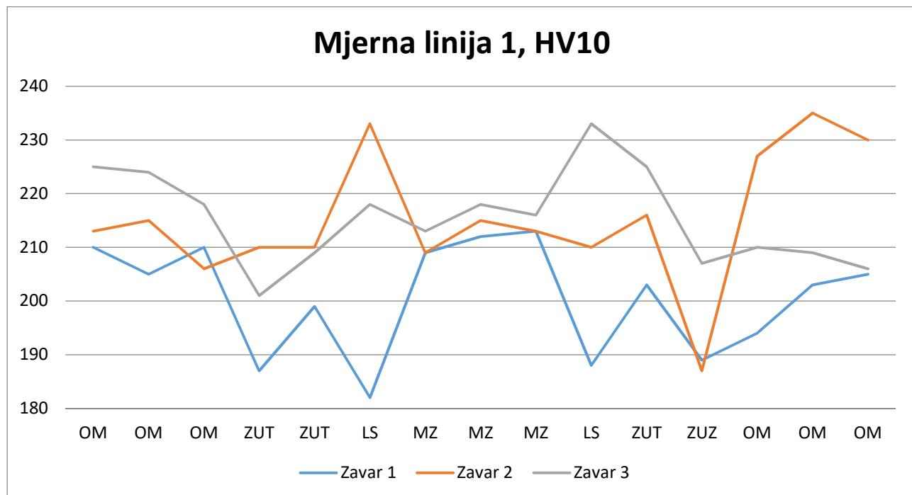
Slika 33. Usporedni prikaz tvrdoća na mjernoj liniji 1
