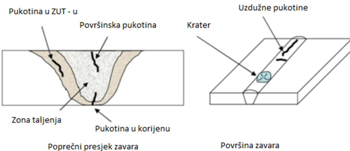
Slika 7. Tople pukotine u zavarenom spoju [19]
