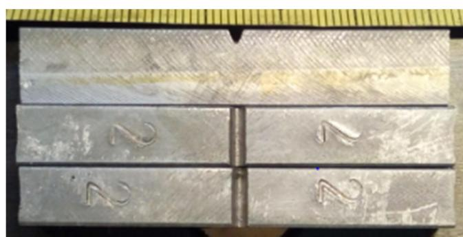
Slika 24. Charpy epruvete
