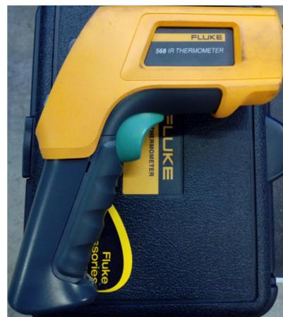
Slika 10. Fluke S68 uređaj za mjerjenje međuprolazne temperature
