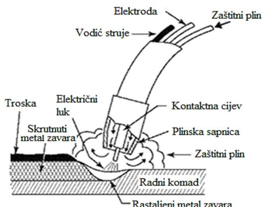
Slika 3. Shematski prikaz FCAW – G postupka [3]
