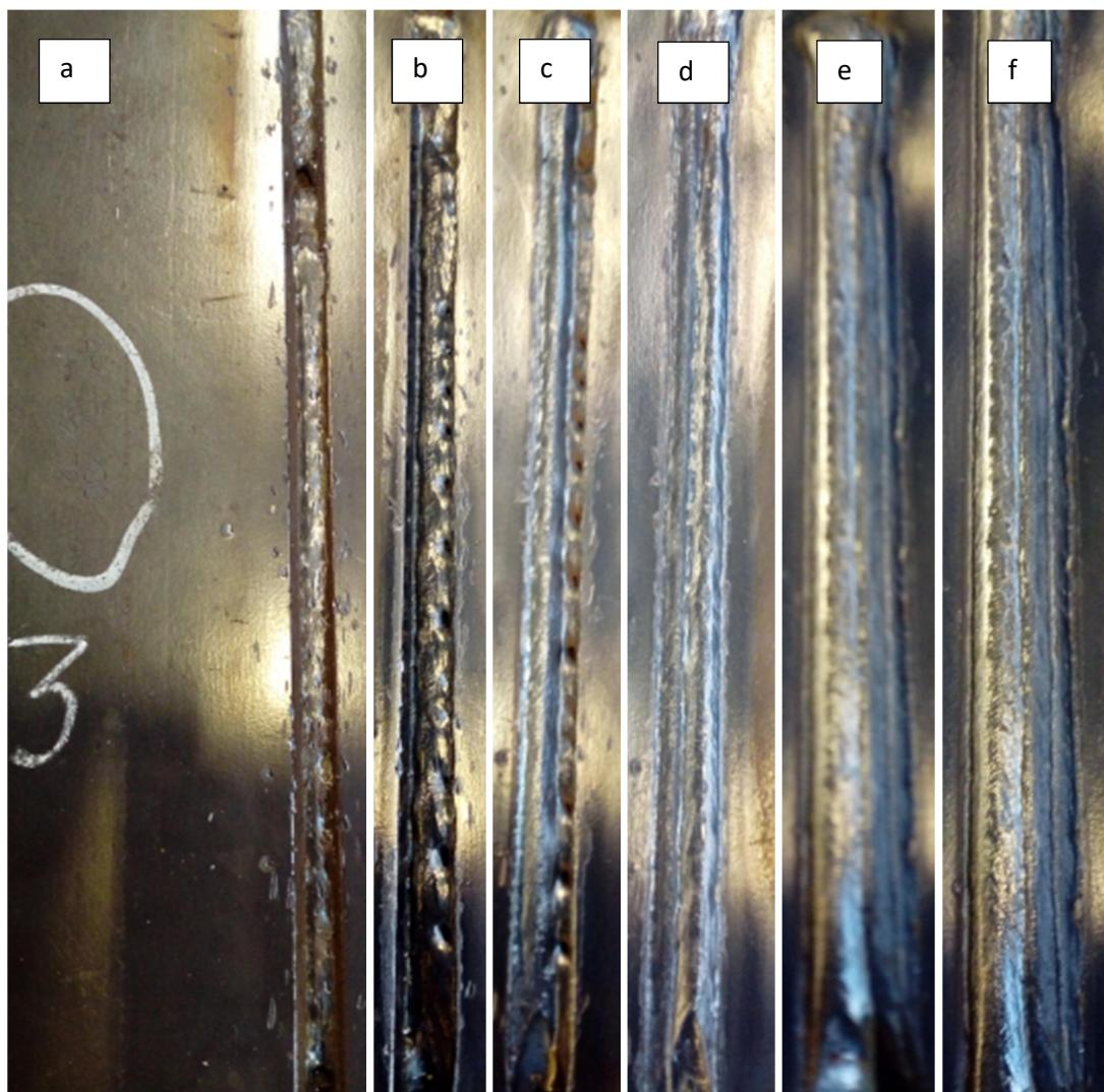
Slika 15. Zavari izvedeni brzinom 50 cm/min, a) korijen, b) drugi prolaz, c) treći prolaz,
