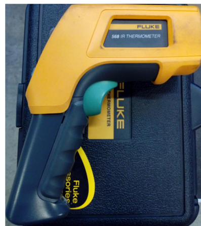
Slika 10. Fluke S68 uređaj za mjerenje međuprolazne temperature
