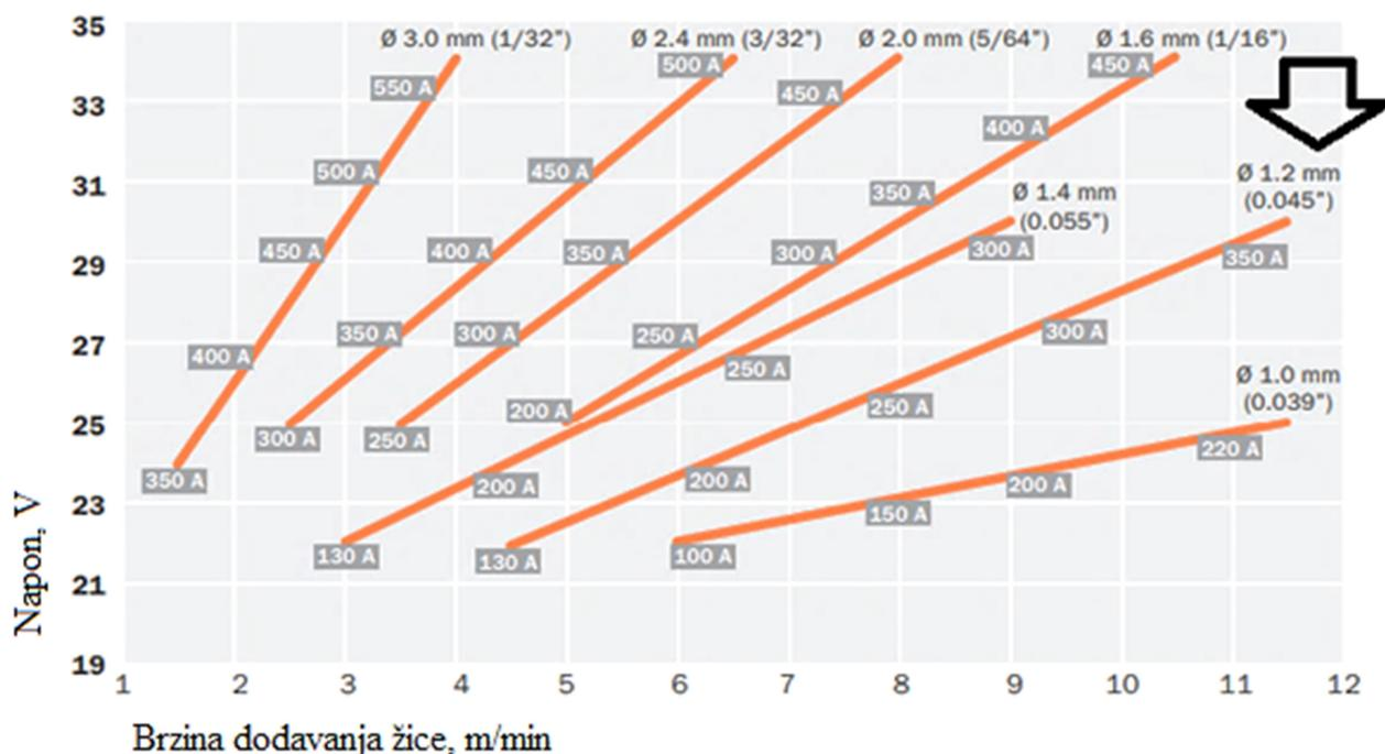
Slika 12. Parametri zavarivanja MEGAFIL punjenim žicama [31]
