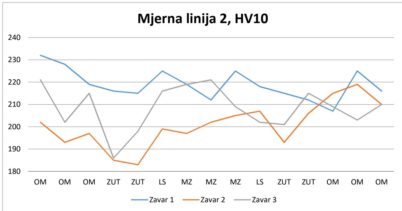
Slika 34. Usporedni prikaz tvrdoća na mjernoj liniji 2
