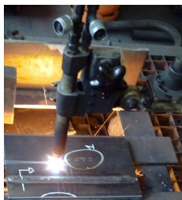
**Slika 21. Rezanje ploča plinskim plamenom**
