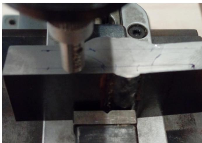
Slika 29. Mjerenje tvrdoće
