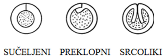
Slika 6. Oblici spojeva praškom punjenih žica [12]
