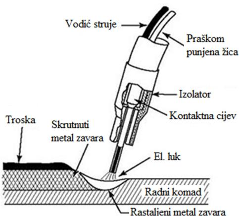
Slika 2. Shematski prikaz FCAW – S postupka [3]
