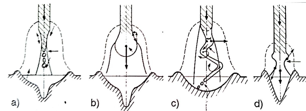
**Slika 1. Shematski prikaz načina prijenosa rastaljenog metala u električnom luku: a) prijenos štrcajućim lukom, b) prijenos u obliku kapljica, c) prijenos rotirajućim lukom, d) prijenos kratkim spojevima [4]**
