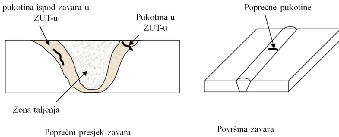
**Slika 8. Hladne pukotine u zavarenom spoju [19]**
