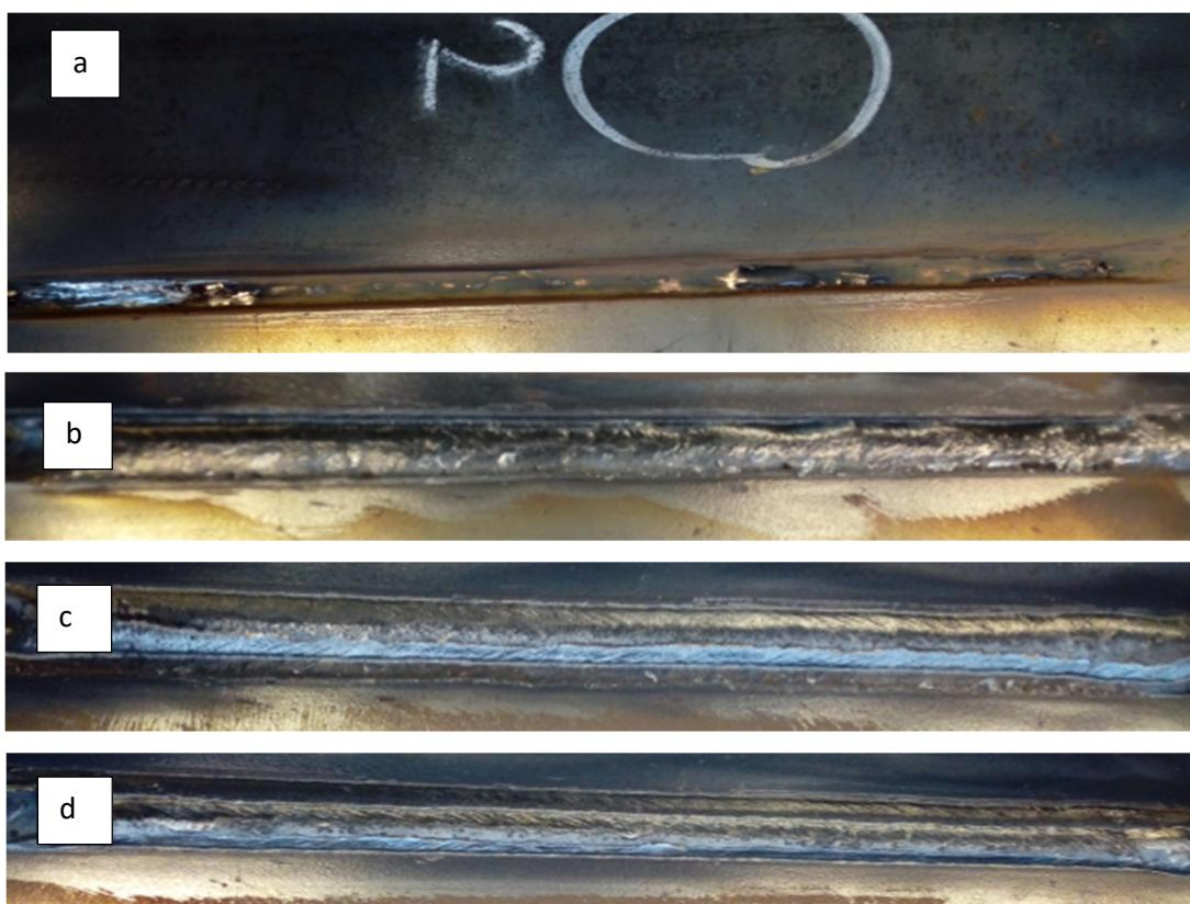
**Slika 14. Zvari izvedeni brzinom 35 cm/min, a) korijen, b) drugi prolaz, c) treći prolaz, d) četvrti prolaz**
