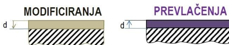
Slika 3 Osnovna podjela postupaka inženjerstva površina [8]
