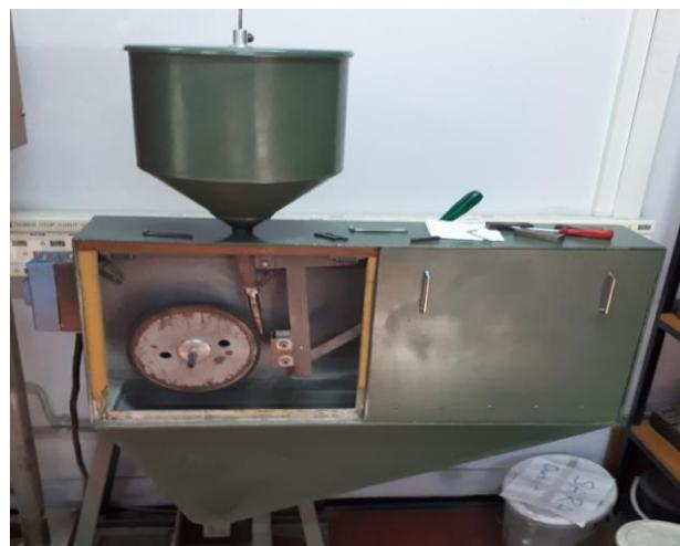
Slika 25 uredaj za ispitivanje otpornosti na abrazijsko trošenje
