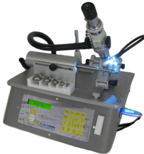
Slika 31 Uredaj za ispitivanje debljine prevlake [26]
