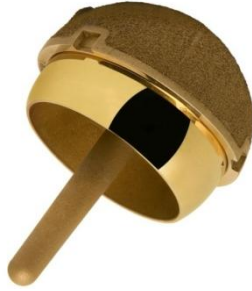
Slika 9. Zglob implantata za kuk prevučen TiN prevlakom [32]
