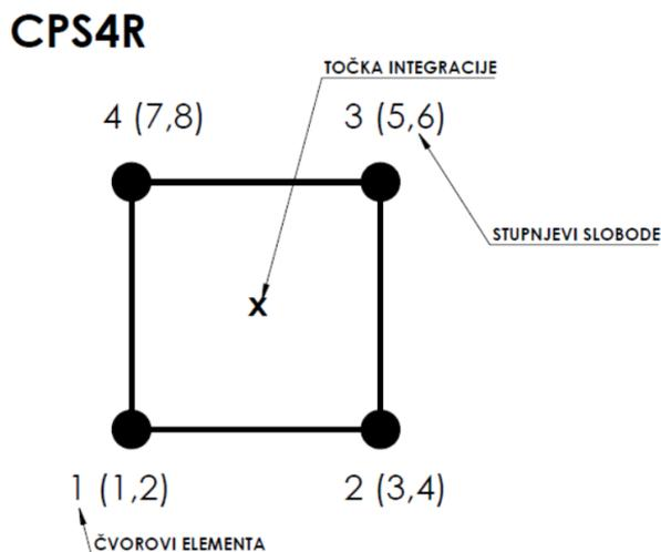
Slika 25. Korišteni CPS4R konačni element
