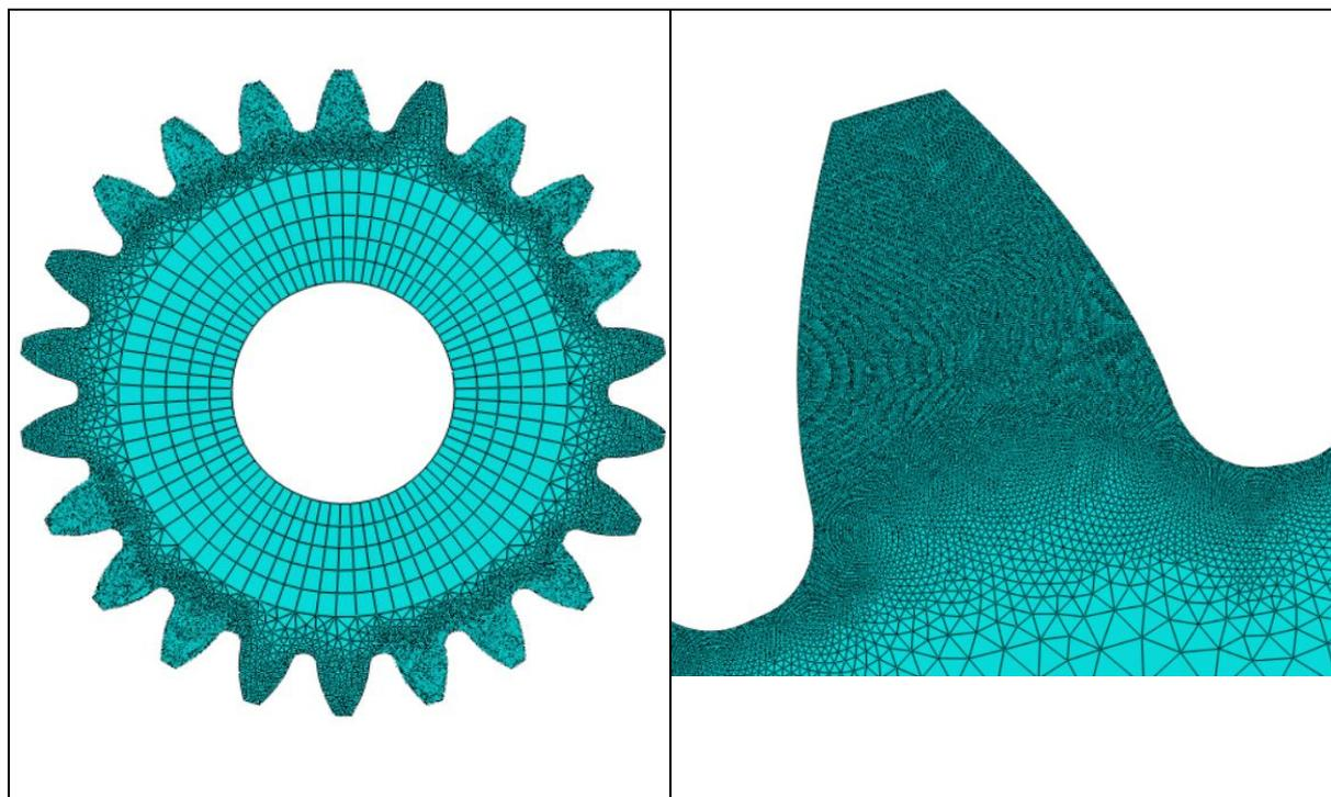
Slika 26. Mreža centralnog zupčanika s vanjskim ozubljenjem
