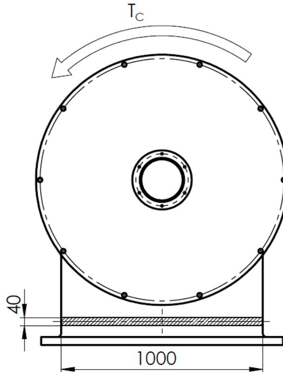
Slika 37. Shematski model za proračun nosača kućišta
