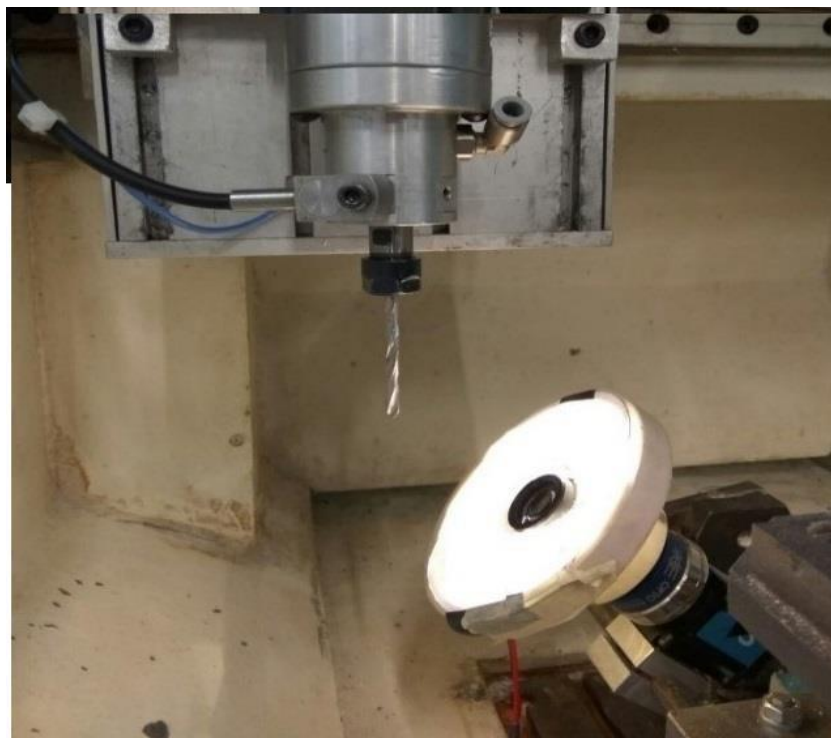
Slika 4.13 Industrijska kamera i svrdlo u poziciji za slikanje oštrice
