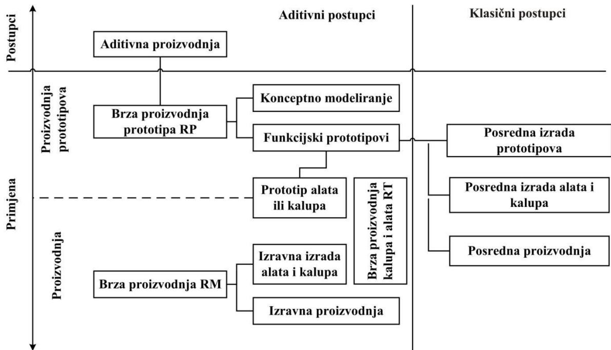
Slika 5. Mogućnost primjene aditivne proizvodnje [5]
