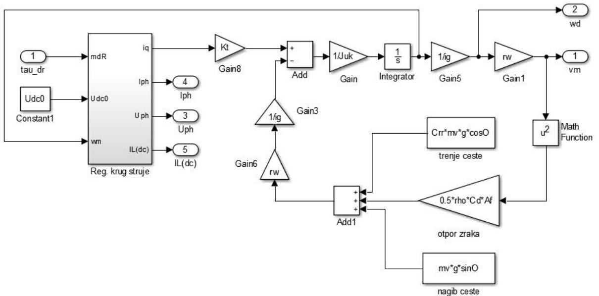
**Slika 6-2** Matlab/Simulink dinamički model vozila
