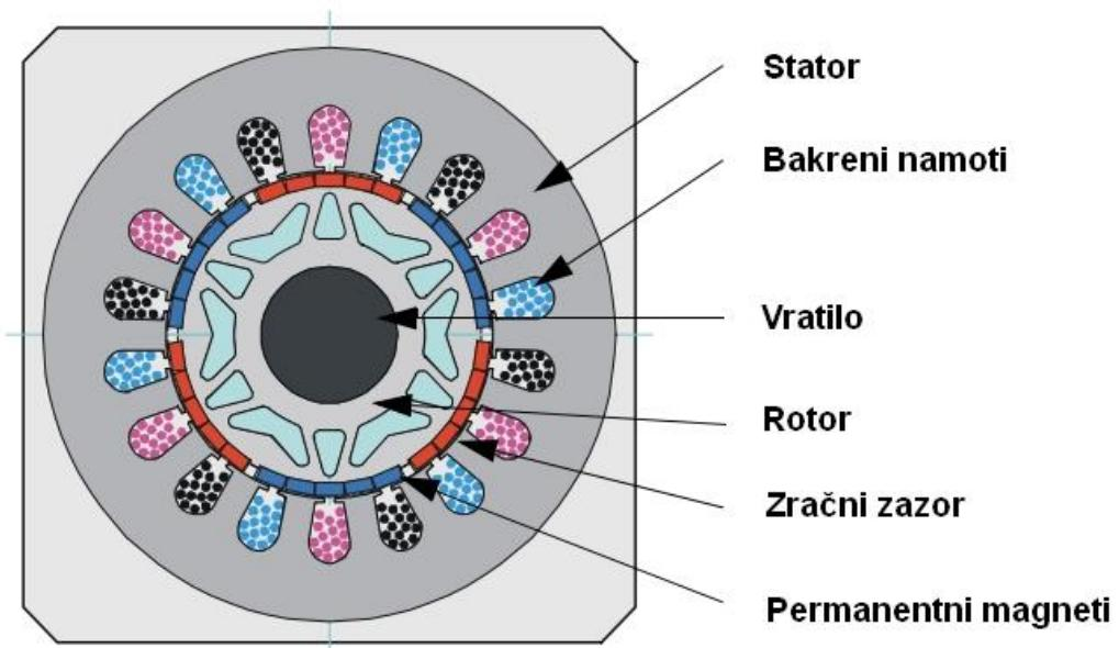
Slika 2-1 Presjek PMSM
