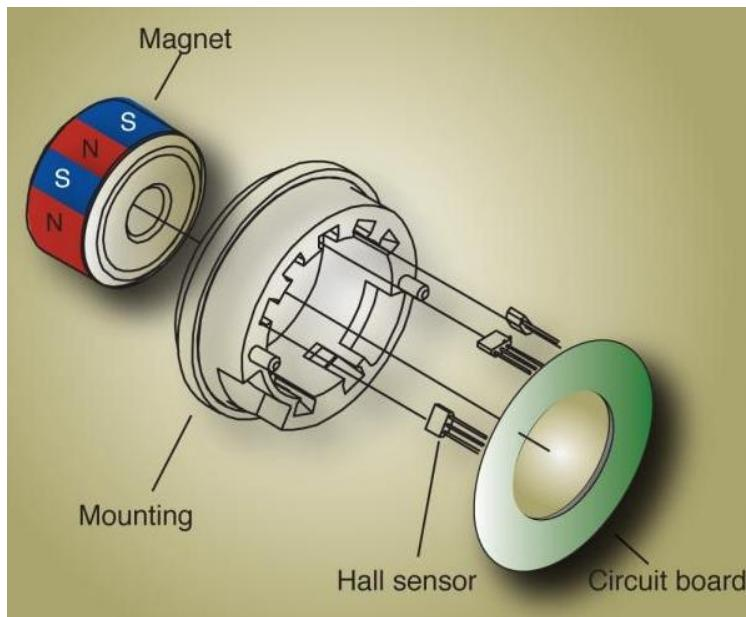
Slika 2-9 Magnetski enkoder baziran na Hallovom efektu
