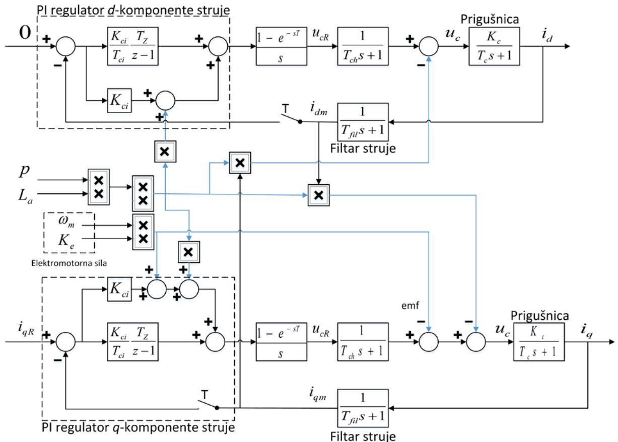
Slika 5-1 Blokovski dijagram PI regulacije struje motora u  $dq$  sustavu
