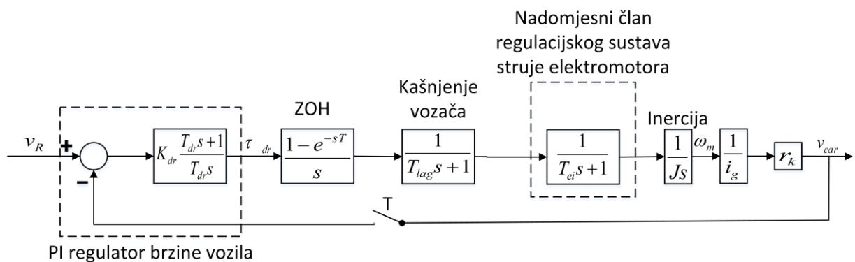
Slika 6-4 Regulacijska petlja brzine vozila
