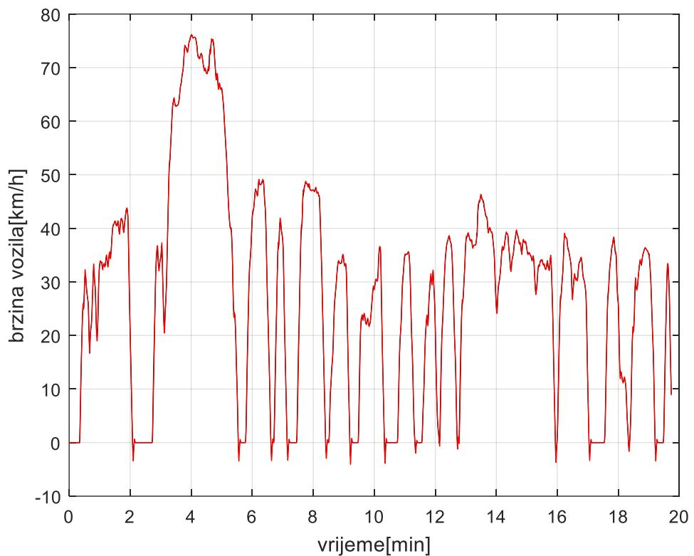
Slika 6-12 UDDS profil brzine vozila
