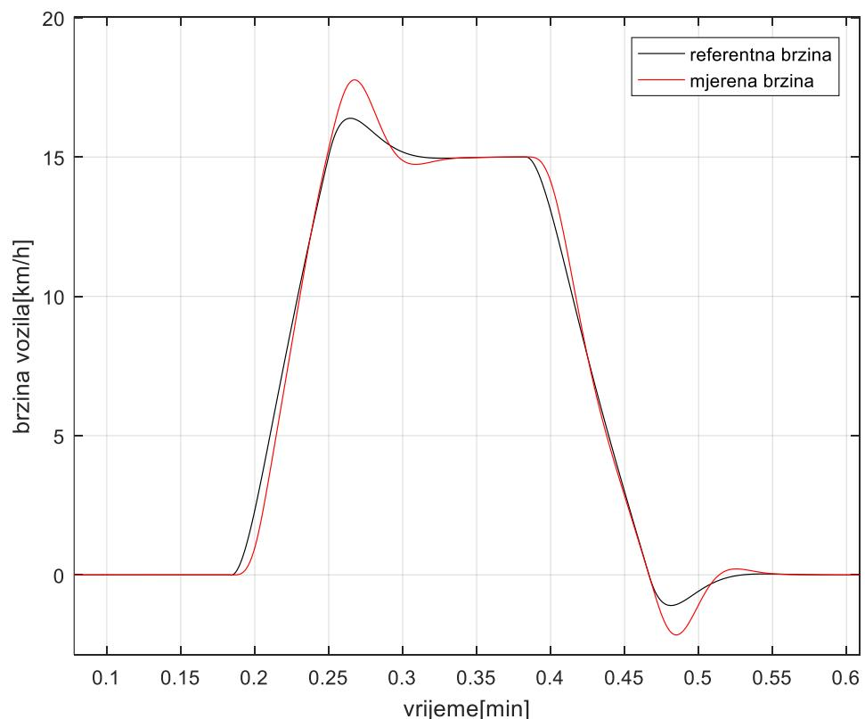
Slika 6-9 Praćenje referentne brzine NEDC profila
