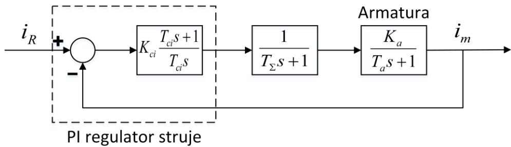
Slika 5-2 Pojednostavljeni zatvoreni regulacijski krug struje servomotora
