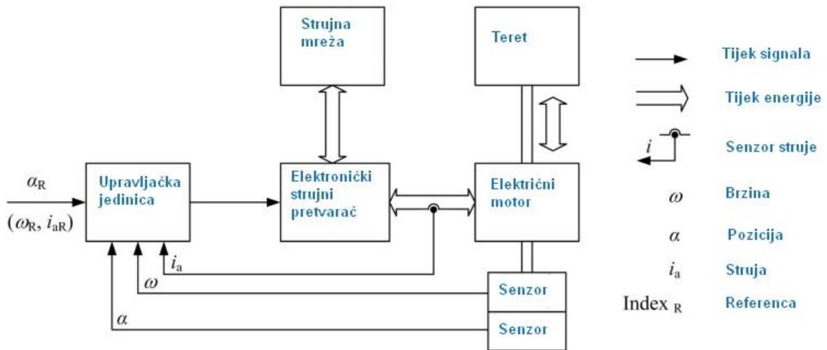
Slika 4-1 Strukturni blok dijagram upravljanog pogona [10]
