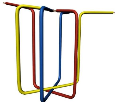
**Slika 2-5 Pojednostavljeni prikaz statora**
