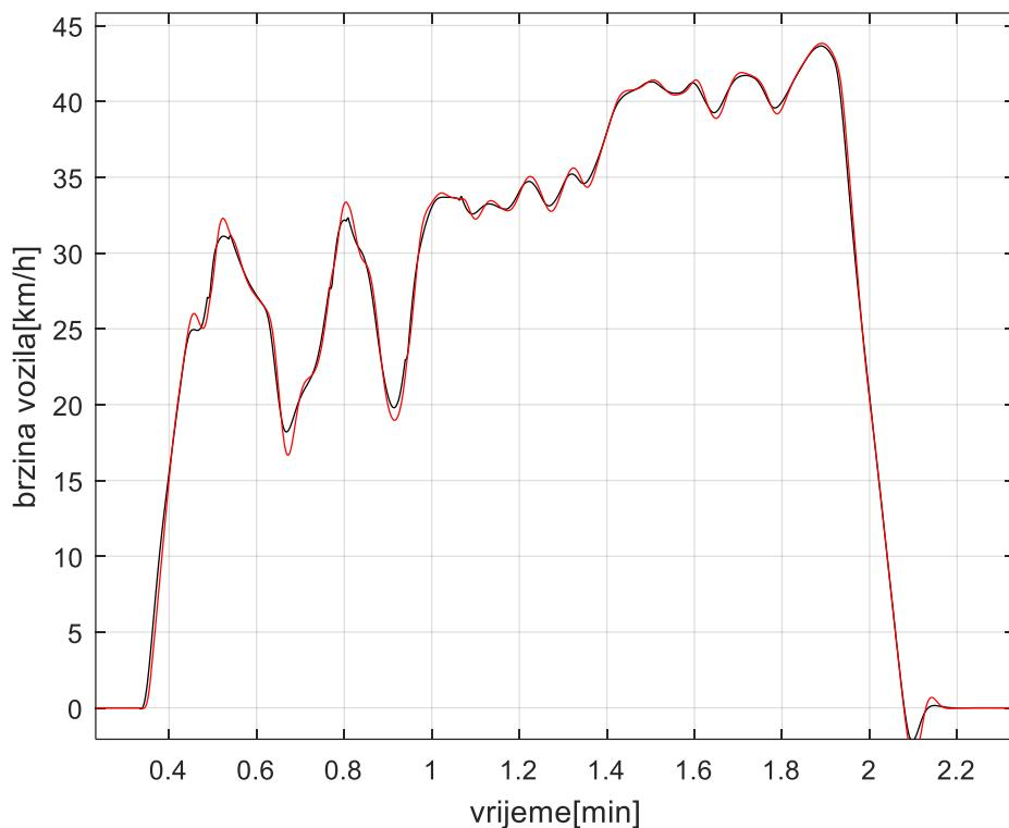
Slika 6-13 Praćenje referentne brizne UDDS profila
