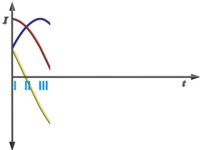
Slika 2-7 Struje  $ia$ ,  $ib$ ,  $ic$  u trenucima I, II i III
