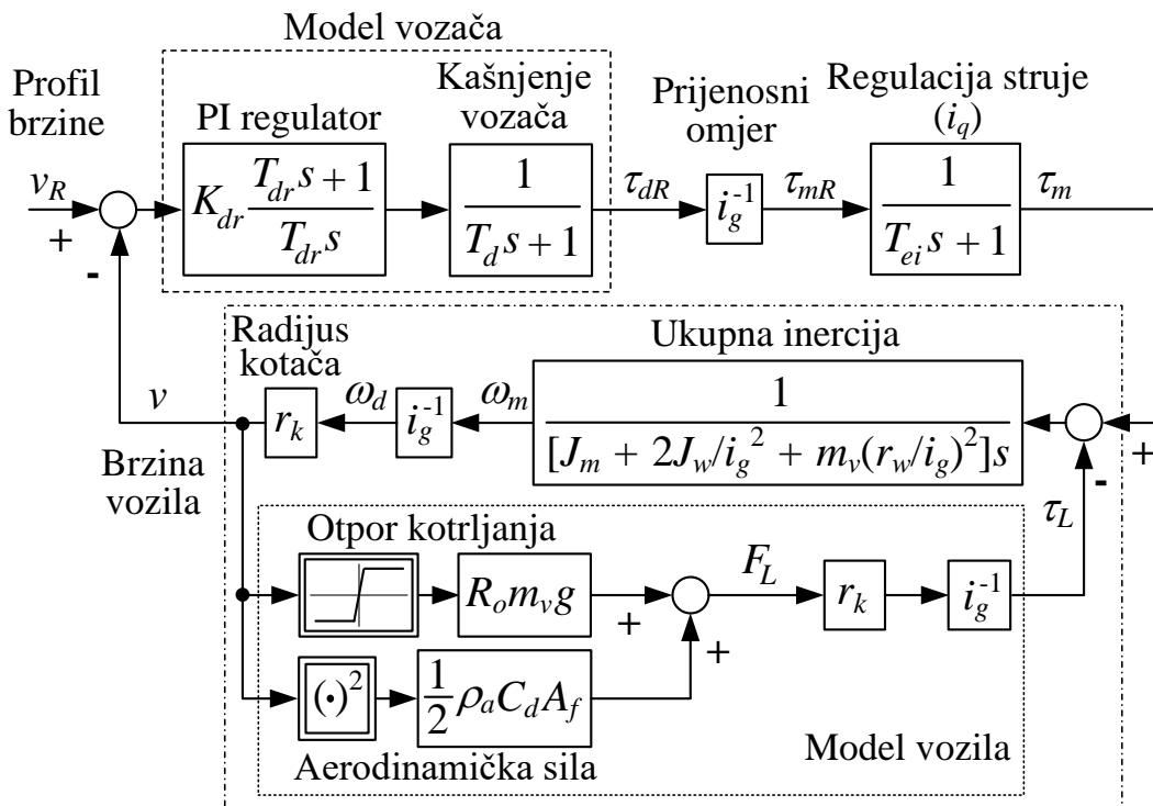
Slika 6-3 Pojednostavljeni model dinamike vozila sa modelom vozača
