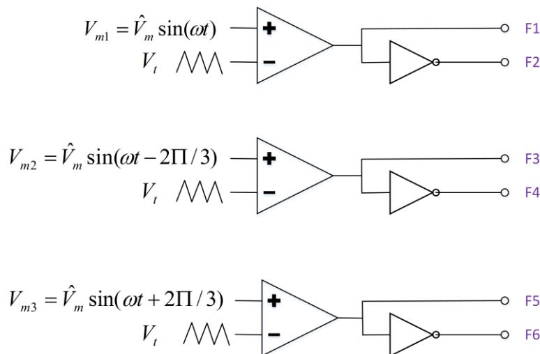
Slika 2-11 PWM logika upravljanja pretvaračem
