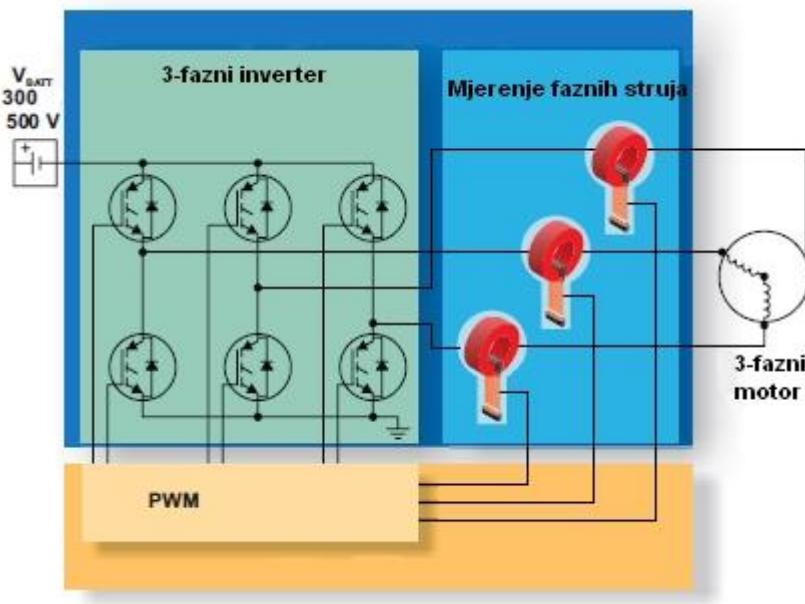
Slika 2-8 Mjerenje struje - Hallov senzor
