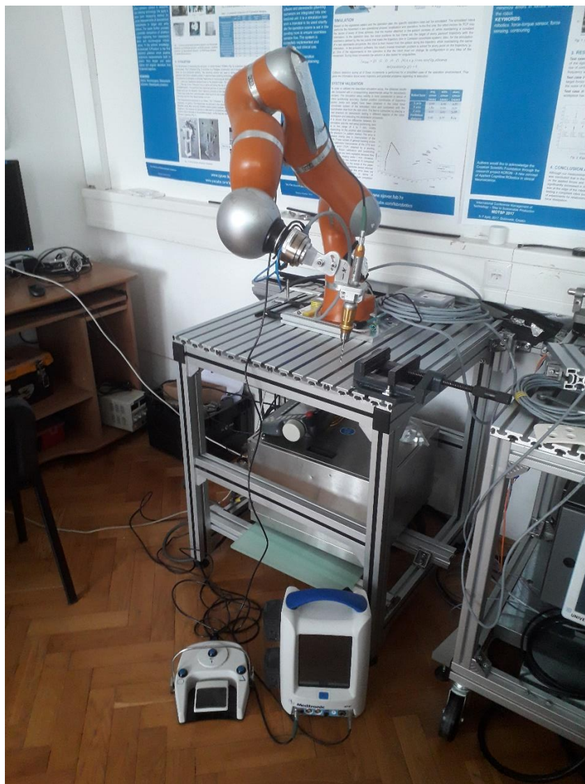
Slika 12. Laboratorijski postav za bušenje
