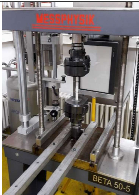
Slika 4.7 Kidalica Messphysik Beta 50-5
