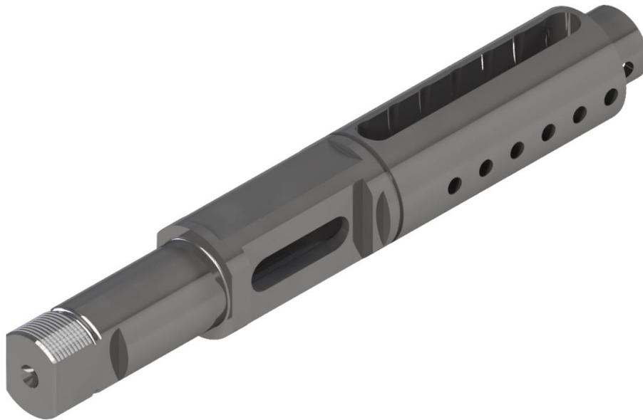
**Slika 4. Izlazno vratilo 7-stupanjskog mjenjača brzina mopeda Tomos, pogled 1**
