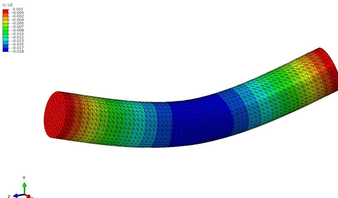
Slika 25. Raspodjela pomaka verifikacijskog modela vratila u mm
