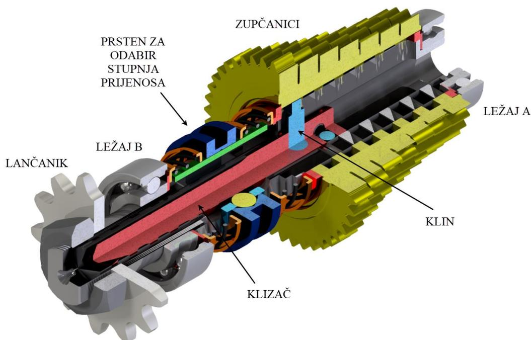
Slika 20. 3/4 presjek elemenata na izlaznom vratilu 7-stupanjskog mjenjača
