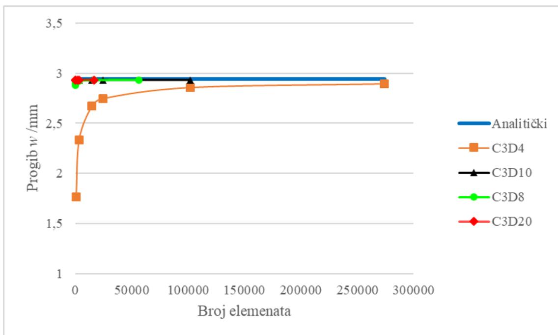
Slika 15. Konvergencija progiba grede opterećene na savijanje
