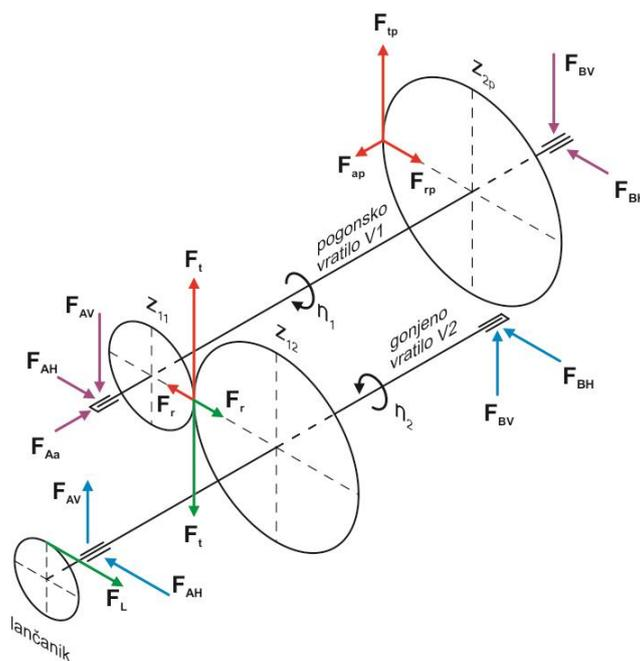
Slika 27. Shematski prikaz vratila i opterećenja [1]
