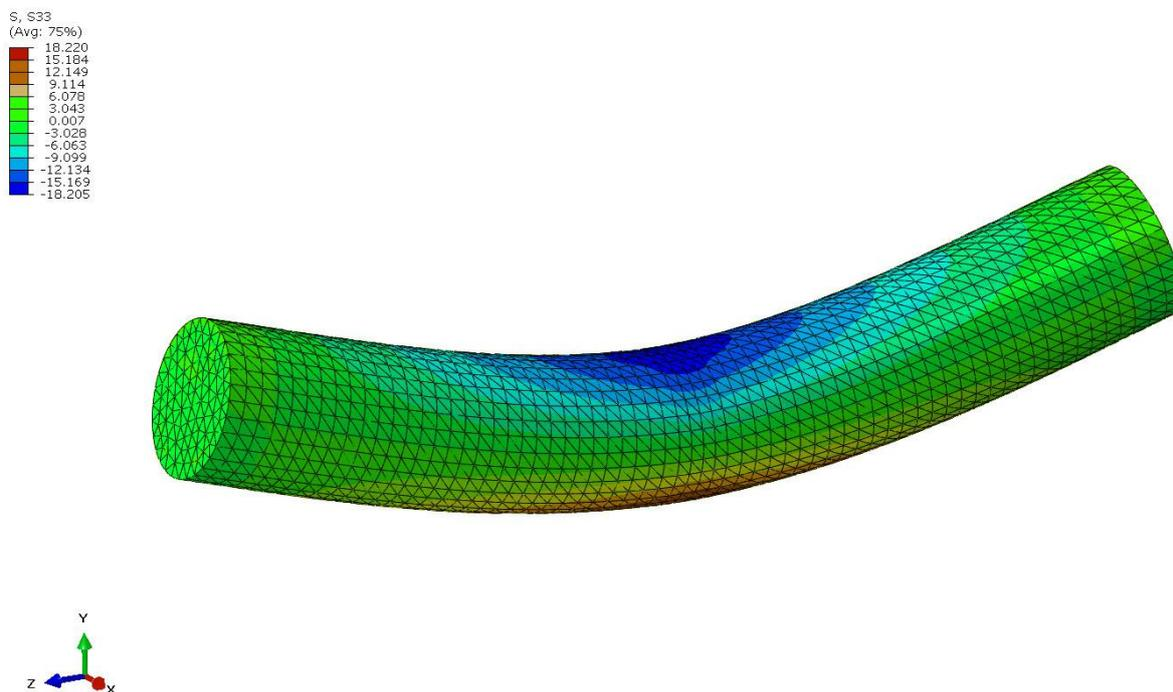
Slika 24. Raspodjela naprezanja verifikacijskog modela vratila u MPa
