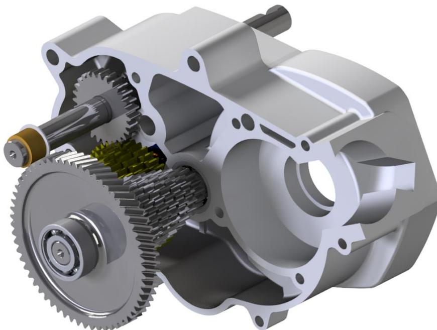
**Slika 3. Kućište motora mopeda Tomos, otvoreno, pogled 2**
