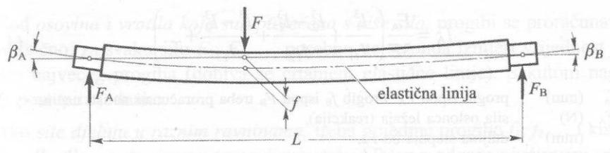
Slika 21. Progib osovine ili vratila i nagib rukavaca u ležajnim mjestima [7]
