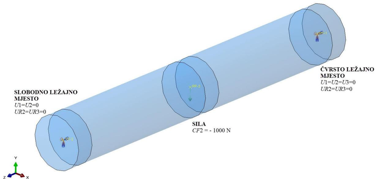
Slika 23. Rubni uvjeti i opterećenje verifikacijskog modela vratila
