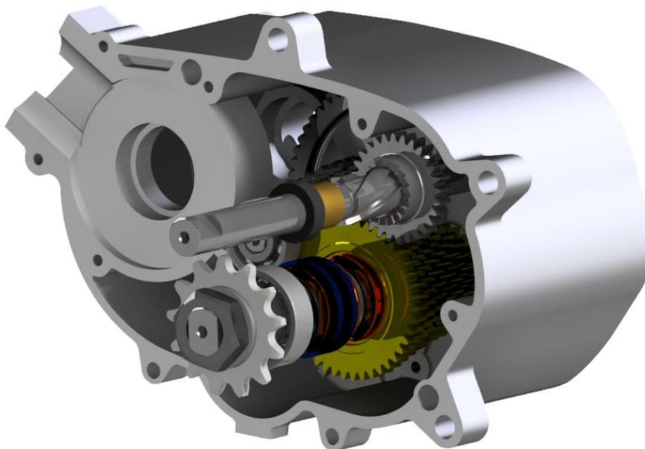
**Slika 2. Kućište motora mopeda Tomos, otvoreno, pogled 1**
