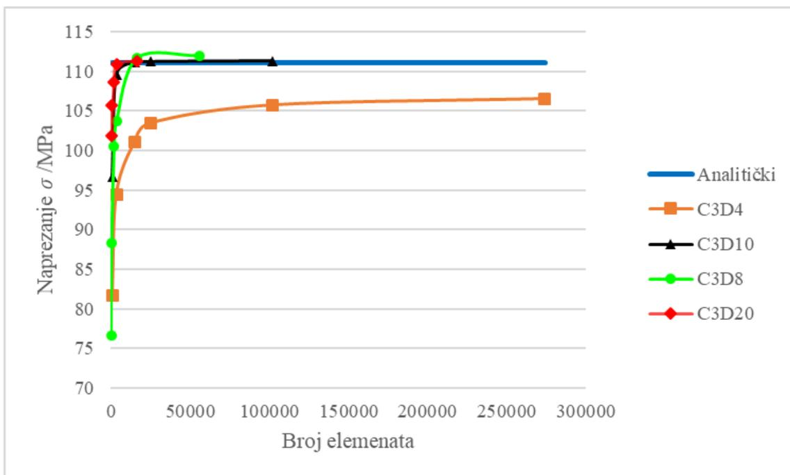
Slika 14. Konvergencija naprezanja grede opterećene na savijanje
