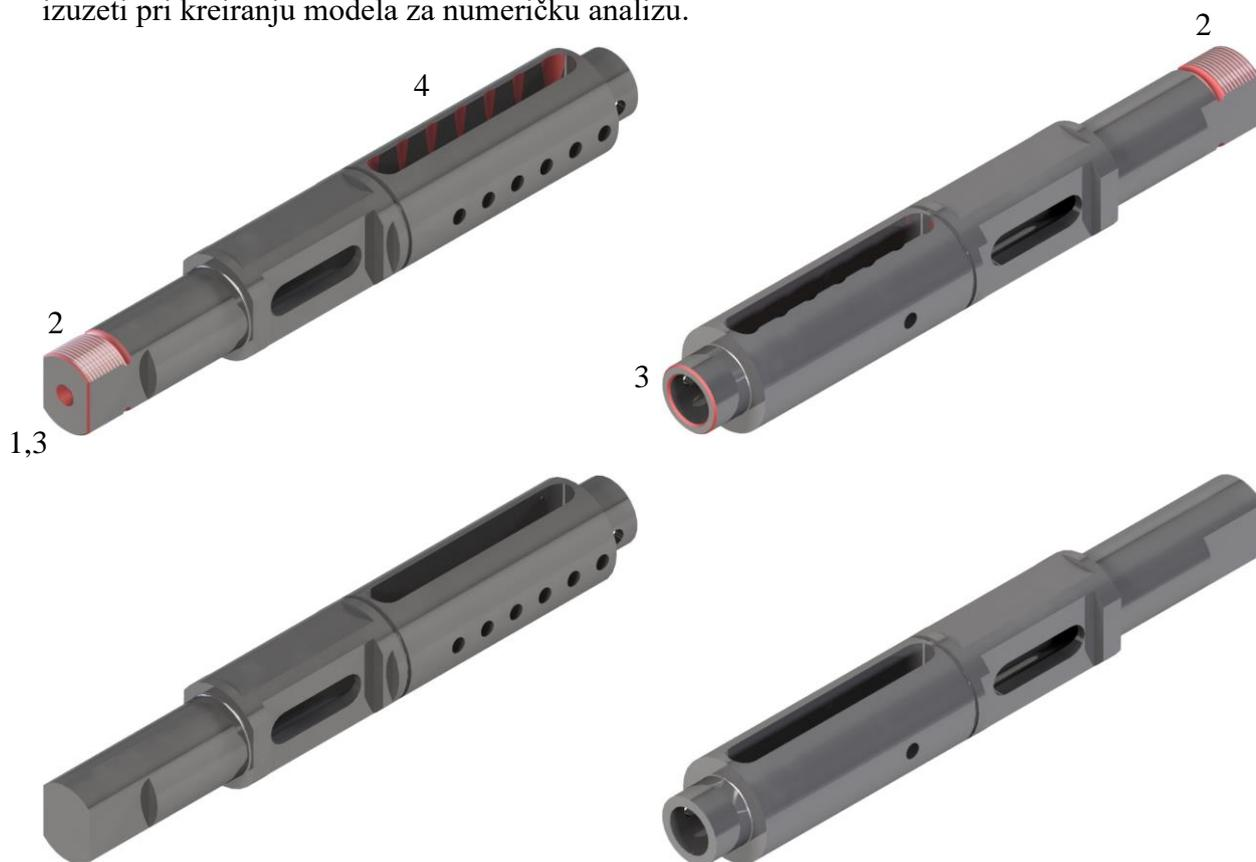
Slika 26. Priprema modela za numeričku analizu
