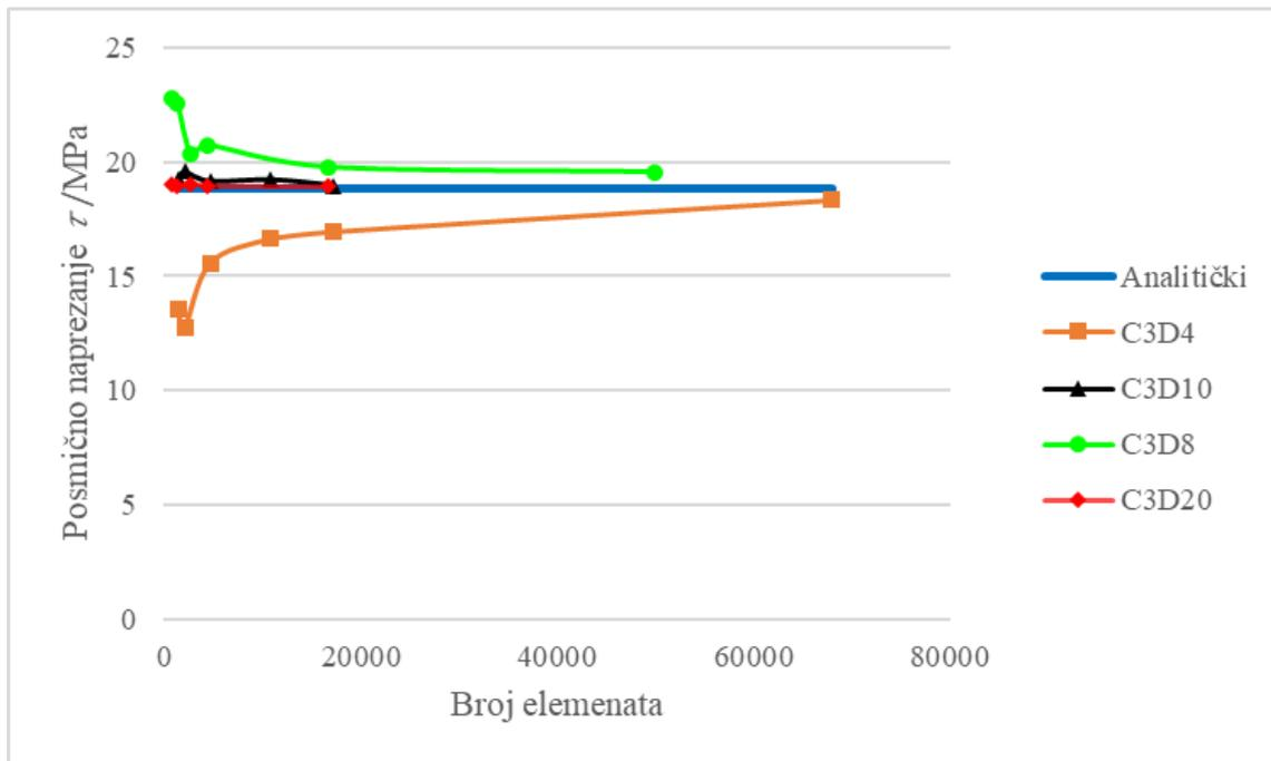
Slika 19. Konvergencija posmičnog naprezanja grede opterećene na uvijanje
