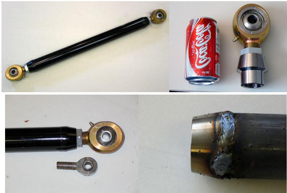
Slika 7. Vodilica zavisnog ovjesa [9]
