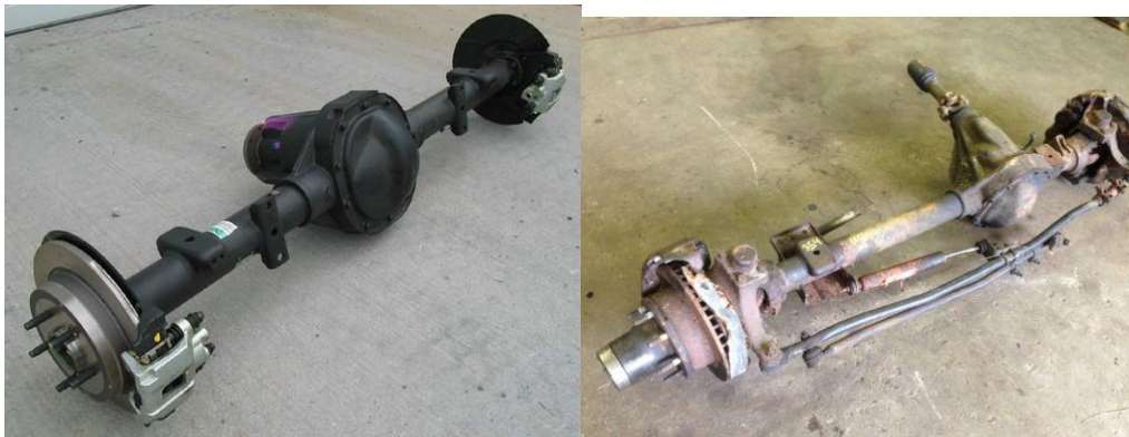
Slika 15. Stražnja [17] i prednja [18] pogonska kruta osovina
