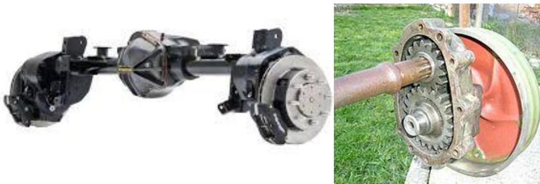
Slika 18. Portalna kruta osovina [22,23]
