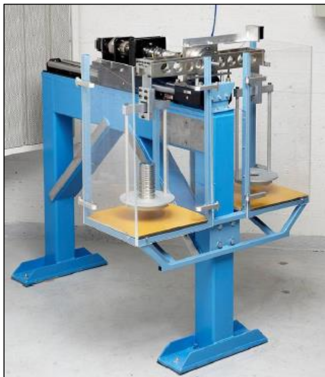
Slika 20. Uređaj za umjeravanje mjernih pretvornika do 50 N·m (MIKES RAUTE) [16]
