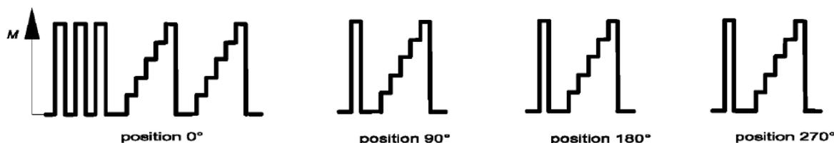
Slika 60. Primjer predopterećenja i redosljeda umjeravanja za vratila/utore kvadratnog presjeka s minimalno 5 koraka umjeravanja, samo za rastući moment; mjerna nesigurnost uređaja za umjeravanje  $0,1 \leq U < 1\%$  [31]
