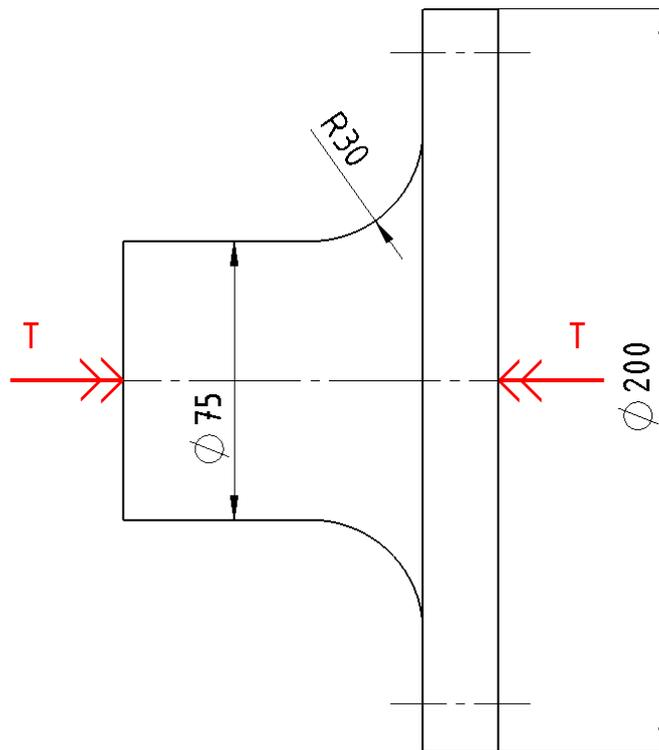
Slika 52. Vratilo aktuatora
