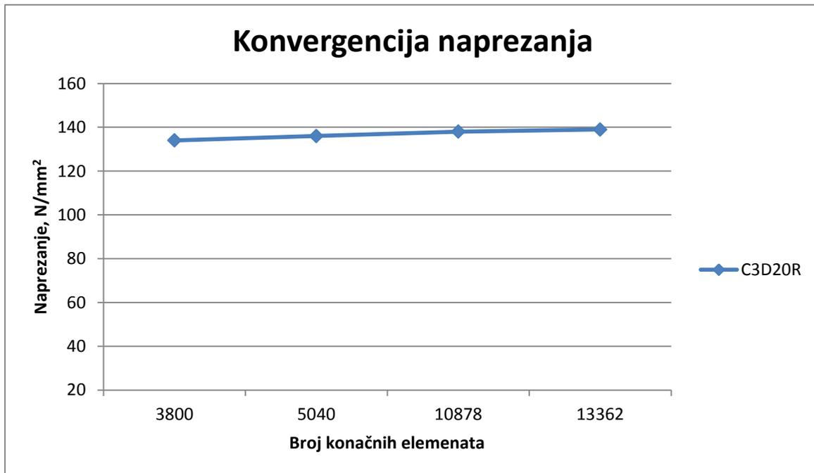
Slika 56. Konvergencija naprezanja s povećanjem broja konačnih elemenata
