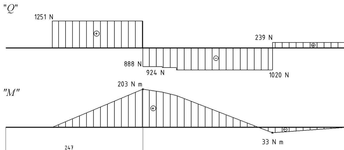
**Slika 46. Dijagrami unutrašnjih sila i momenata savijanja vratila**
