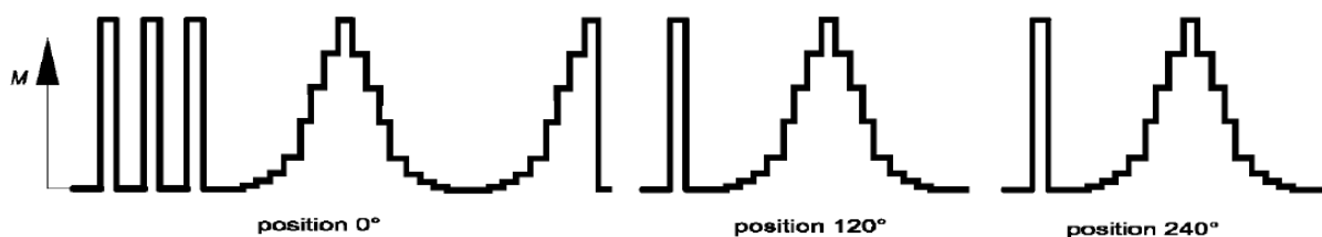
Slika 58. Primjer predopterećenja i redosljeda umjeravanja s minimalno 8 koraka umjeravanja i mjernu nesigurnost uređaja za umjeravanje U < 0,1\% [31]
