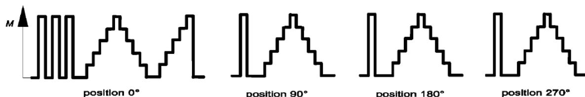
Slika 59. Primjer predopterećenja i redosljeda umjeravanja za vratila/utore kvadratnog presjeka s minimalno 5 koraka umjeravanja i mjernu nesigurnost uređaja za umjeravanje  $0,1 \leq U < 1\%$  [31]
