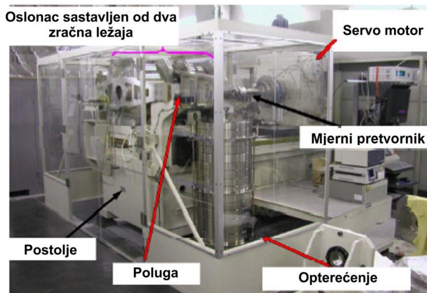
Slika 16. Uređaj za umjeravanje mjernih pretvornika do 20000 N·m (NMIJ) [14]
