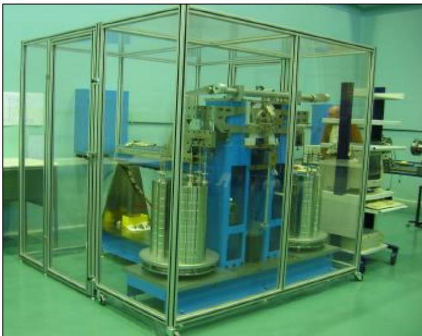
Slika 21. Uređaj za umjeravanje mjernih pretvornika do 1000 N·m (CEM) [17]
