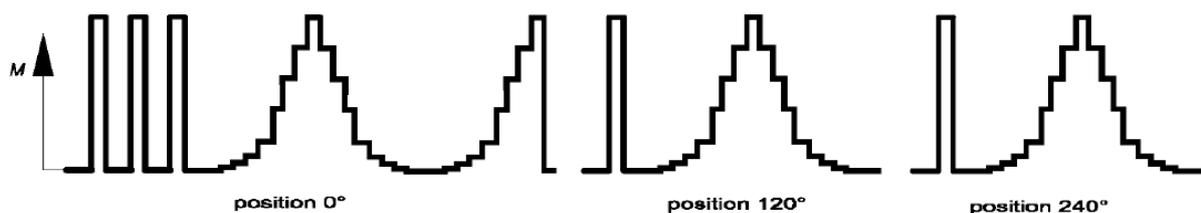
Slika 58. Primjer predopterećenja i redosljeda umjeravanja s minimalno 8 koraka umjeravanja i mjernu nesigurnost uređaja za umjeravanje  $U < 0,1\%$  [31]
