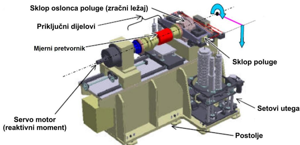
Slika 15. Uređaj za umjeravanje mjernih pretvornika do 1000 N·m (NRLM) [6]
