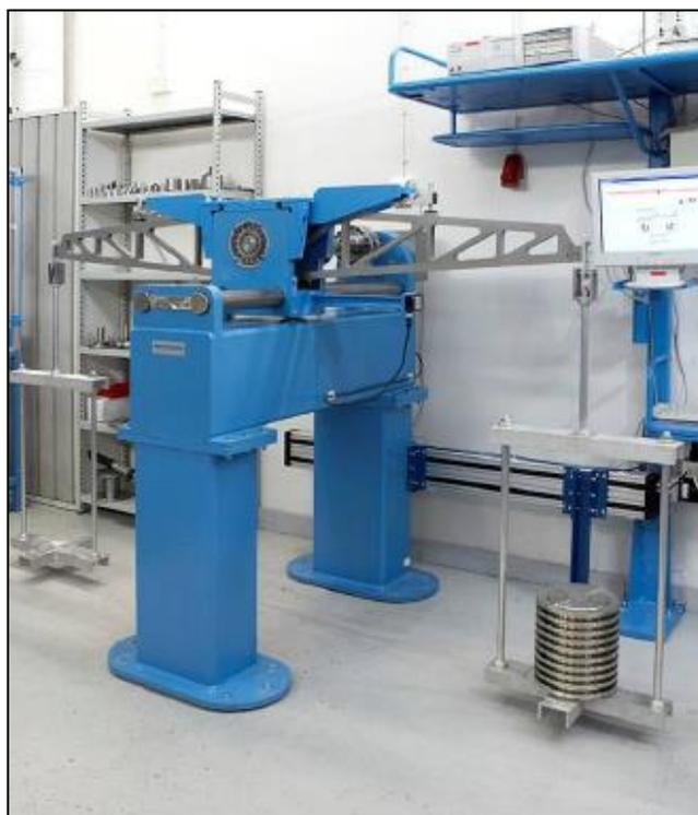
**Slika 19. Uređaj za umjeravanje mjernih pretvornika do 2000 N·m (MIKES RAUTE) [16]**
