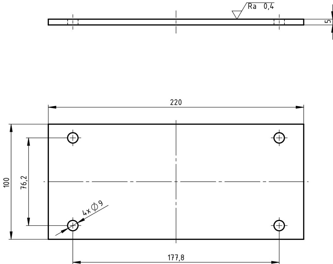
Provrtne  $\varnothing 9$  bušiti nakon zavarivanja sa stupom ležaja (vidi sklopni crtež).
