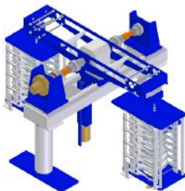
Slika 22. Uređaj za umjeravanje mjernih pretvornika do 1000 N·m (CENAM) [9]
