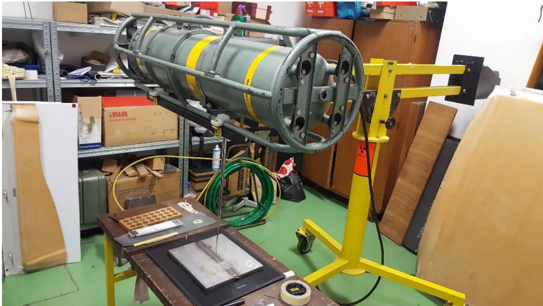
Slika 48. Uzorak pripremljen za radiografsko ispitivanje
