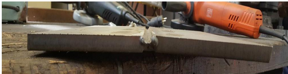
Slika 43. Izbrušen korijen zavara - uzorak A
