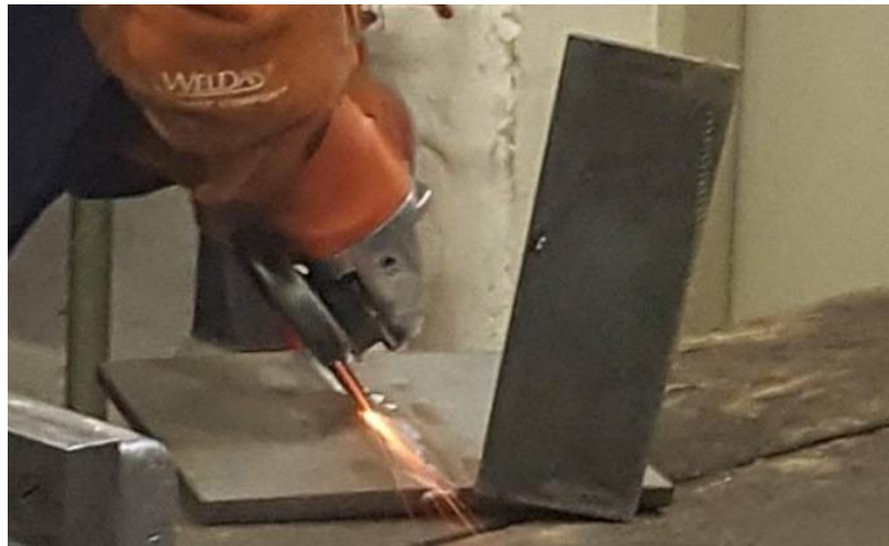
Slika 42. Brušenje korijena zavara - uzorak A
