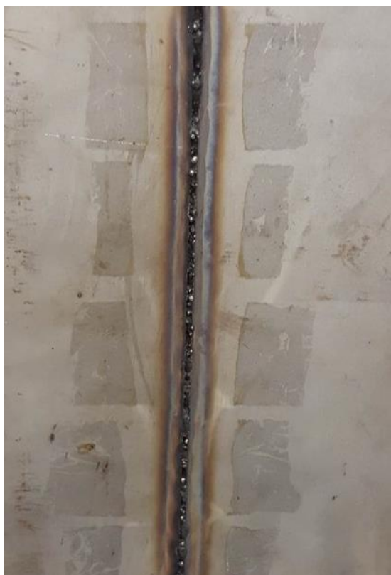
Slika 45. Izgled korijena zavara uzorka B
