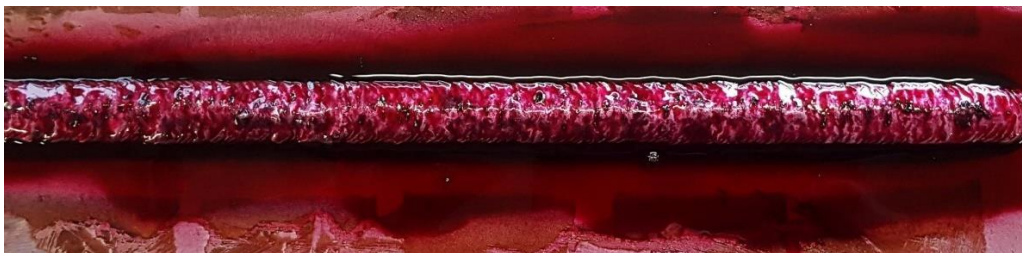
Slika 53. Uzorak B s nanesenim penetrantom - korijen zavara
