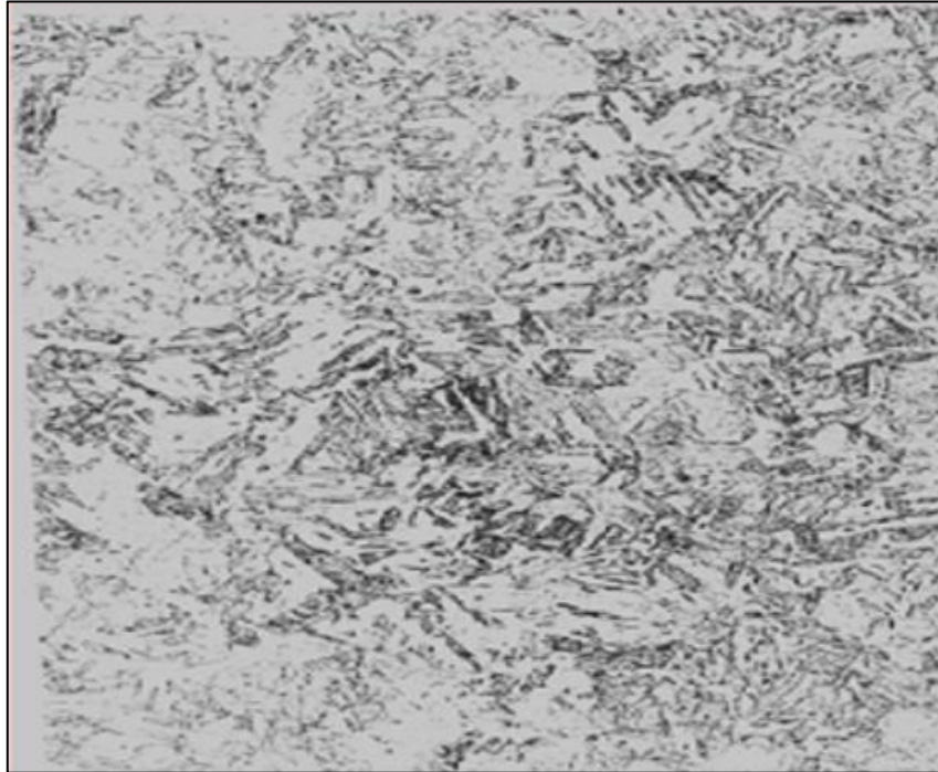
Slika 4. Mikrostruktura martenzitnog nehrđajućeg čelika [3]
