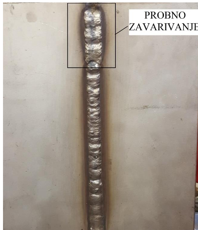
Slika 46. Izgled popune zavora uzorka B
