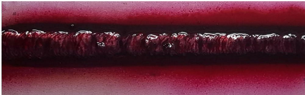
Slika 52. Uzorak B s nanesenim penetrantom - lice zavara
