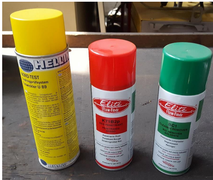
Slika 49. Razvijач, penetrant i čistač korišteni u postupku
