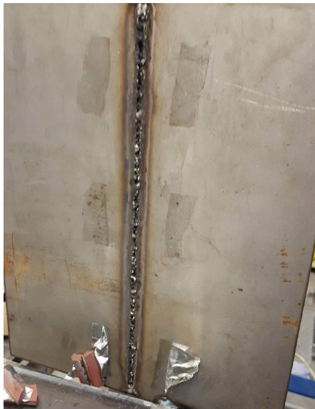
Slika 40. Izgled korijena zavora uzorka A
