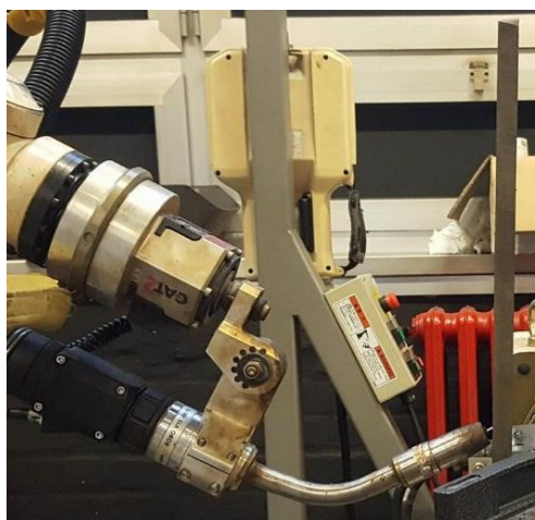
Slika 39. Kut nagiba pištolja za zavarivanje
