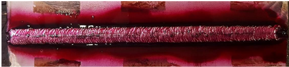
Slika 51. Uzorak A s nanesenim penetrantom - korijen zavara
