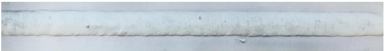
Slika 76. Uzorak B s nanesenim razvijačem - korijen zavora
