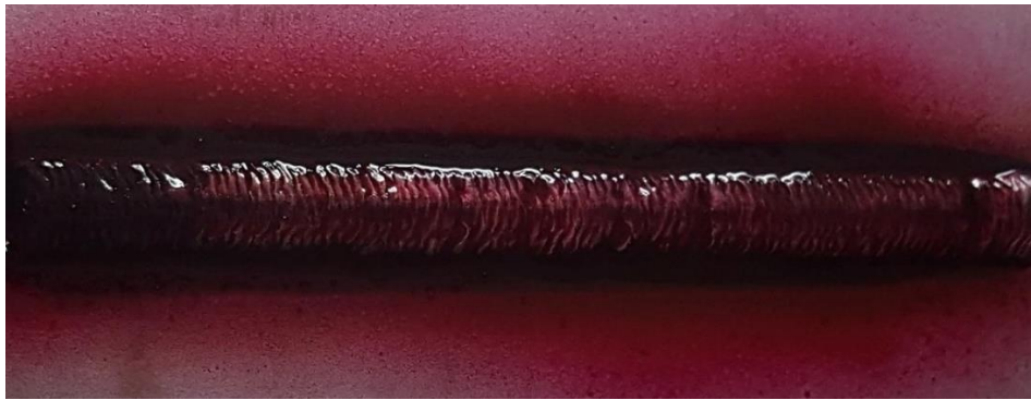
Slika 50. Uzorak A s nanesenim penetrantom - lice zavara
