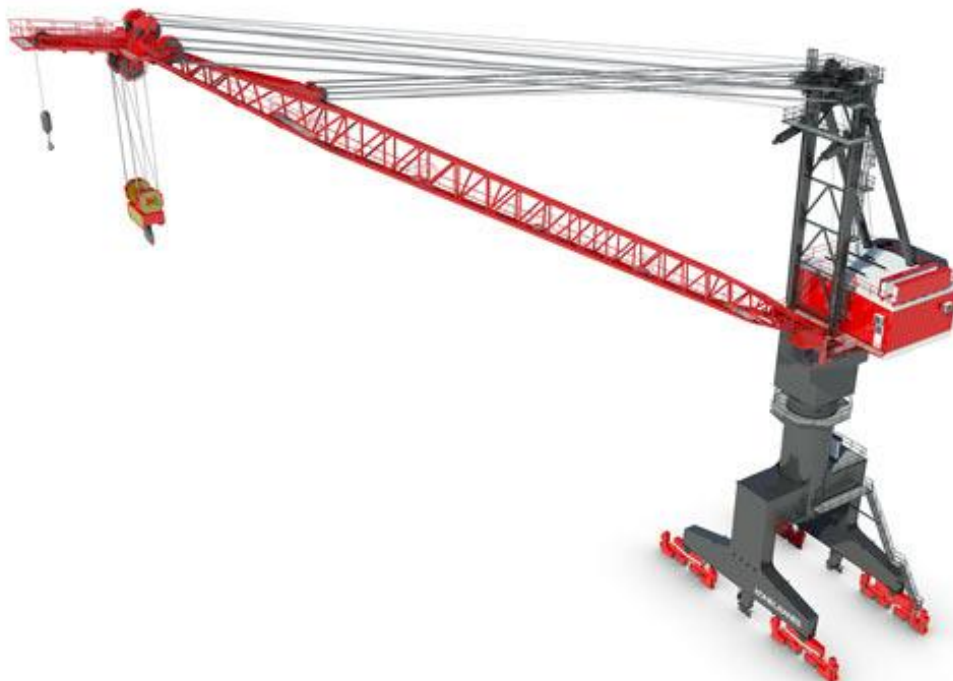
Slika 1. Jednokraki dohvatnik tvrtke Konecranes [1]
