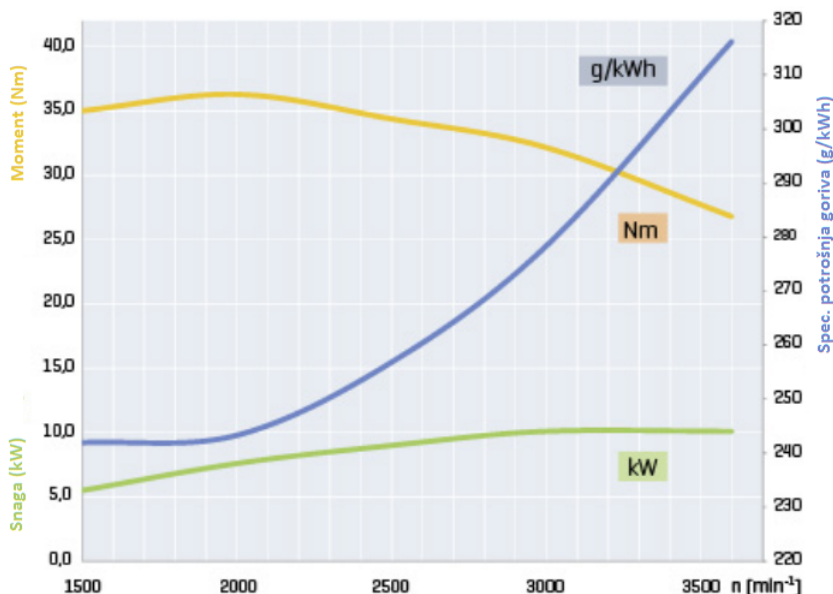
Slika 23. Vanjske značajke originalnog HATZ 1D81 motora [12]
