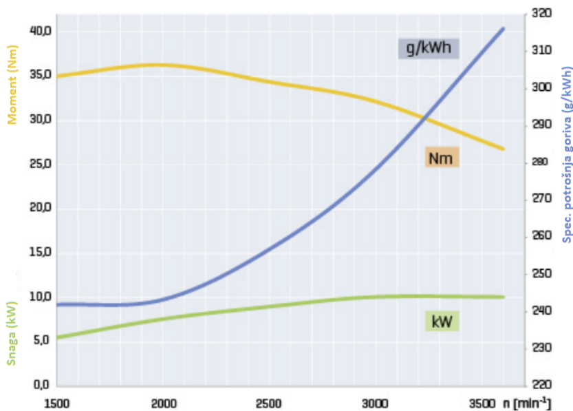
Slika 23. Vanjske značajke originalnog HATZ 1D81 motora [12]
