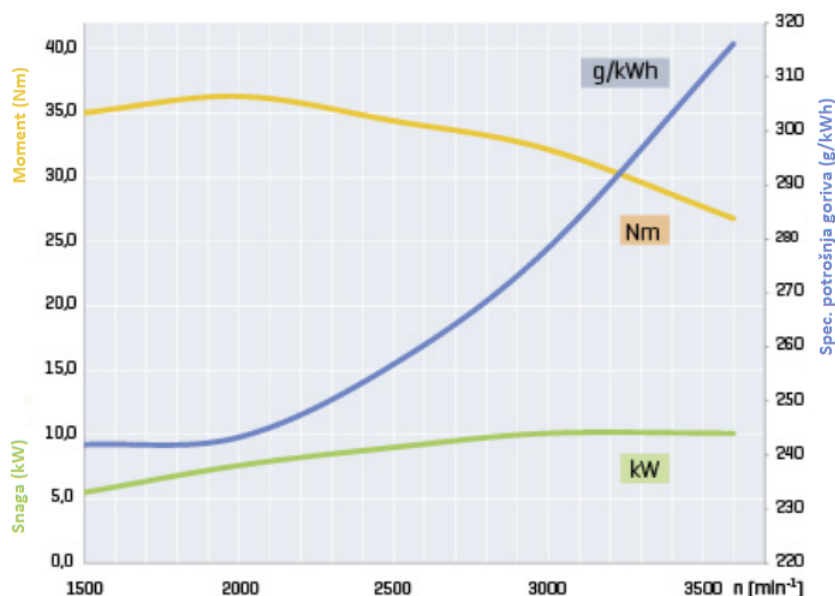
Slika 23. Vanjske značajke originalnog HATZ 1D81 motora [12]
