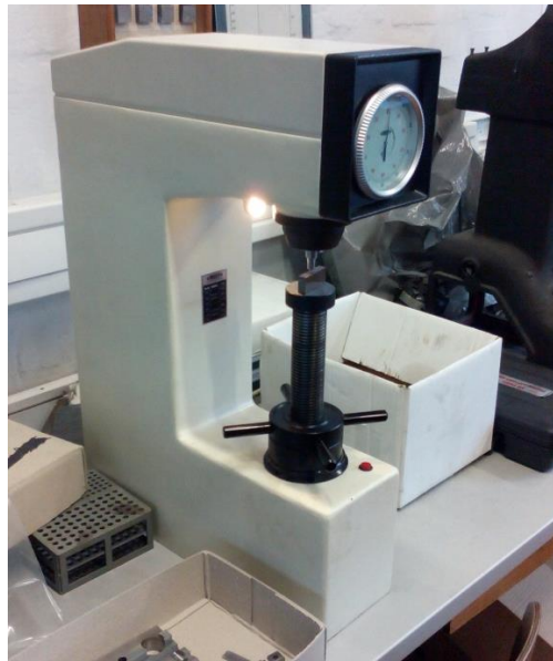
Slika 5.11 Rocwellov tvrdomjer u laboratoriju za toplinsku obradu FSB-a
