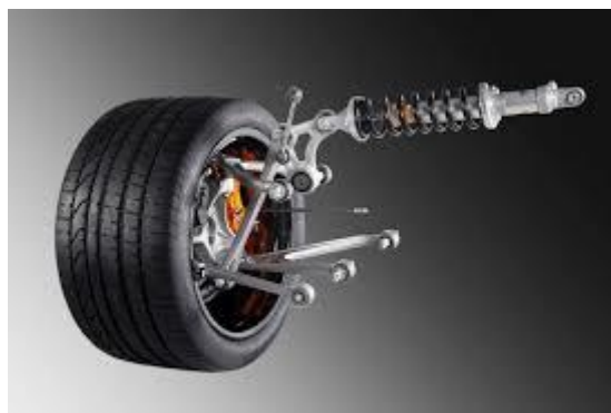
Slika 13. Mogućnost smještaja amortizera
