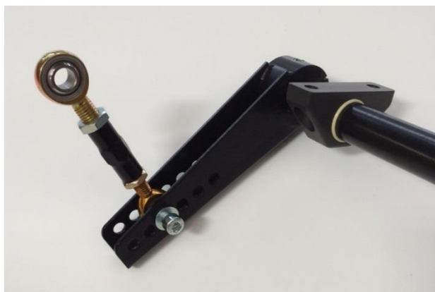
Slika 16. Podešavanje krutosti stabilizatora
