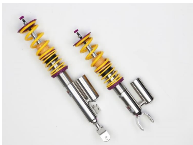
Slika 7. Opruga i prigušni element
