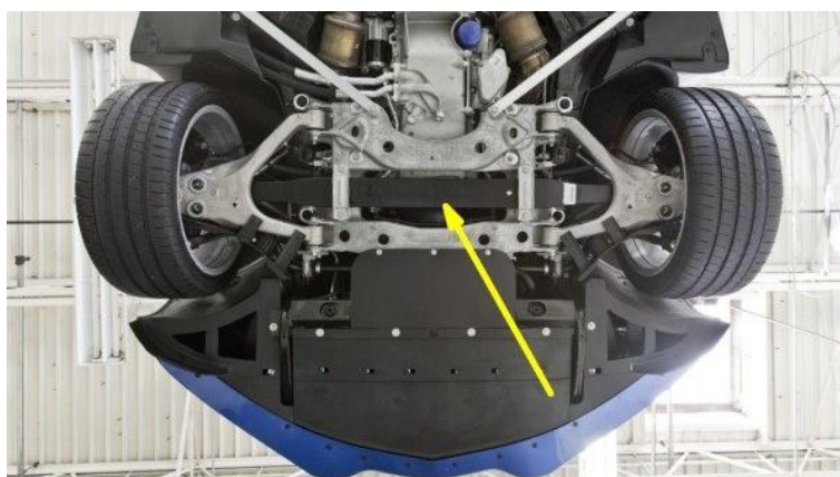
Slika 4. Lisnata opruga na Chevrolet Corvette
