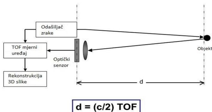
Slika 7. Princip određivanja udaljenosti objekta TOF 3D skenerom
