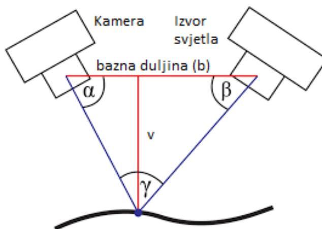
Slika 9. Princip triangulacije
