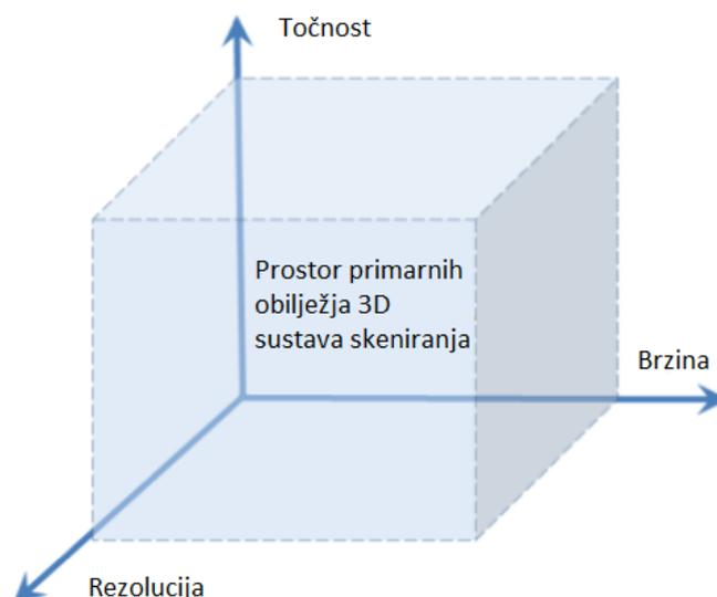
Slika 25. Primarna obilježja 3D sustava skeniranja
