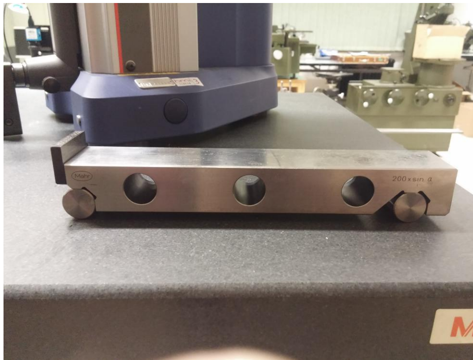
Slika 17. Sinus lineal 200 \times \sin \alpha
