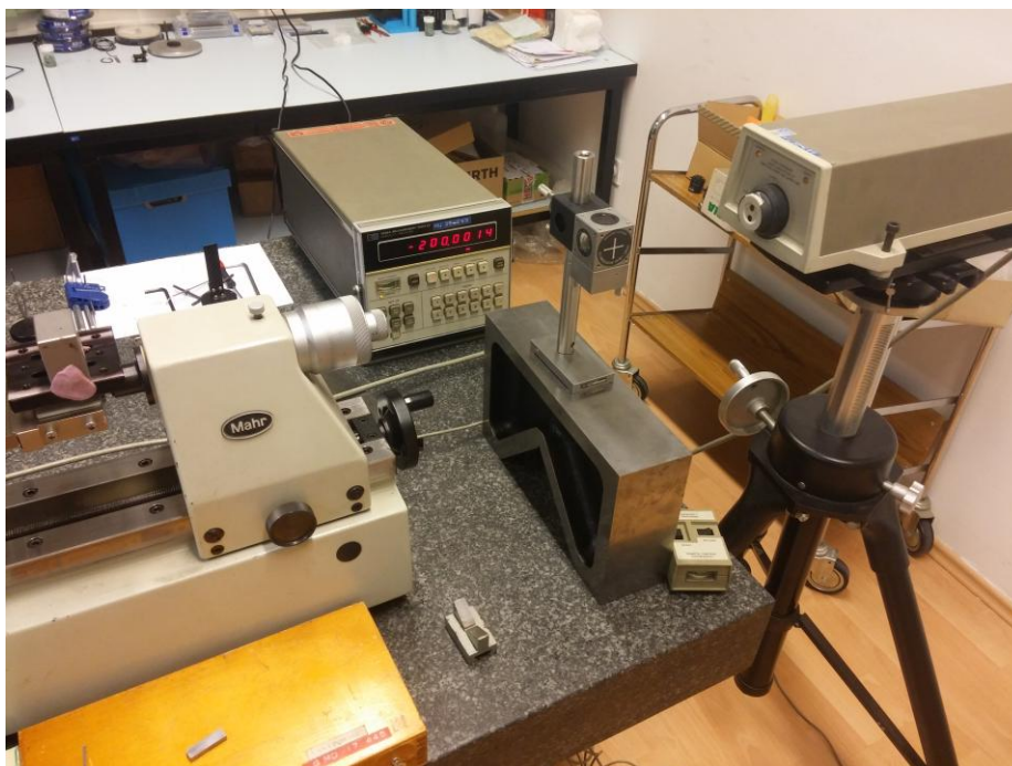
Slika 21. Postavljeni laserski mjerni sustav
