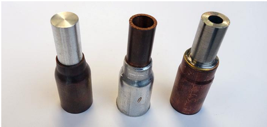
Slika 9. Elektromagnetski spojeni cjevasti profili Al-Cu[18]
