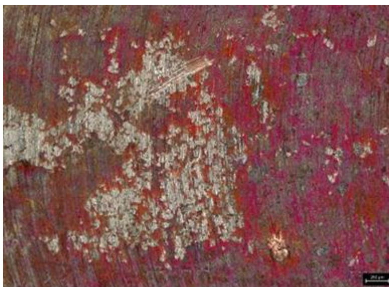
Slika 44. Izgled površine uzorka nakon ispitivanja pri struji od 1 A, povećanje 45x
