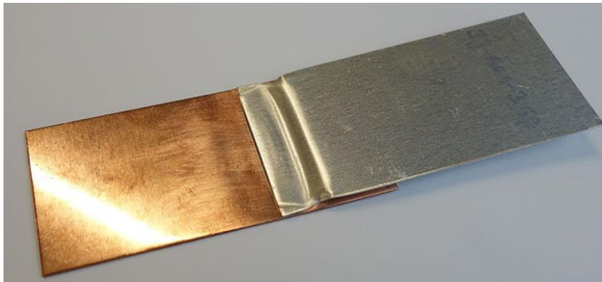
Slika 10. Elektromagnetski spojeni limovi Al-Cu [18]
