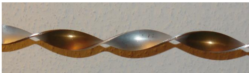
Slika 14. Al-Cu traka nakon postupka laserski induciranog prevlačenja [24]
