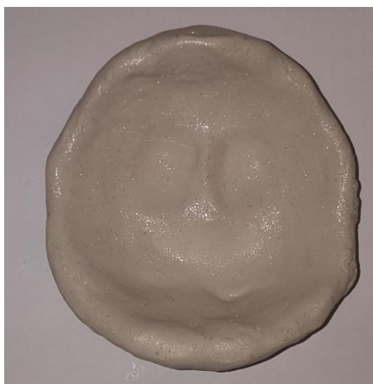
Slika 32. Izrađeni kalup premazan vazelinom
