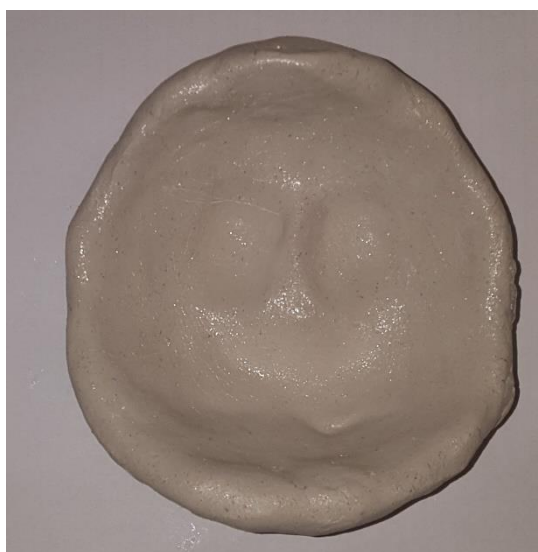
Slika 32. Izrađeni kalup premazan vazelinom
