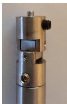
Slika 11. Spoj kardanskog zgloba sa postoljem i poluosovinom nosača
