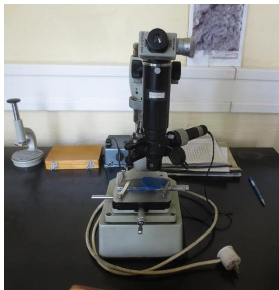
Slika 42. Mikrotvrdomjer PMT-3
