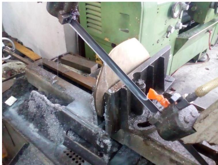
Slika 29. Izrezivanje uzorka tračnom pilom
