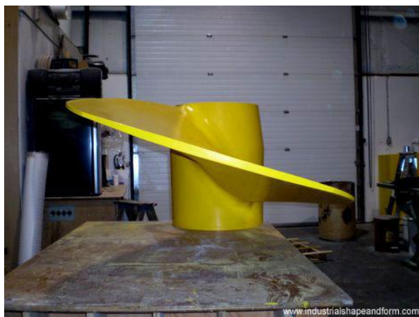
Slika 25. Model brodskog vijka spreman za kalupljenje [19]
