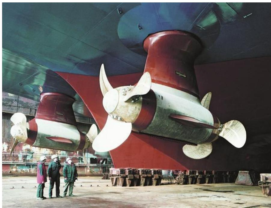
Slika 9. Schottel - Siemens propulzor (SSP) [11]
