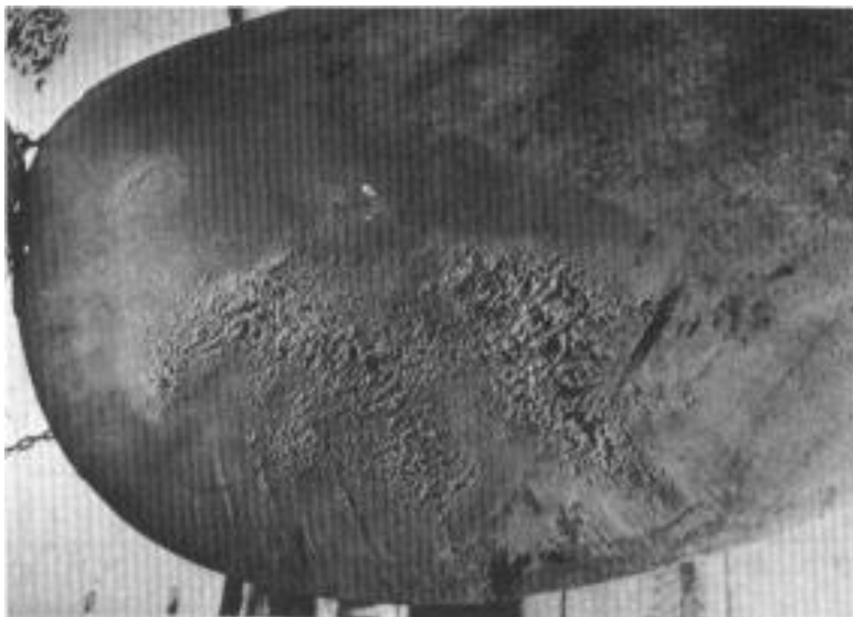
Slika 19. Erozija krila vijka [3]
