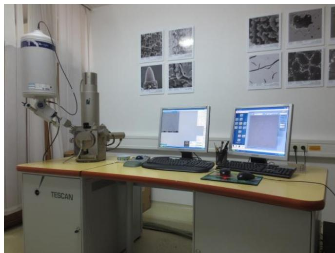
Slika 39. Skenirajući elektronski mikroskop (SEM)
