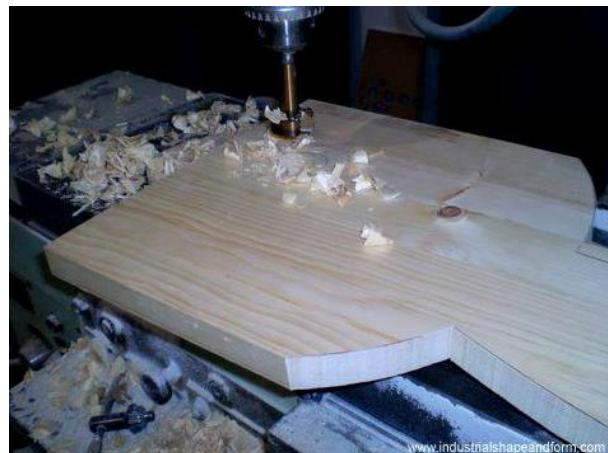
**Slika 22. Bušenje rupa u svakom pojedinom segmentu [19]**
