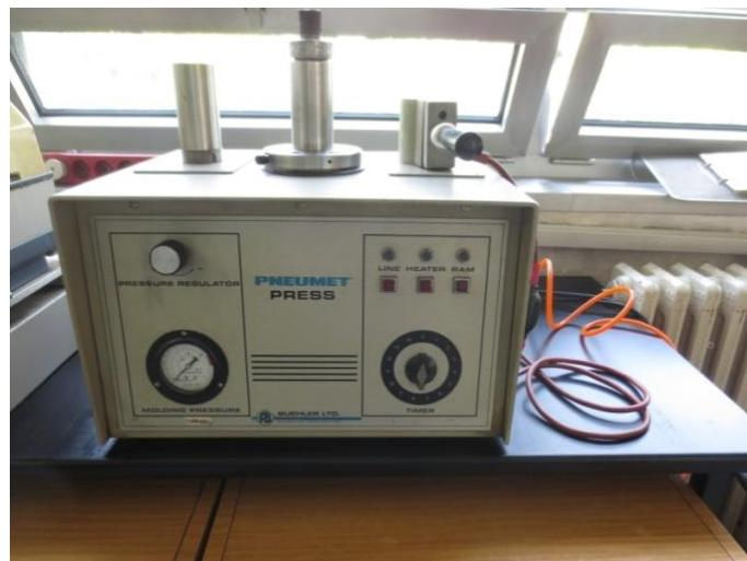
**Slika 31. Polimerna preša PneumetPress za zalijevanje uzorka u polimernu masu**
