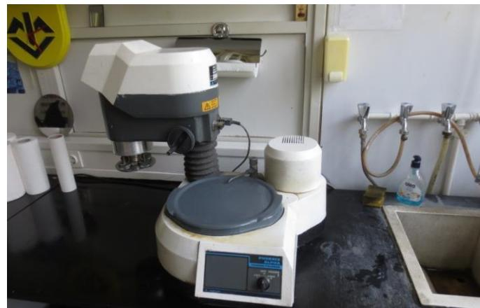
**Slika 33. Brušenje uzorka**
