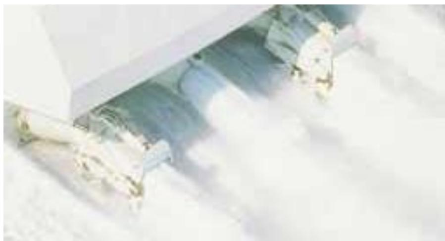
**Slika 11. Vodomlaznipropluzor [8]**
