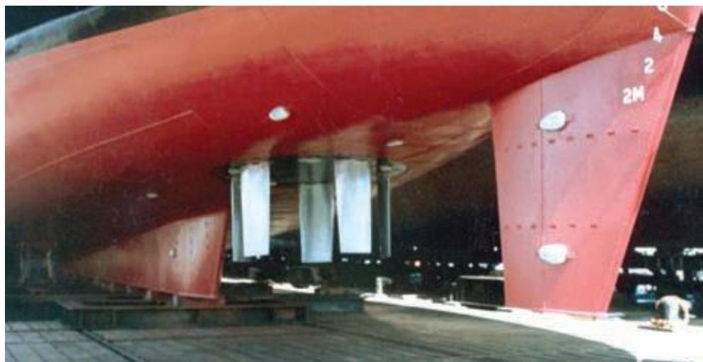
Slika 10. Prikaz krme Voight - Schneiderovog propulzijskog sustava [11]
