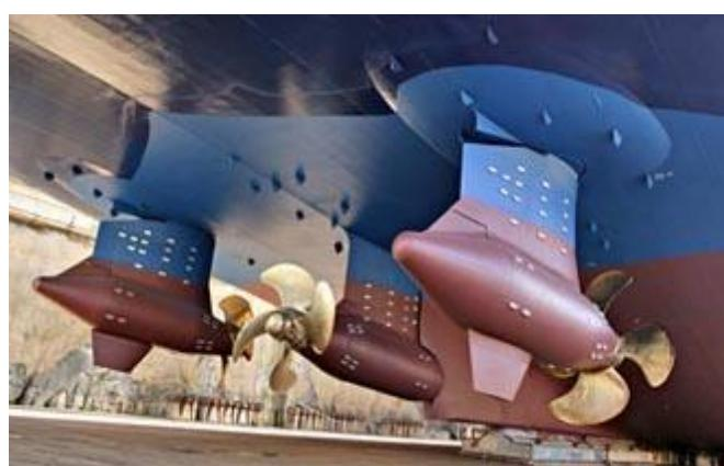
Slika 5. Azipod sustav propulzije [7]
