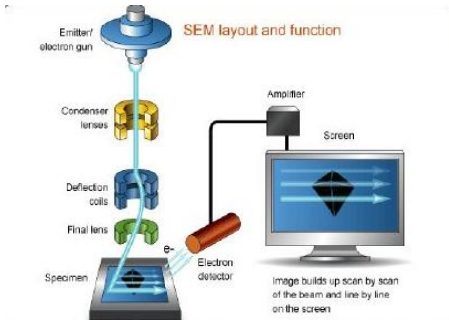
Slika 26. Skenirajući elektronski mikroskop (SEM) [22]
