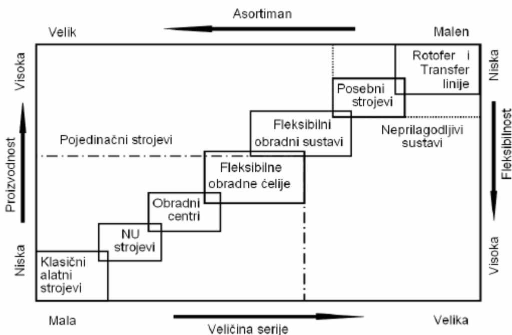
Slika 2. Podjela obradnih strojeva [4]
