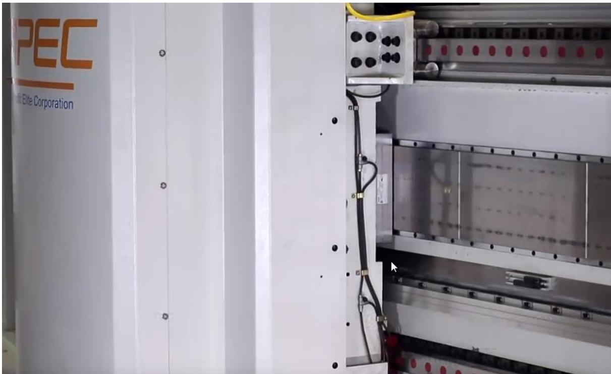
**Slika 33. Y- os obradnog centra pokretana linearnim motorom [37]**
