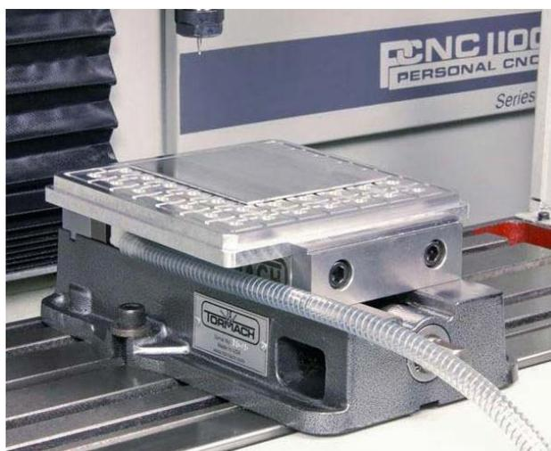
Slika 21. Vakuumska stezna naprava [22]
