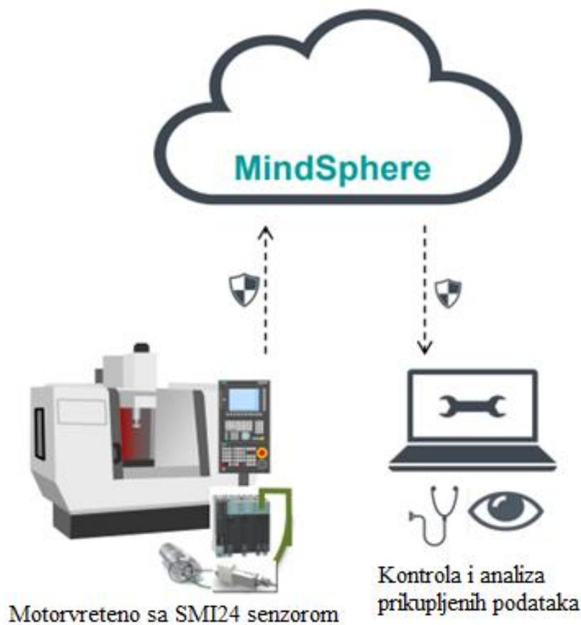
Slika 24. Prikaz toka i analize podataka pomoću "MindSphere" sustava [23]
