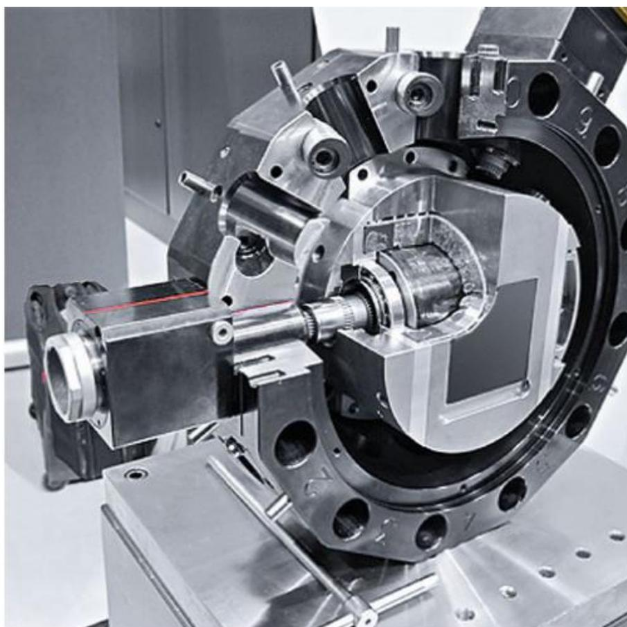
**Slika 31. Direktni pogon pogonjenih alata revolverске glave [33]**
