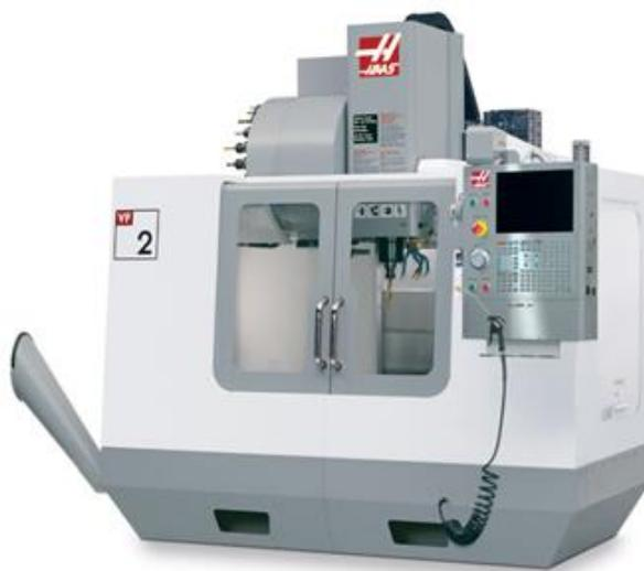
Slika 7. Vertikalni glodaći obradni centar Haas VF2 [10]
