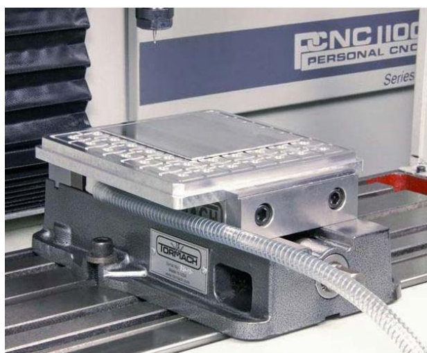
Slika 21. Vakuumska stezna naprava [22]
