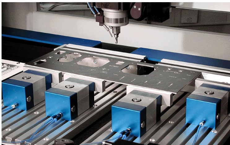
Slika 20. Pneumatska stezna naprava [21]
