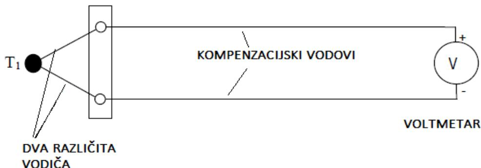
Slika 27. Princip rada termopara [1]
