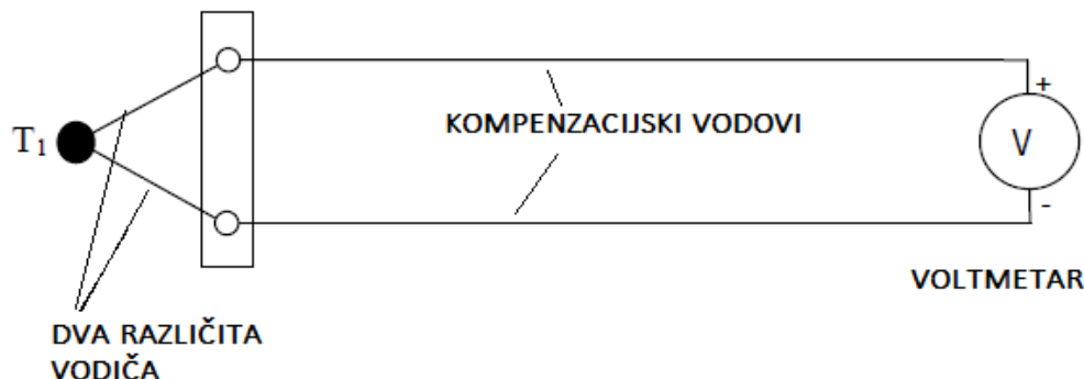
Slika 27. Princip rada termopara [1]
