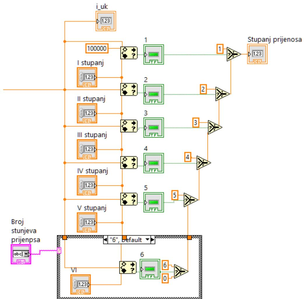
Slika 16. Prikaz sheme za određivanje stupnja prijenosa
