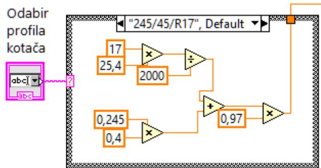
Slika 12. Shema Block Diagrama za računanje dinamičkog radijusa
