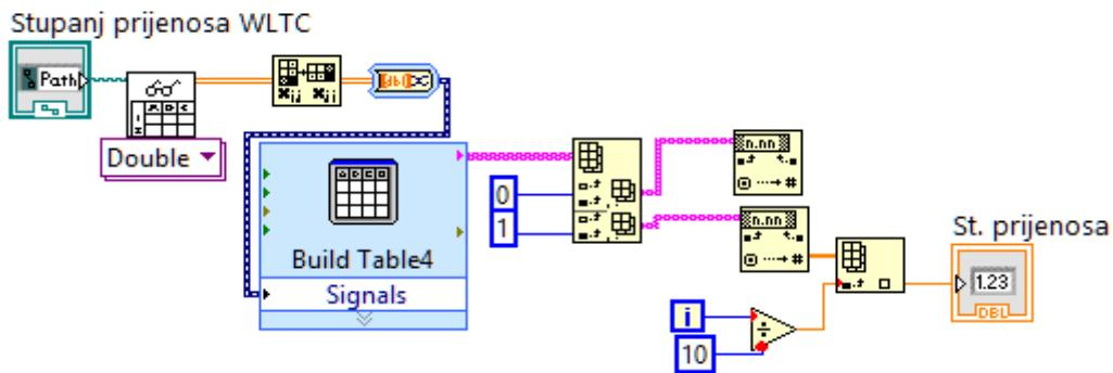
Slika 9. Shema Block Diagrama za učitavanje st. prijenosa
