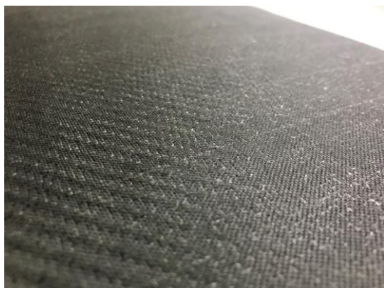
Slika 51. Površina sendvič panela: a) strana koja je bila okrenuta peel-ply tkanini, b) strana koja je bila okrenuta prema stolu, c) detaljniji prikaz slike a) i d) detaljniji prikaz slike b)
