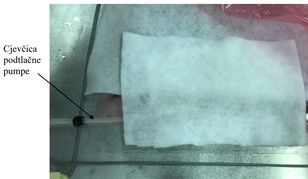
Slika 48. Postavljanje cjevčice podtlačne pumpe
