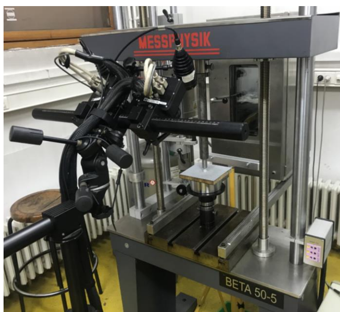
Slika 68. Eksperimentalni postav za ispitivanje uzoraka pri tlačnom opterećenju
