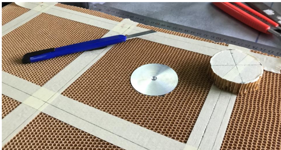
Slika 36. Izrezivanje provrta za umetke
