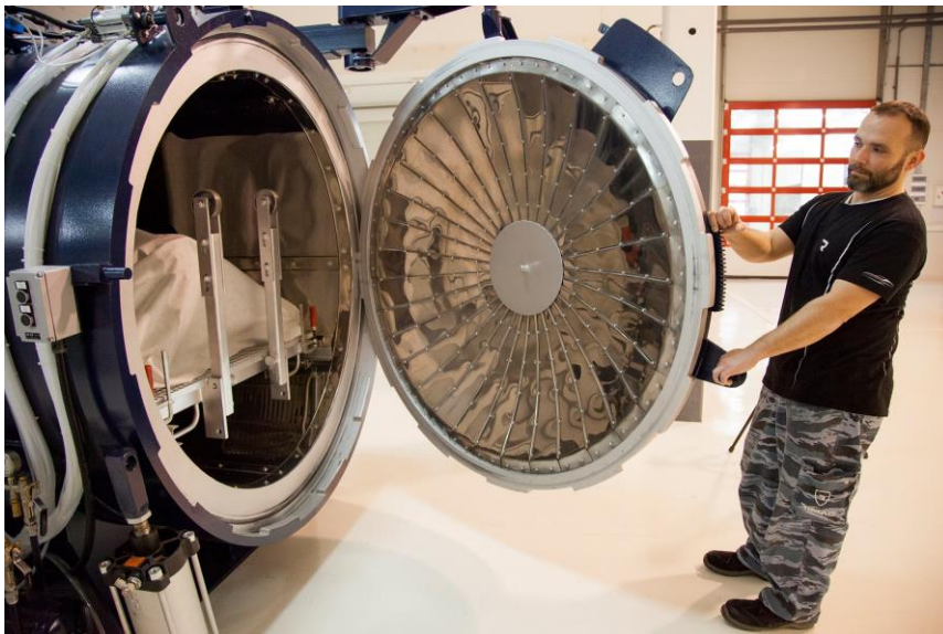
Slika 14. Autoklav tvrtke Rimac Automobili [15]
