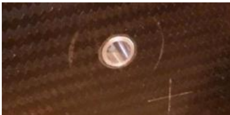
Slika 20. Aluminijski umetak u monocoque šasiji [23]
