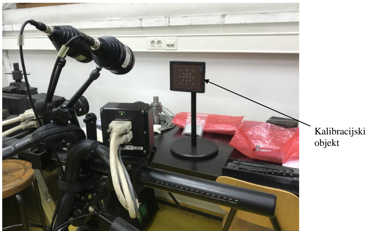
Slika 64. Kalibriranje optičkog sustava Aramis
