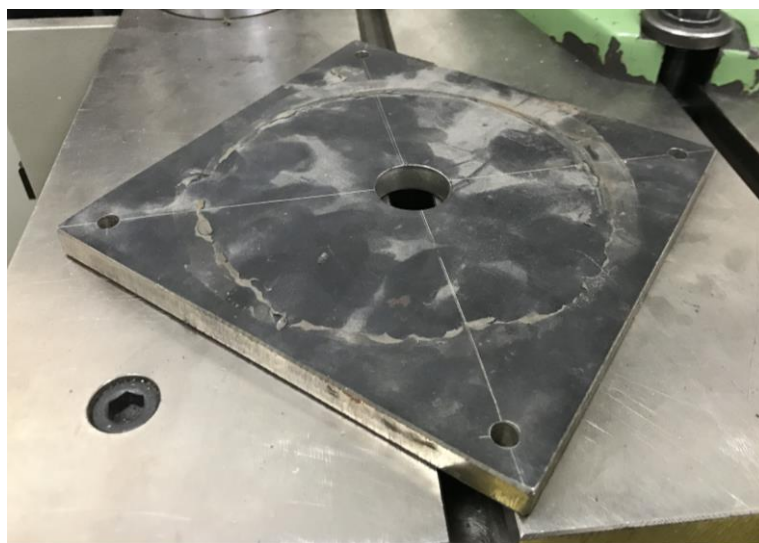
Slika 58. Čelična ploča s provrtom za glavu vijka
