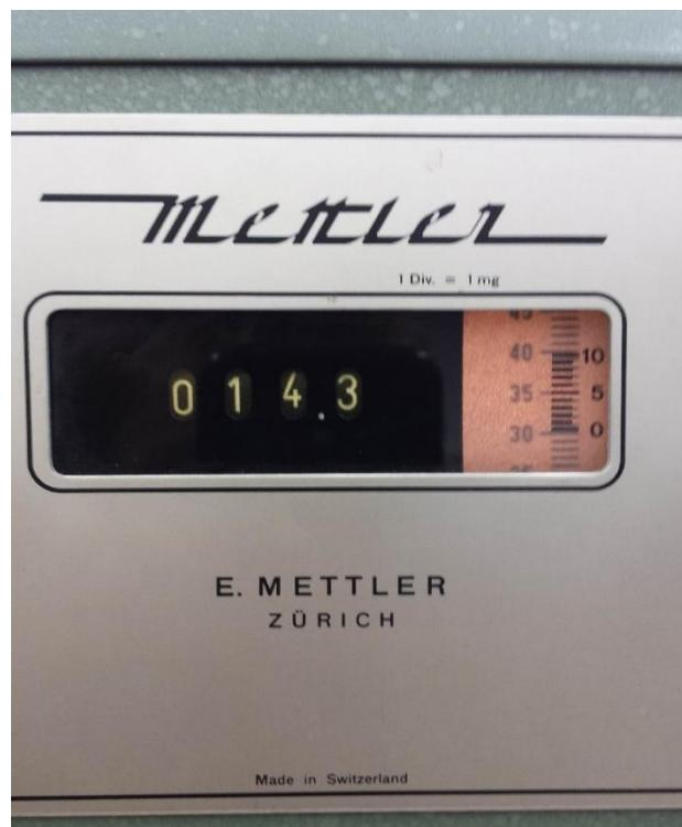
Slika 20. Prikaz očitavanja rezultata s analogne mehaničke vase
