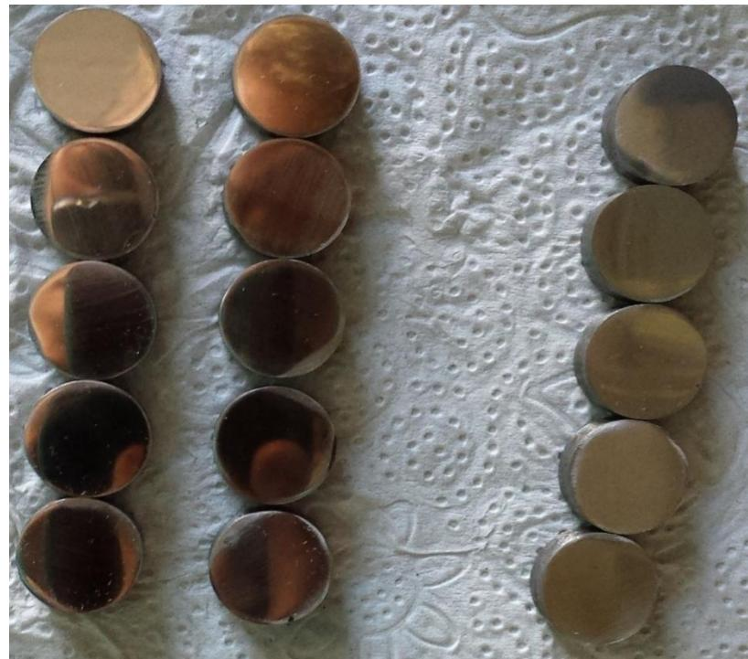
**Slika 13. Fino brušeni ispitni uzorci i grubo brušeni ispitni uzorci**
