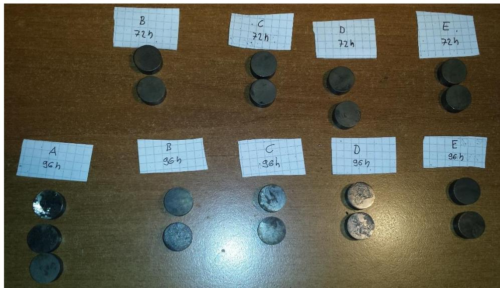
**Slika 19. Ispitni uzorci nakon čišćenja od oksida**
