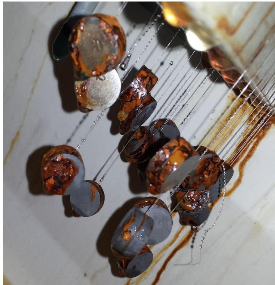
**Slika 17. Ispitivanje korozijske postojanosti u slanoj komori**
