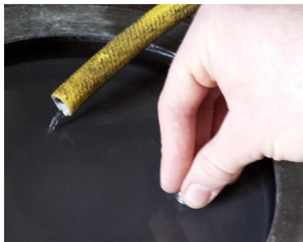
**Slika 12. Prikaz postupka brušenja vodenim brusnim papirom uz ispiranje vodom**
