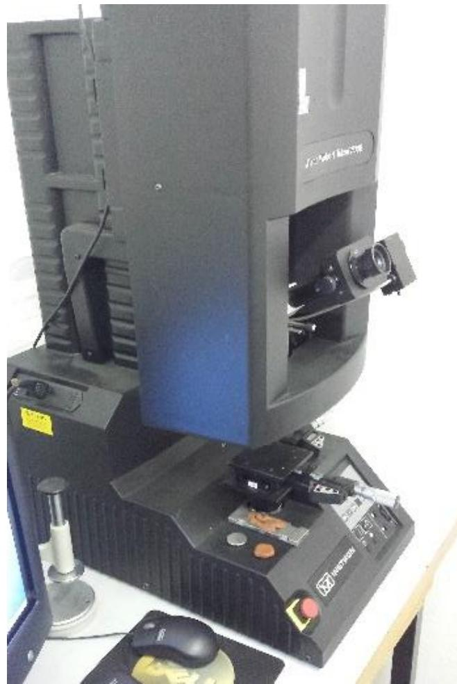
Slika 36. Mikrotvrdomjer Instrum Tukon 2010B
