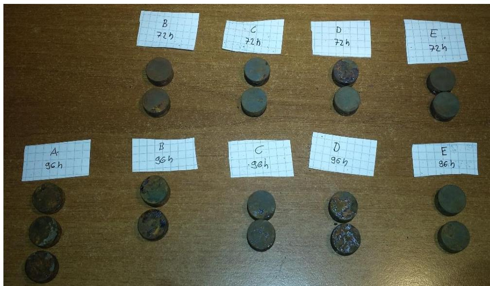
**Slika 18. Ispitni uzorci nakon ispitivanja korozijske postojanosti**
