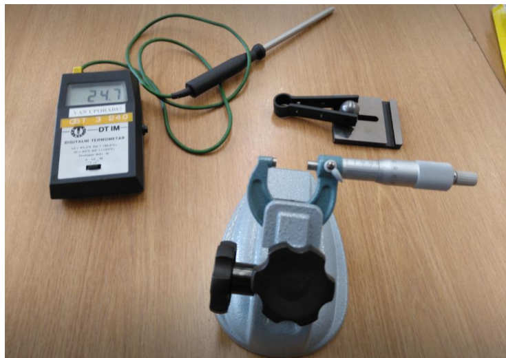
Slika 14 Prikaz mikrometra, predmeta mjerenja i termometra
