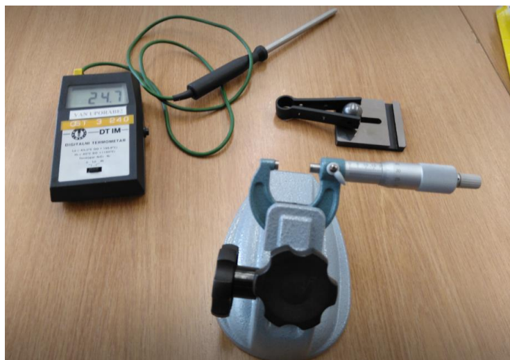
Slika 14 Prikaz mikrometra, predmeta mjerenja i termometra
