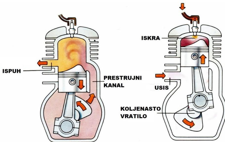
**Slika 3.** Prikaz rada dvotaktnog Otto motora [5]
