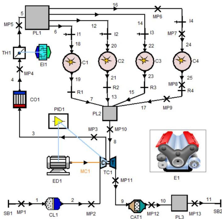
**Slika 42.** Proračunski model s turbopunjачem potpomognutim elektromotorom (AVL Boost)
