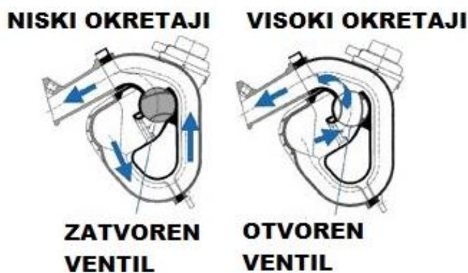
**Slika 8.** Shema usisnog sustava motora Honda K20C [11]
