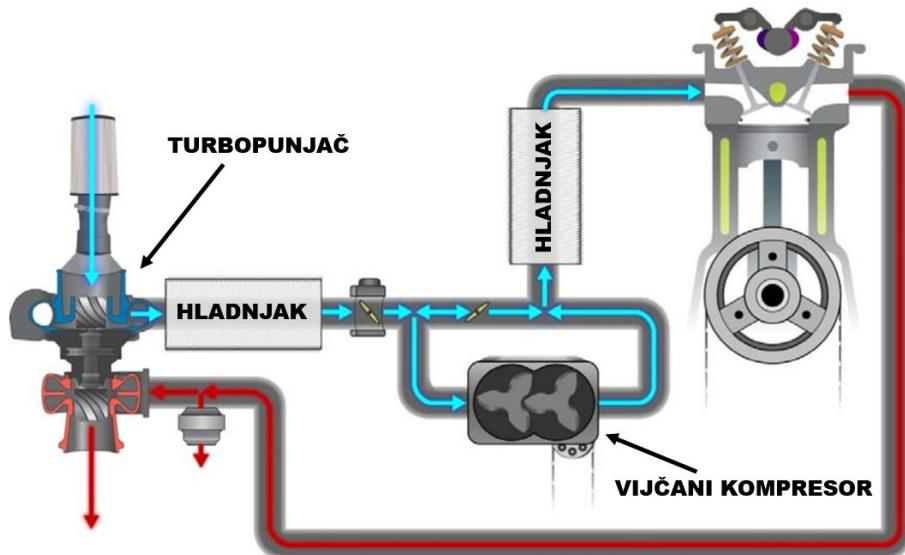
**Slika 37.** Kombinacija turbopunjača i mehanički pogonjenog kompresora [34]
