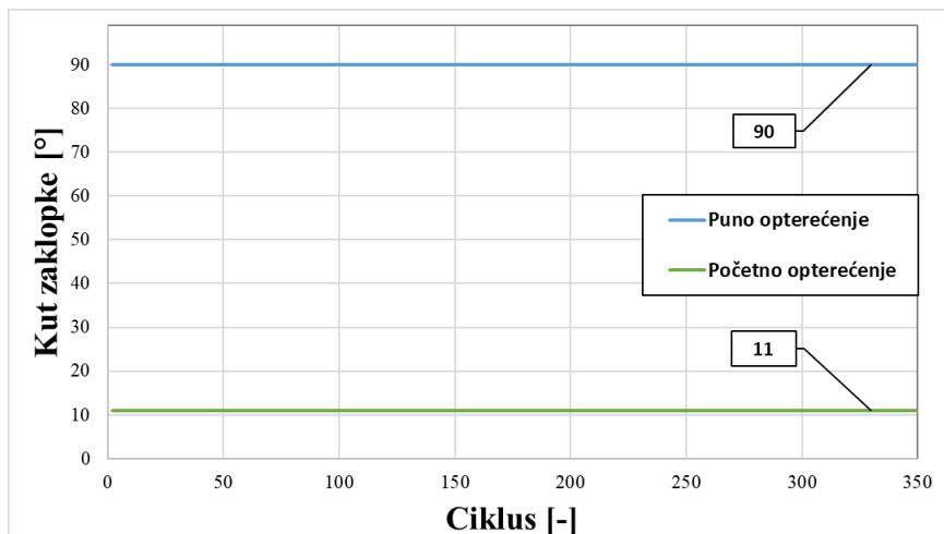
Slika 67. Početni i krajnji kut zaklopke motora s turbopunjačem potpomognutim elektromotorom, pri  $1400 \text{ min}^{-1}$
