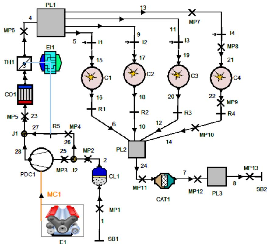
**Slika 50.** Proračunski model s mehaničkim kompresorom (AVL Boost)
