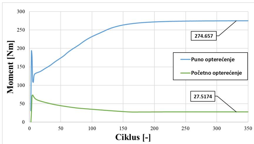
Slika 66. Početni i krajnji moment motora s turbopunjačem, pri  $2400 \text{ min}^{-1}$
