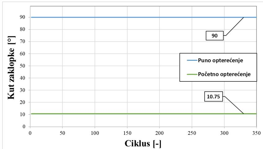
Slika 65. Početni i krajnji kut zaklopke motora s turbopunjačem, pri  $2400 \text{ min}^{-1}$
