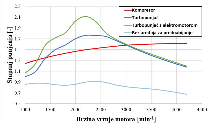
Slika 55. Ovisnost stupnja punjenja o brzini vrtnje motora
