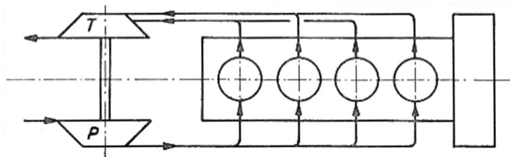
**Slika 29.** Iskorištavanje dinamičke energije ispušnog plina [8]
