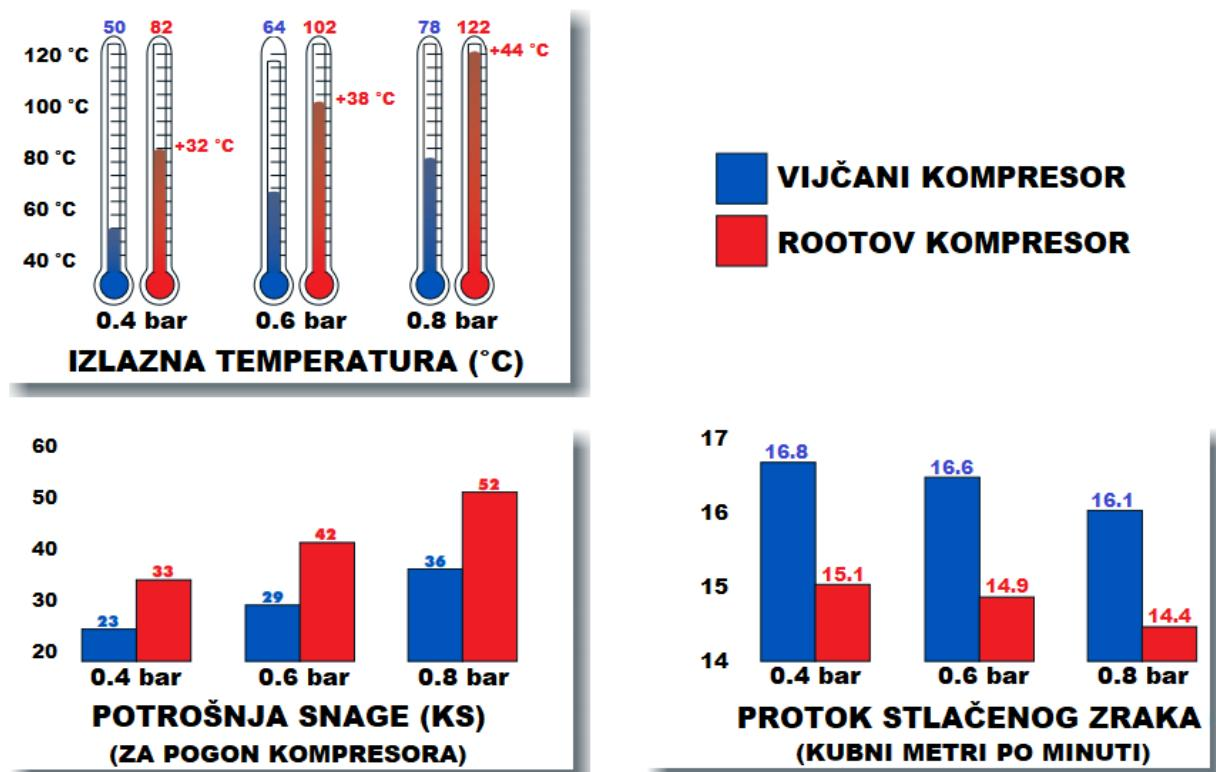
**Slika 22.** Usporedba vijčanog i Rootovog kompresora [20]
