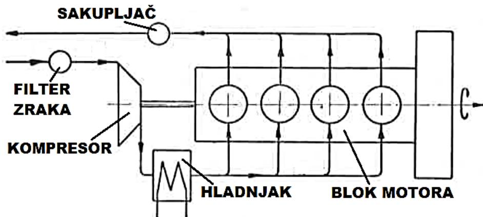
**Slika 11.** Shema motora s mehanički zagonjenim kompresorom [8]
