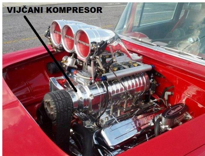
**Slika 21.** Uporaba vijčanog mehanički pogonjenog kompresora na trkačem automobilu [17]
