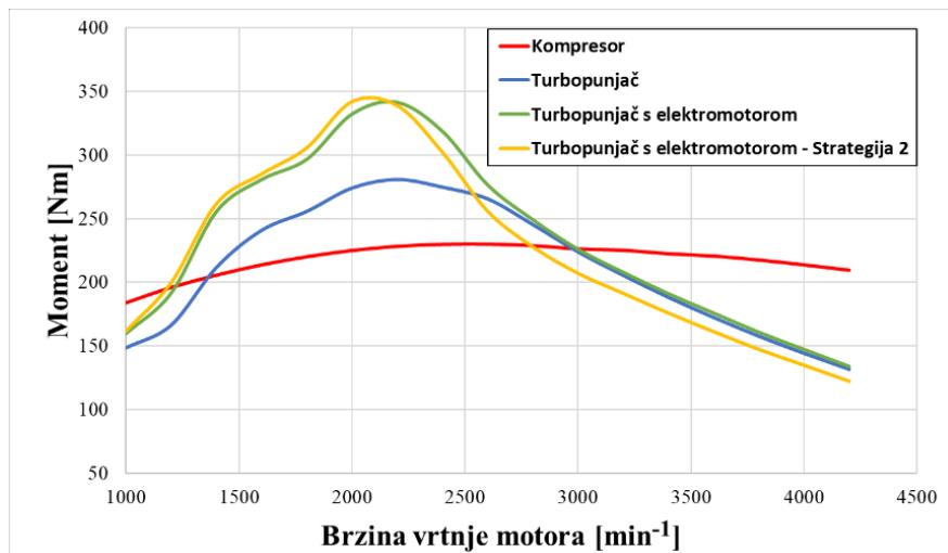
Slika 54. Ovisnost efektivnog momenta o brzini vrtnje motora
