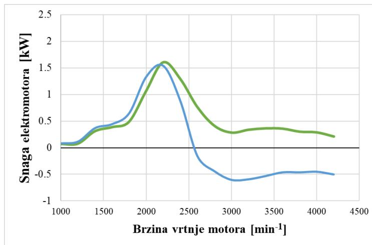
Slika 48. Snaga elektromotora u ovisnosti o brzini vrtnje
