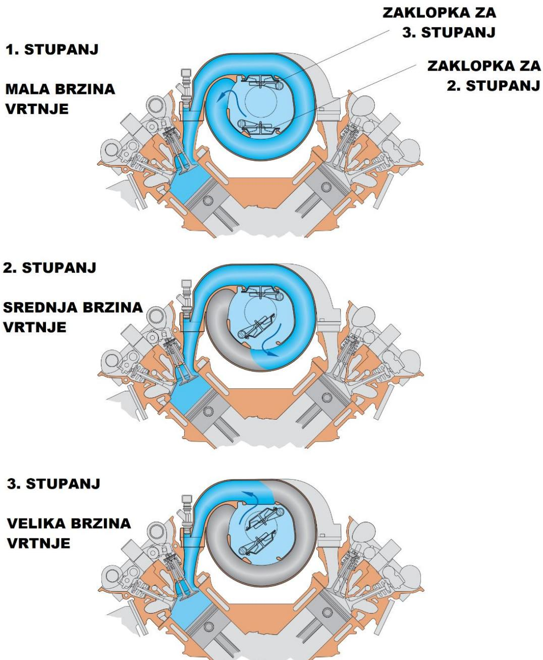
Slika 9. Shema usisnog sustava motora Audi V8 [13]
