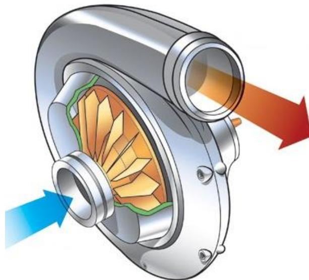
Slika 23. Centrifugalni kompresor [22]
