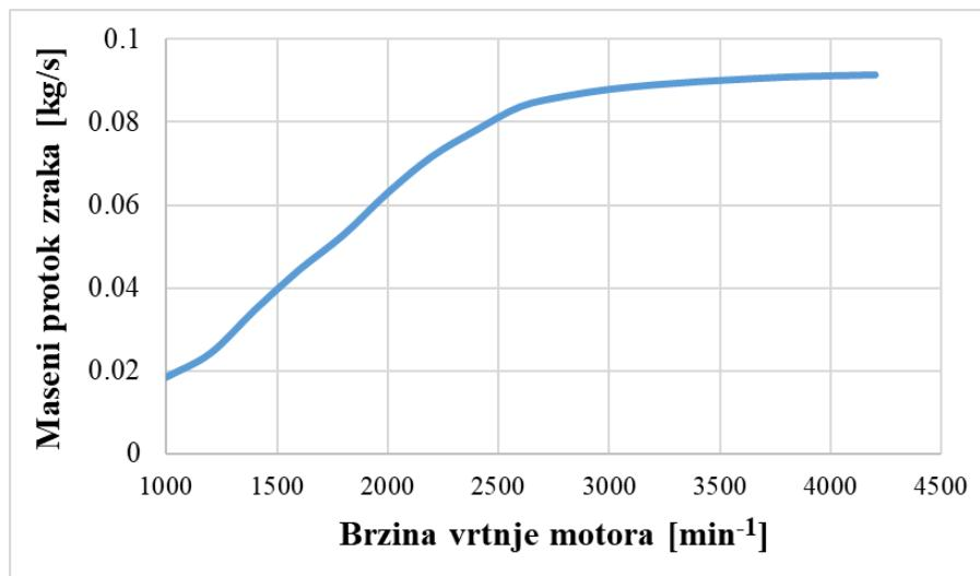
**Slika 45.** Maseni protok kroz kompresor modela s turbopunjačem
