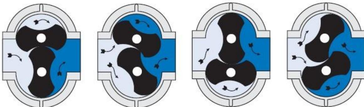
Slika 16. Shematski prikaz rada Rootovog kompresora [16]
