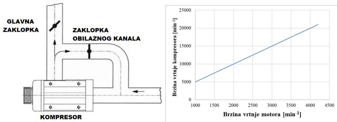
Iako postoje izvedbe s varijabilnim prijenosnim omjerom između kompresora i radilice motora, u ovom je radu on konstantan i iznosi 5:1, kako je prikazano na Slici 52.
