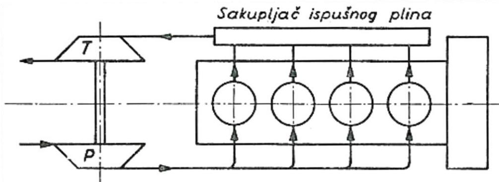
**Slika 28.** Iskorištavanje statičke energije ispušnog plina [8]
