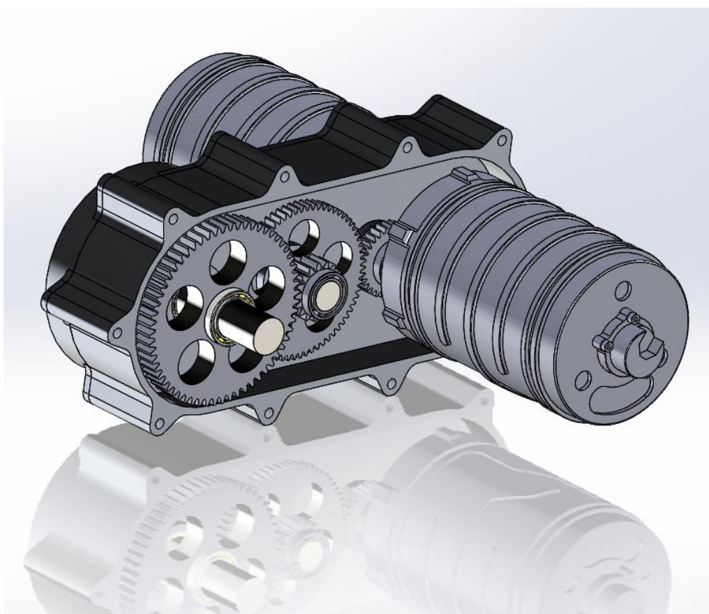
Slika 16. Dvostupanjski reduktor FSBRT06e bolida
