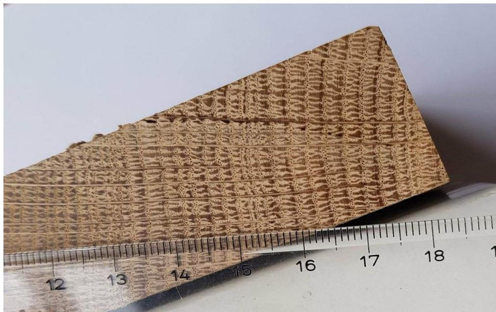
**Slika 21. Makrostruktura poprečnog presjeka recentnog hrasta (uzorak 0)**
