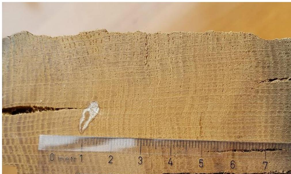
Slika 23. Makrostruktura poprečnog presjeka subfossilnog hrasta (uzorak 2)
