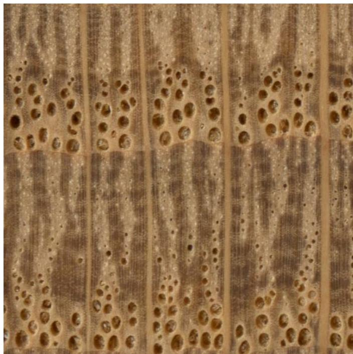
**Slika 24. Mikrostruktura poprečnog presjeka uzorka 0 [19]**
