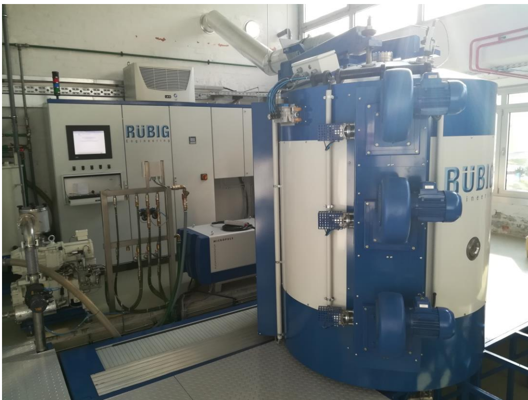
Slika 3. 11. PACVD uređaj Rubig 70/90 instaliran na FSB-u
