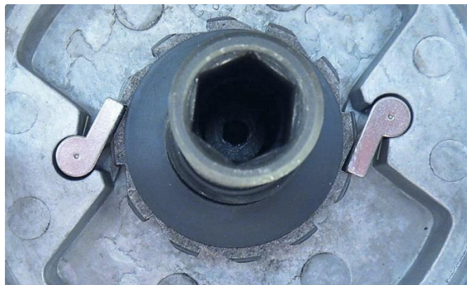
Slika 28. Sustav dvostrukih zadržaća za automatsko kočenje
