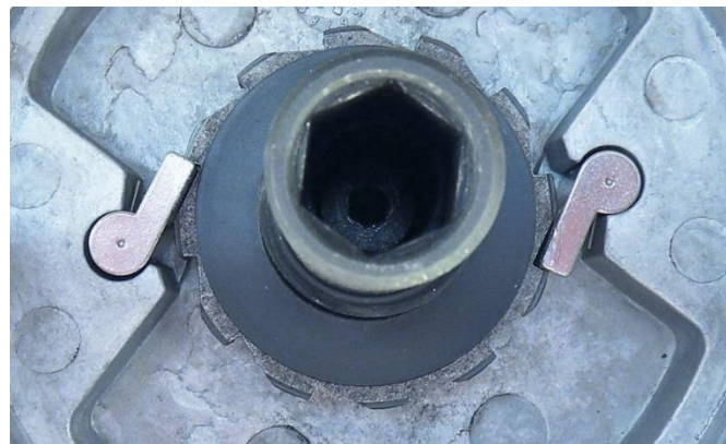
Slika 28. Sustav dvostrukih zadržaća za automatsko kočenje
