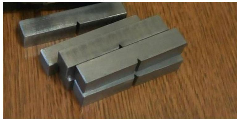
**Slika 17. Epruvete s već napravljenim V-zarezom**
