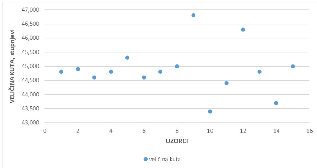
**Slika 34. Rasipanje vrijednosti veličine kuteva čelika M1**
