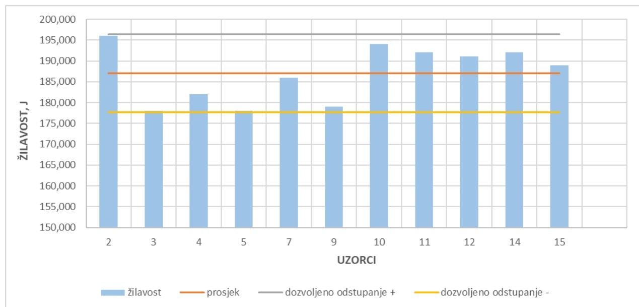
**Slika 42. Dozvoljena odstupanja za epruvete čelika M2**
