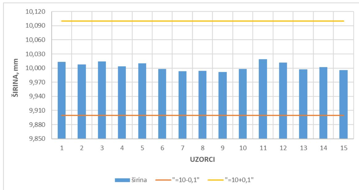
Slika 31. Dijagram rasipanja vrijednosti širina epruveta čelika M2
