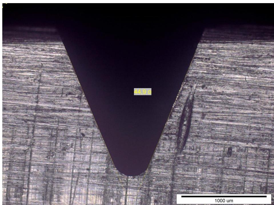
Slika 23. Veličina kuta V-zareza na epruveti čelika M2-2
