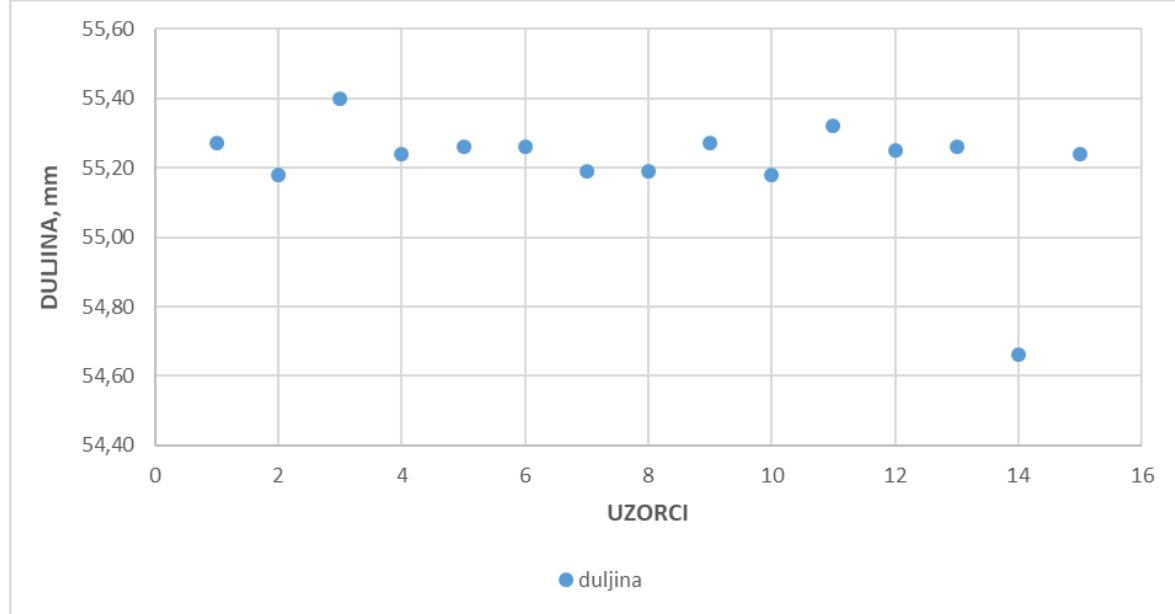
Slika 32. Dijagram rasipanja vrijednosti duljina epruveta čelika M1
