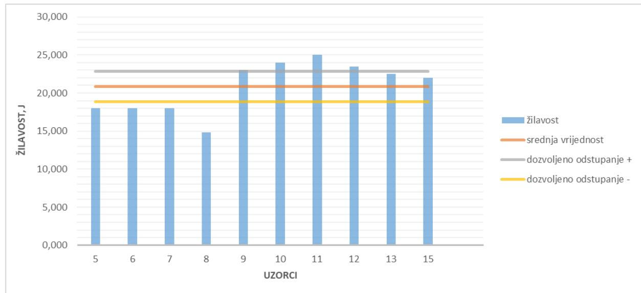
**Slika 41. Dozvoljena odstupanja za epruvete čelika M1**
