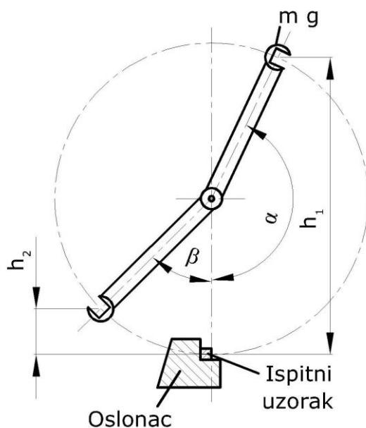
**Slika 5. Ispitivanje udarnog rada loma Charpy-evim batom [5]**
