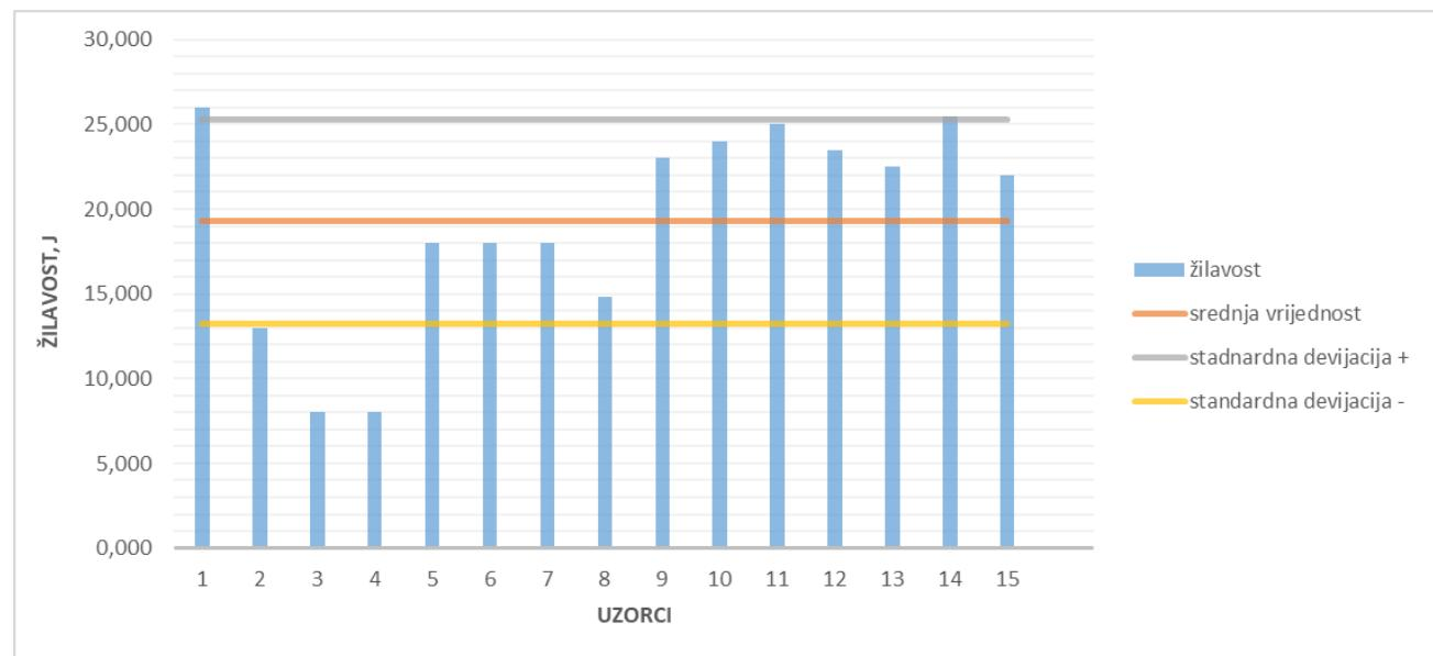
**Slika 36. Vrijednost žilavosti za epruvete čelika M1**
