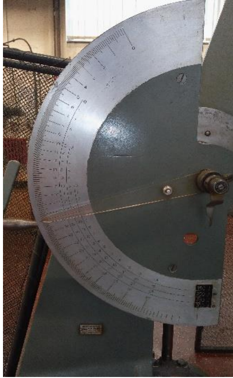
Slika 8. Mjerna skala Charpy bata
