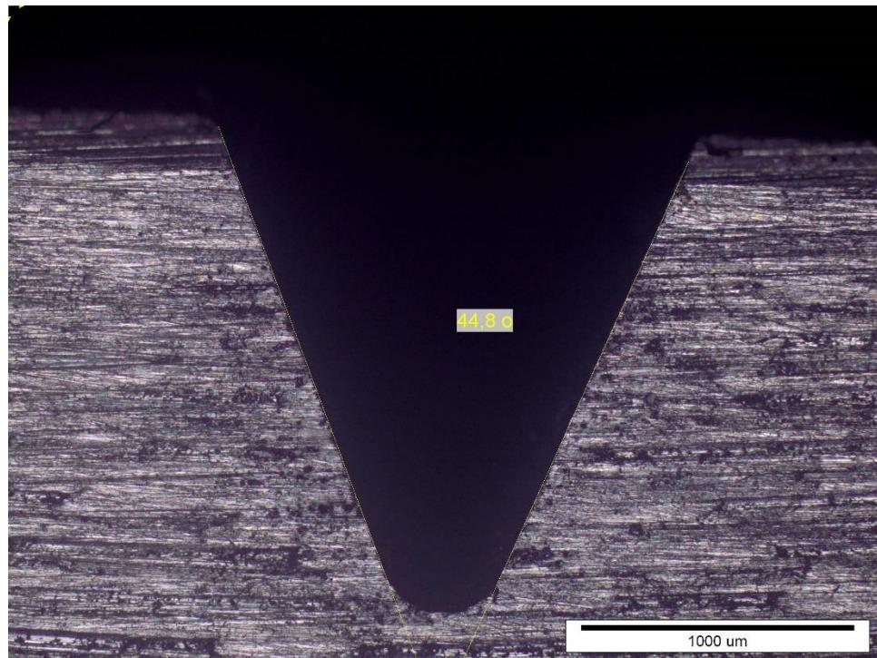
Slika 20. Veličina kuta V-zareza na epruveti čelika M1-7
