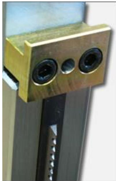
Slika 19. Zubi uređaja za izradu V-zareza
