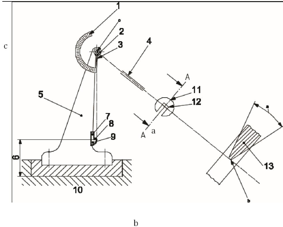
**Slika 7. Dijelovi Charpyevog bata**
