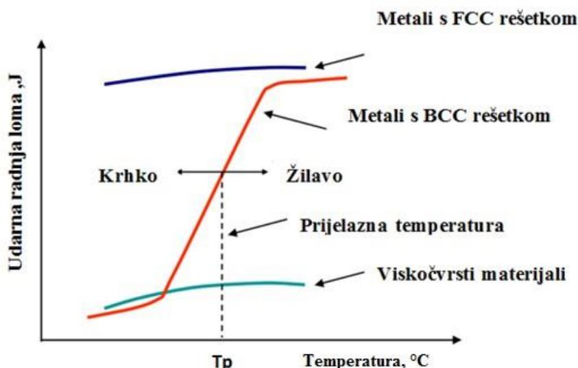
**Slika 11. Ovisnost udarnog rada loma o temperaturi [3]**
