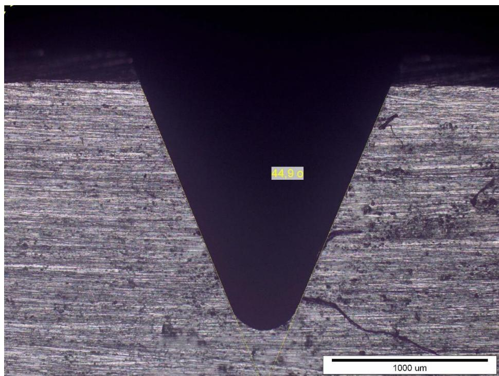
Slika 21. Veličina kuta V-zareza na epruveti čelika M1-11
