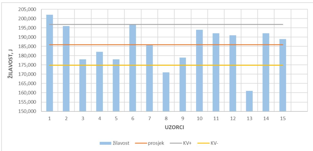
**Slika 37. Vrijednosti žilavosti za epruvete čelika M2**
