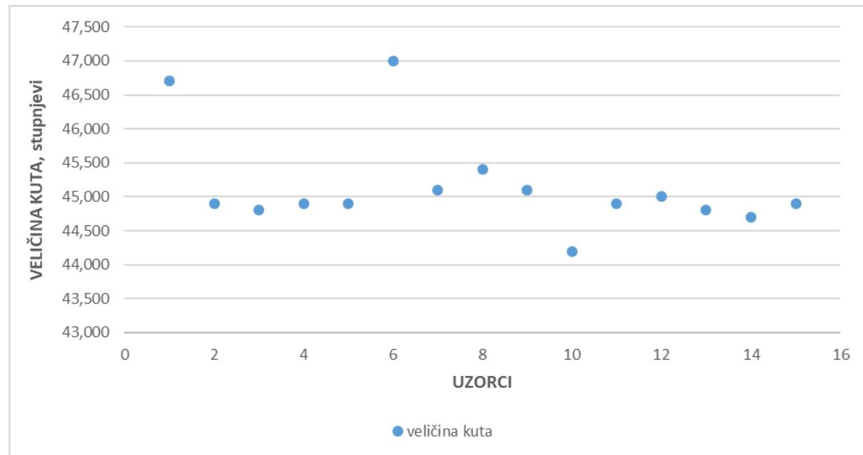
**Slika 35. Rasipanje vrijednosti veličine kuteva čelika M2**
