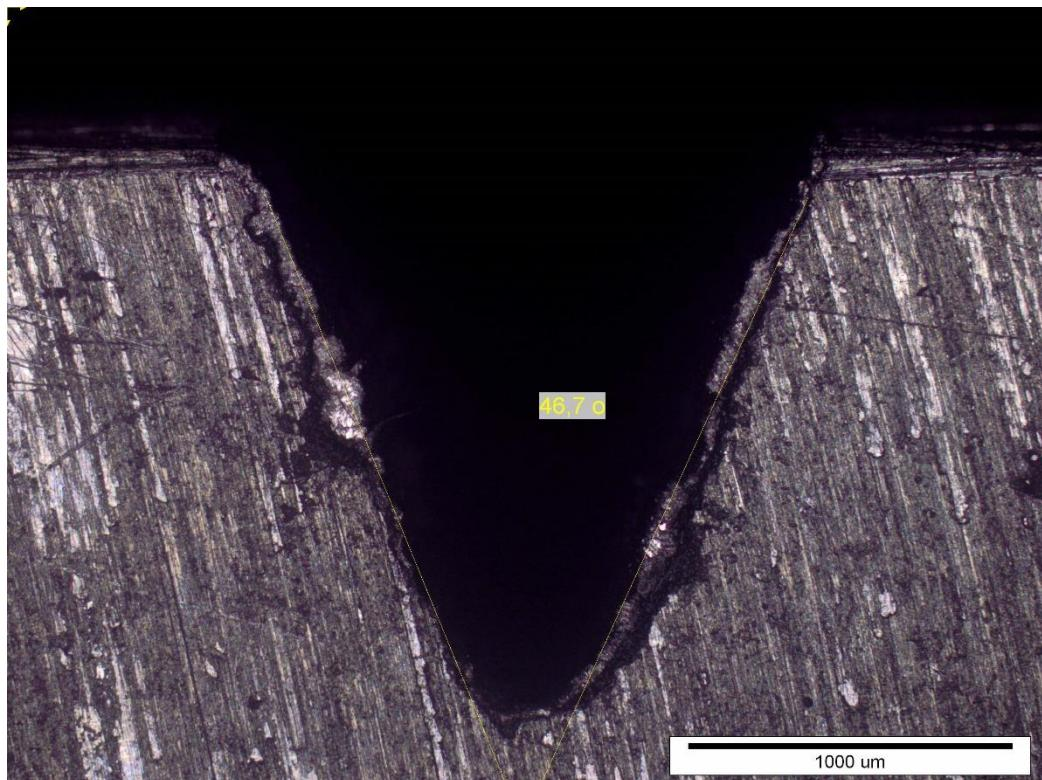
Slika 22. Veličina kuta V-zareza na epruveti čelika M2-1
