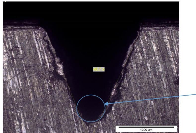
Slika 39. Određivanje radijusa na epruveti M2-1
