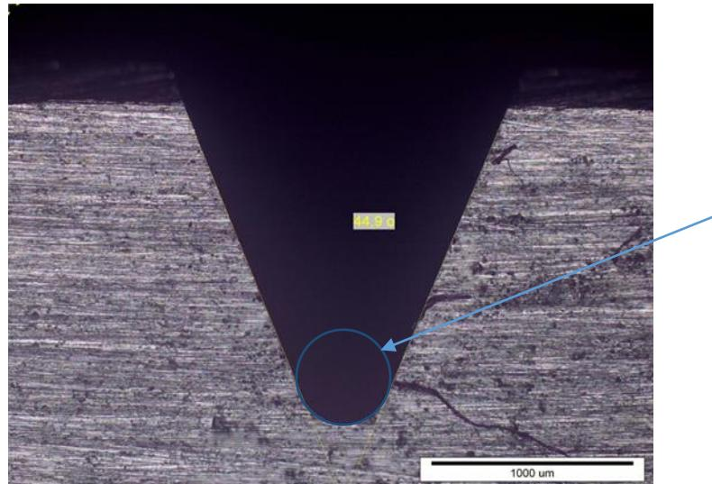
Slika 38. Određivanja radijusa V-zareza na epruveti M1-11
