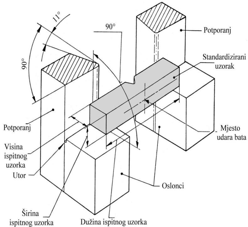
**Slika 4. Shematski prikaz epruvete na osloncima [4]**
