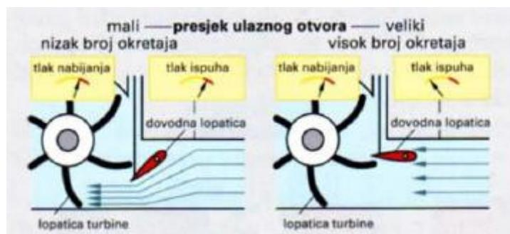
Slika 9. Princip rada turbopunjača s VNT [3]
