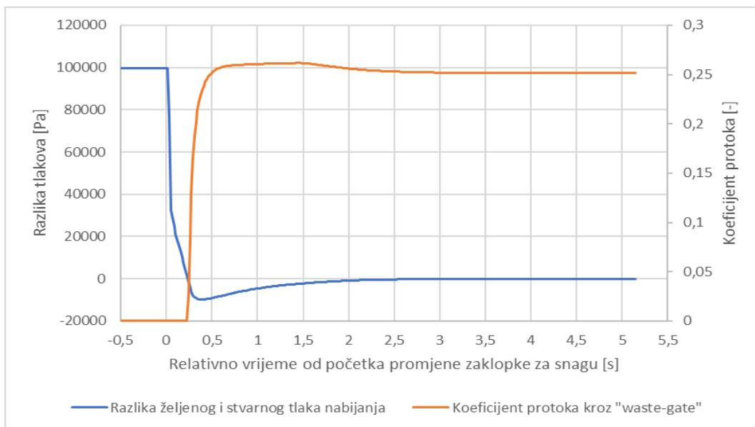
Slika 16. Regulacija koeficijenta protoka pomoću PID regulatora
