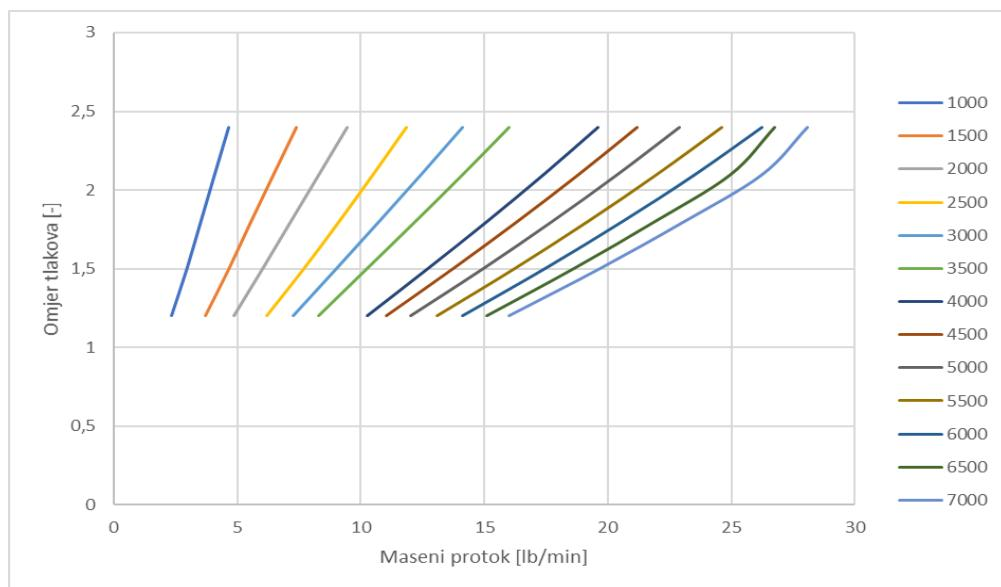
**Slika 14. Ovisnost omjera tlakova i masenog protoka**
