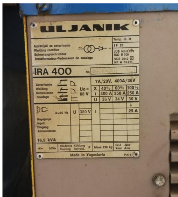
Slika 35. Karakteristike aparata za zavarivanje
