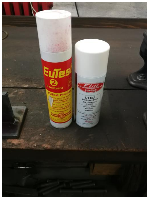
Slika 50. Penetrant (lijevo) i razvijaj (desno) korišteni u eksperimentu
