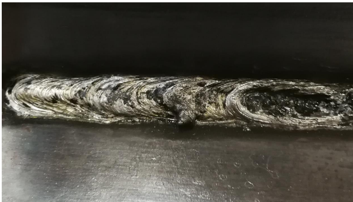
Slika 43. Zavar izveden s elektrodom R29/9
