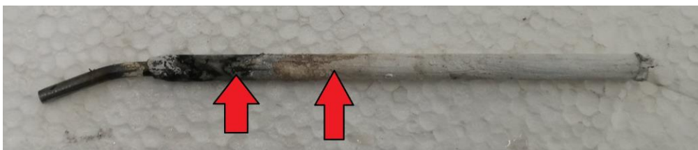
Slika 47. Vanjski sloj elektrode R 19/9 nakon zavarivanja (ljuštenje i izgoreni dijelovi)
