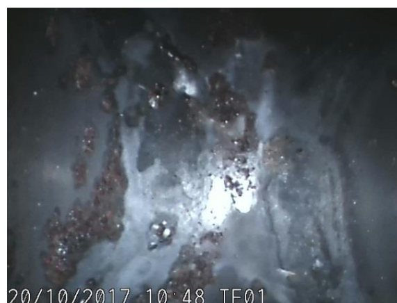
Slika 46. Segment šasije PODNICA: stanje unutrašnje površine cijevu, osnovni materijal
