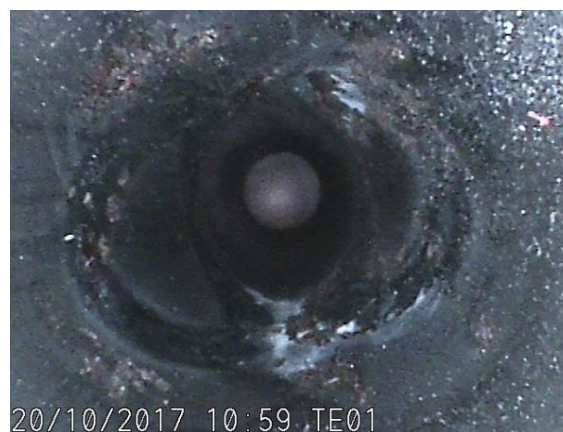
Slika 47. Segment šasije PODNICA: stanje unutrašnje površine cijevi, mjesto zavora
