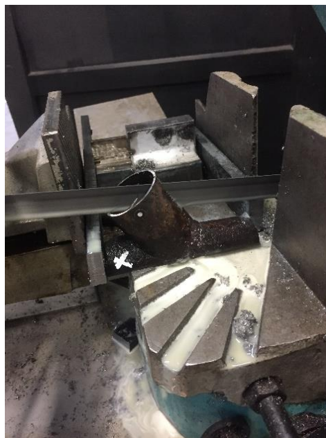
Slika 3. Izrezivanje uzorka tračnom pilom
