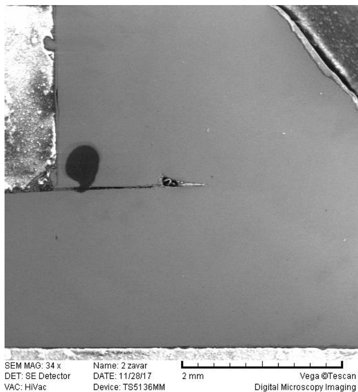
Slika 70. Segment šasijske PODNICA uzorak 5: zavar, SEM, neprotaljenost
