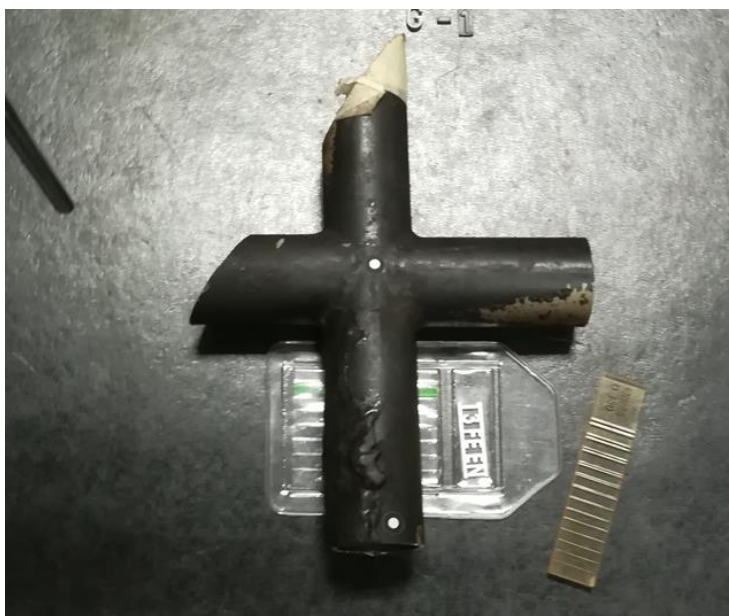
Slika 49. Segment šasije PODNICA pripremljen za radiografsku analizu
