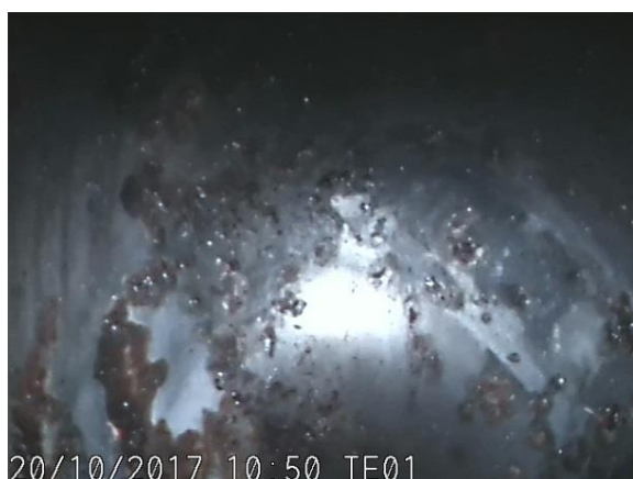
Slika 46. Segment šasije PODNICA: stanje unutrašnje površine cijevu, osnovni materijal
