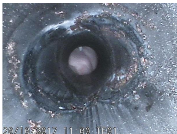
Slika 47. Segment šasije PODNICA: stanje unutrašnje površine cijevi, mjesto zavora
