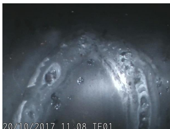
Slika 47. Segment šasije PODNICA: stanje unutrašnje površine cijevi, mjesto zavora
