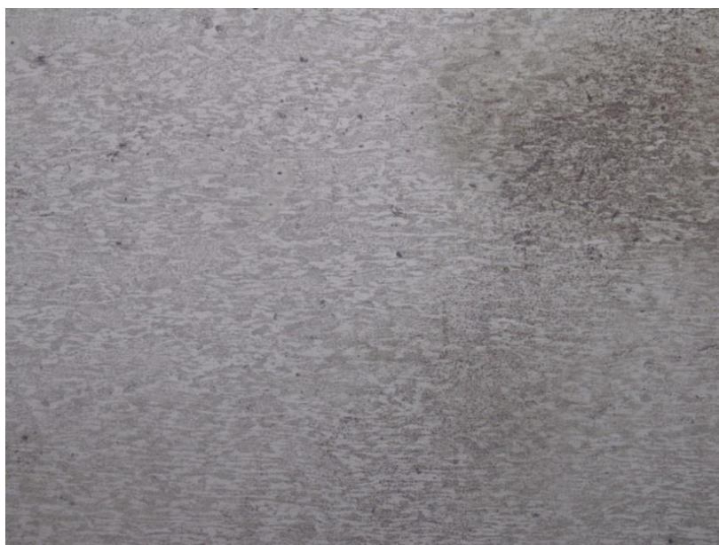
Slika 59. Segment šasijske PODNICA uzorak 4: mikrostruktura osnovnog materijala na poziciji OM2
