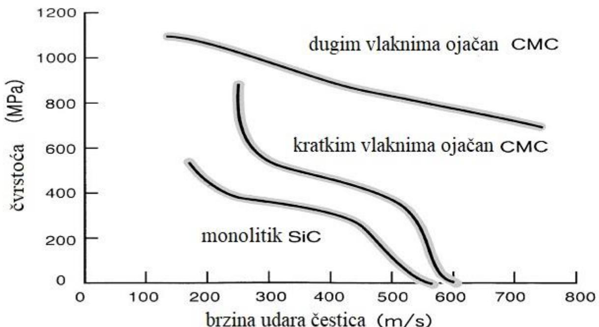
Slika 3.8 Čvrstoća u ovisnosti o brzini udara čestica [13]
