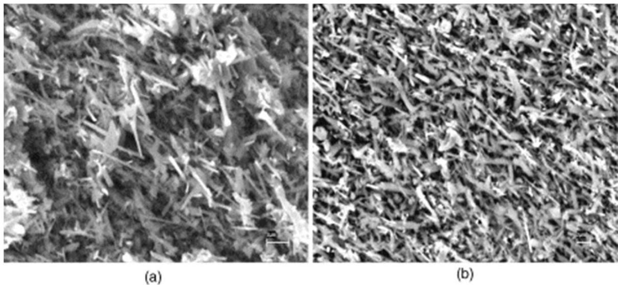
**Slika 2.19 Mikrostruktura kompozita sa  $\text{SiN}_4$  matricom ojačanom  $\text{SiC}$  viskerima [7]**
