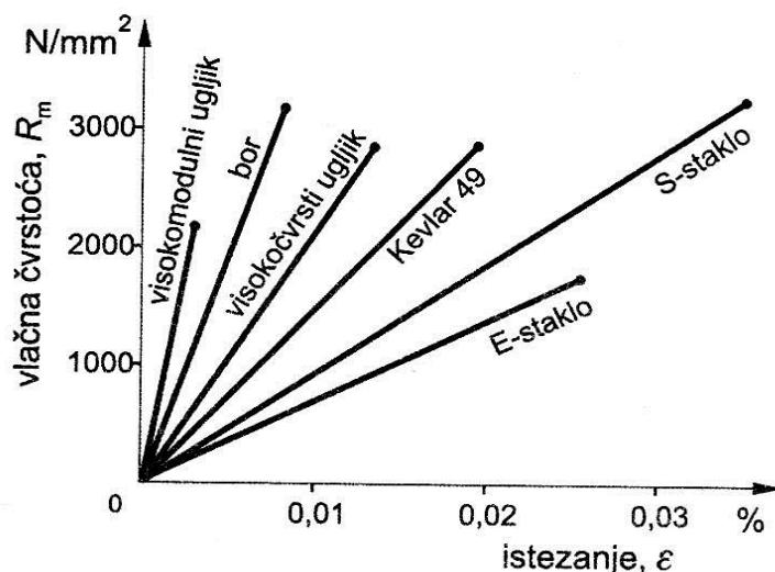
Slika 2.10 Dijagram naprezanje-istezanje pojedinih vrsta vlakana [3]
