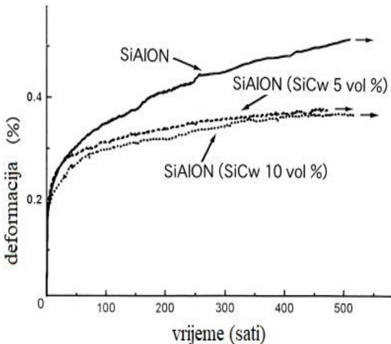
Slika 3.9 Dijagram puzanja monolitne keramike i keramičkog kompozita [13]
