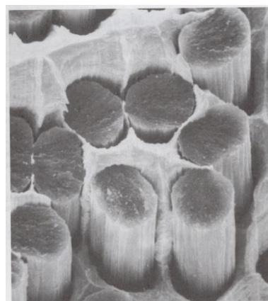
**Slika 2.6 Legura Ag-Cu ojačana ugljičnim vlaknima [3]**
