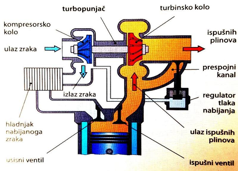
**Slika 3.4 Shematski prikaz motora s turbopunjačem [8]**
