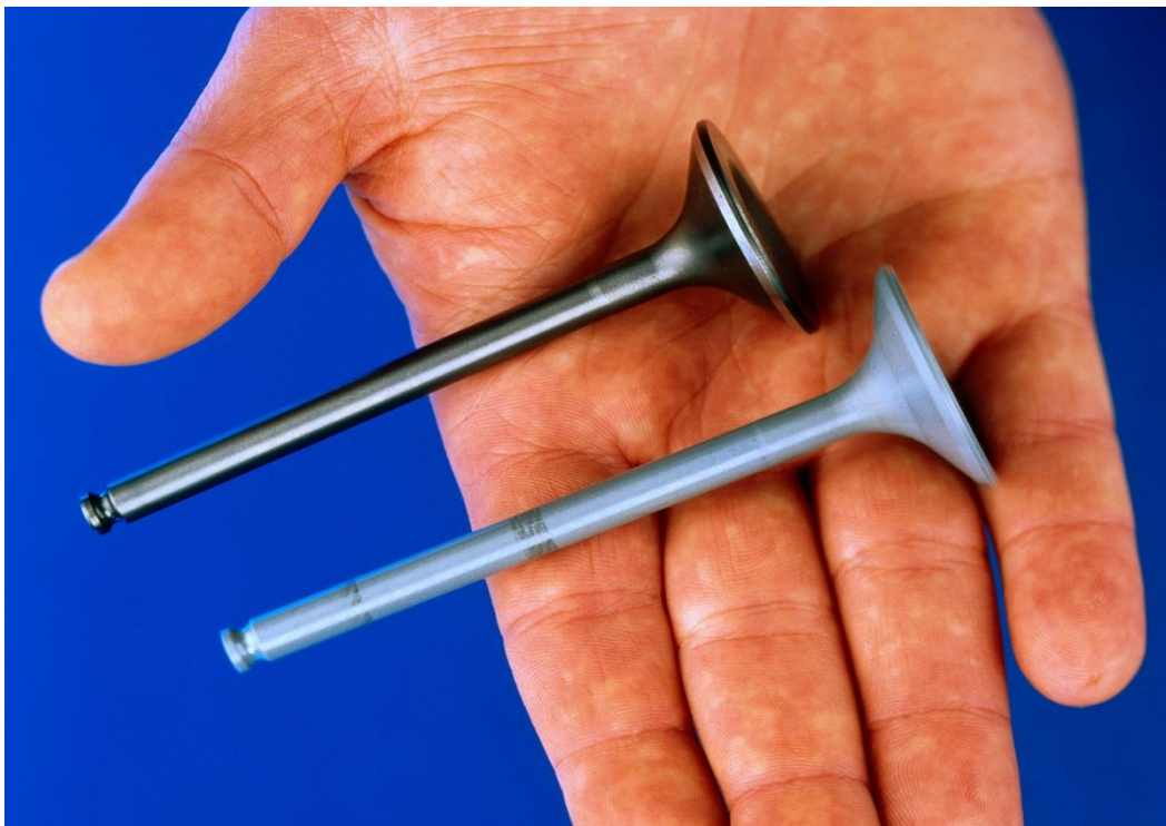
Slika 3.1 Ventili u automobilskom motoru[5]
