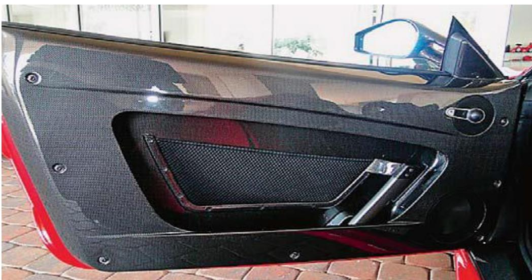
Slika 2.11 Paneli vrata plastomerne matrice ojačane ugljikovim vlknima[1]
