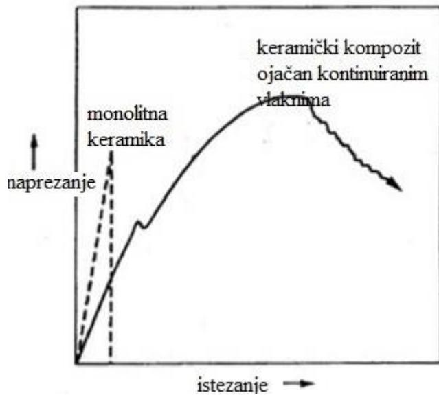
Slika 3.10 Dijagram naprezanje-istezanje monolitika keramike i CMC-a. [7]
