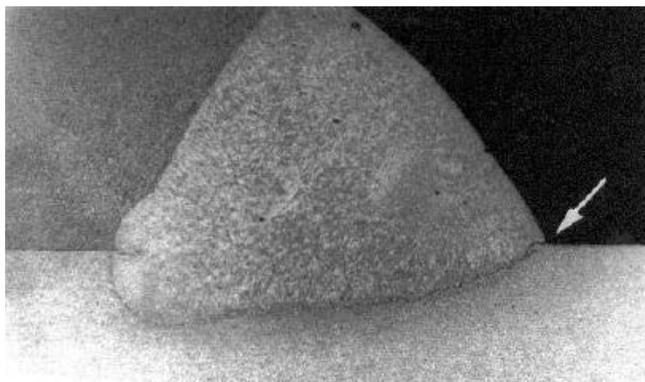
Slika 5. Oksidni sloj "zarobljen" unutar zavara [13]
