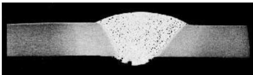
Slika 10. Poroznost u sučeljenom spoju aluminija debljine 6 mm
