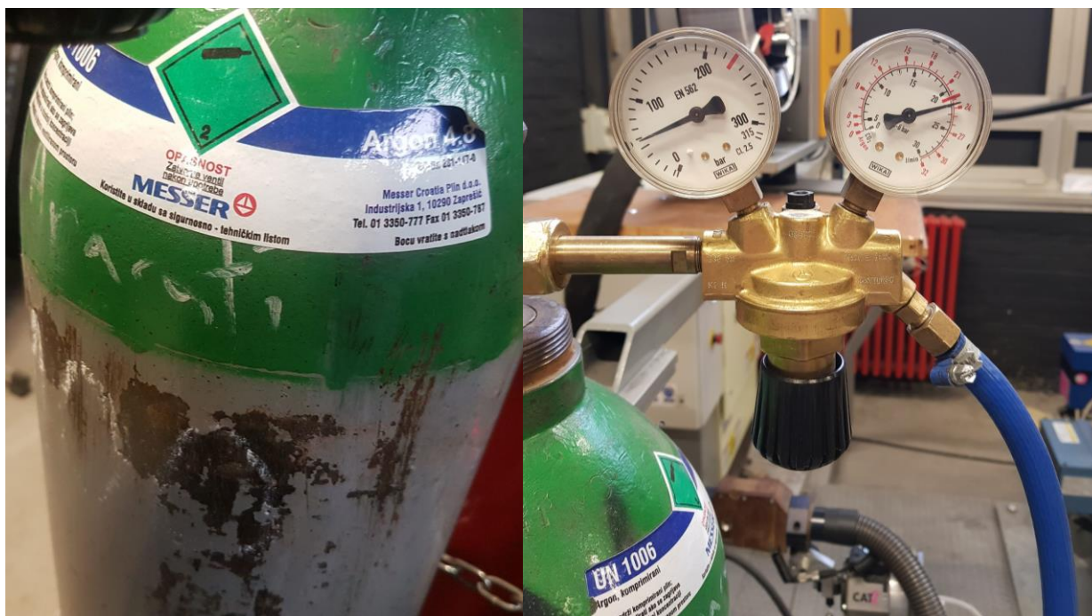
Slika 28. Zaštitni plin – Argon 4.8 i protok zaštitnog plina
