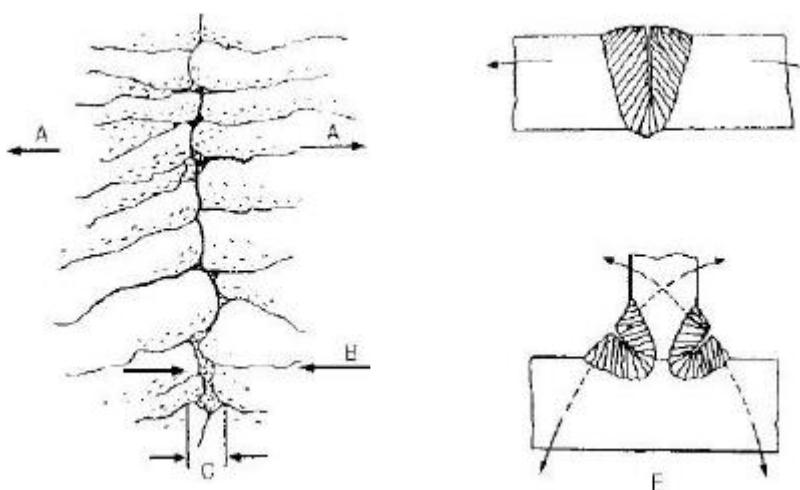
**Slika 12. Shematski prikaz mehanizma nastajanja toplih pukotina [22]**
