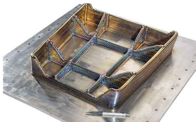
**Slika 23. Prednost WAAM postupka - proizvodnja komponenti sa složenom geometrijom [35]**
