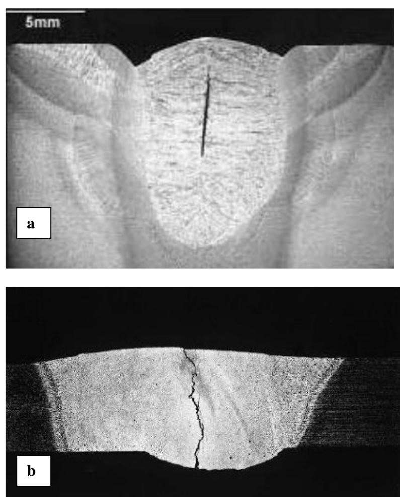
**Slika 11. Tople pukotine u sučeljenom spoju 3 mm debelih ploča aluminijeve legure A6082 s dodatnim materijalom 4043, TIG postupak: a) Unutarnja topla pukotina (nije otvorena prema površini) b) Pukotina kroz cijelu površinu zavara [13]**
