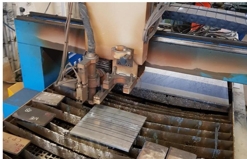
Slika 37. Odvajanje izrađenih zidova od osnovne ploče plazma rezačicom
