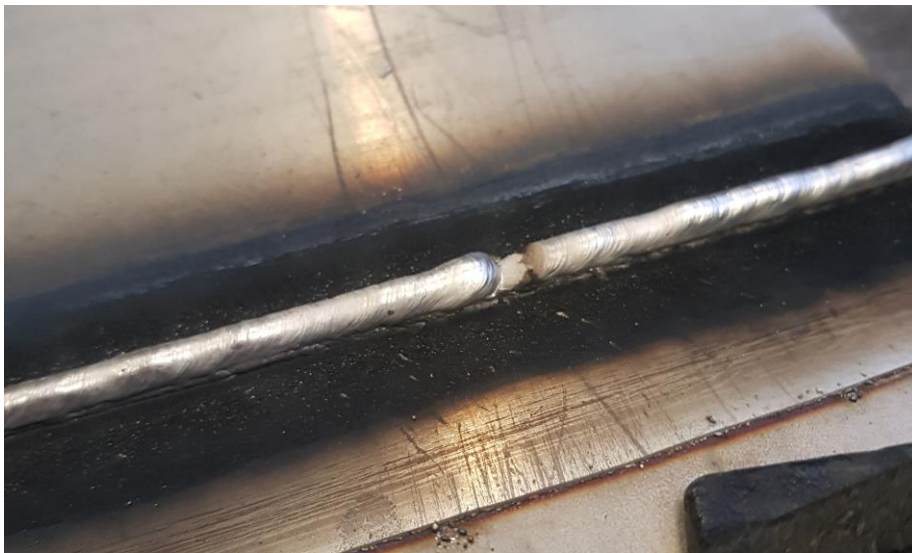
Slika 29. Nepravilnost zavora nastala uslijed nepravilnog dovoda žice
