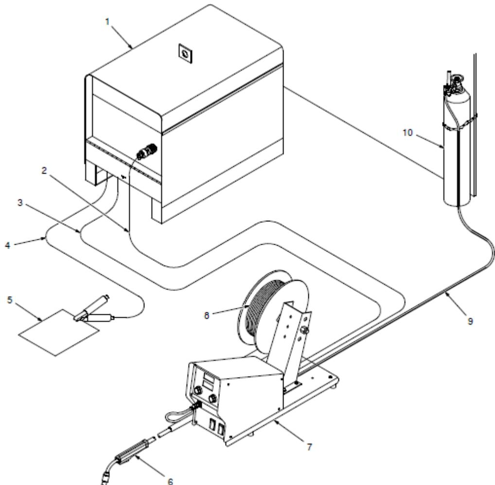
**Slika 15. Shema uređaja za zavarivanje MIG/MAG [27]**
