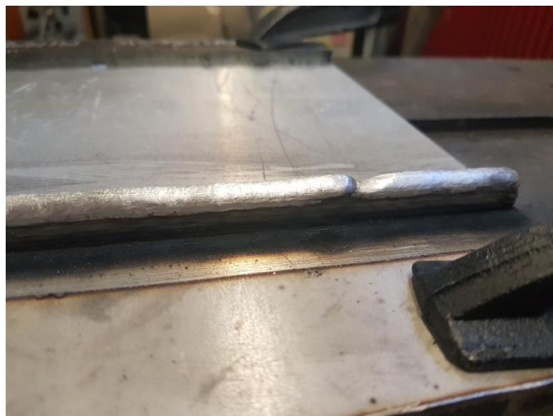
Slika 30. Nepravilnost zavara pri izradi zida 1
