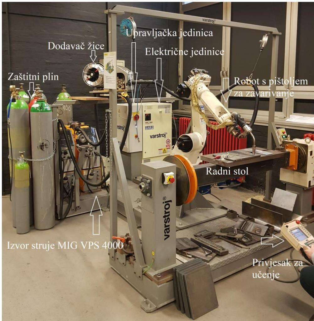
Slika 25 . Robotska stаница Almega OTC AX V6
