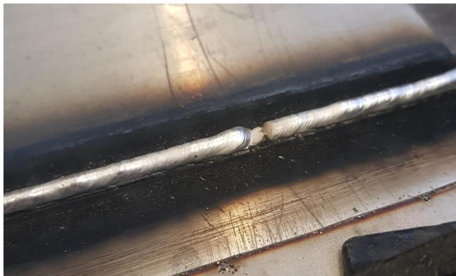
Slika 29. Nepravilnost zavara nastala uslijed nepravilnog dovoda žice
