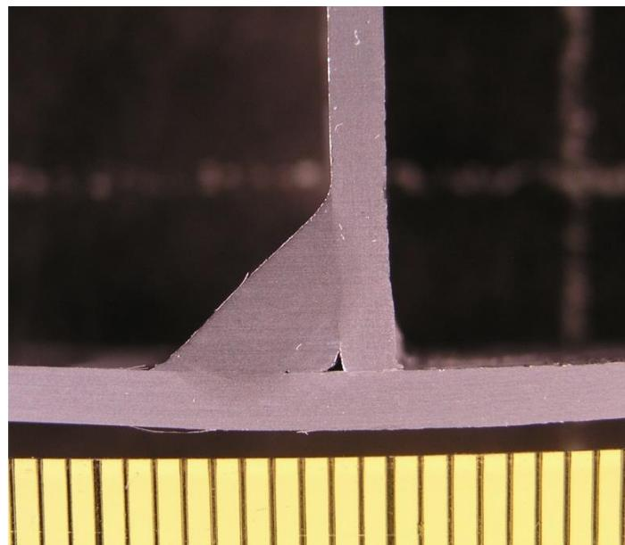
**Slika 8. Primjer naljepljivanja aluminijeve legure [20]**
