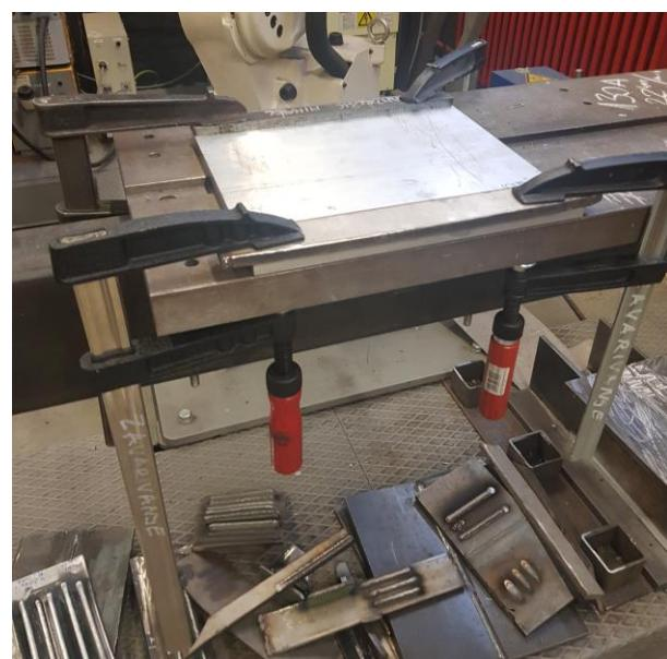
Slika 27. Pozicioniranje i stezanje osnovne ploče
