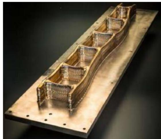
Konstrukcija krila zrakoplova od Ti6Al4V
