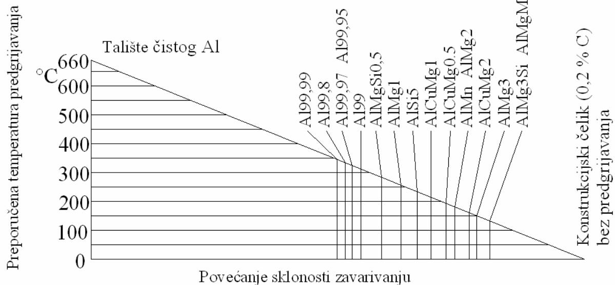
Slika 9. Temperature predgrijavanja aluminijevih legura [21]
